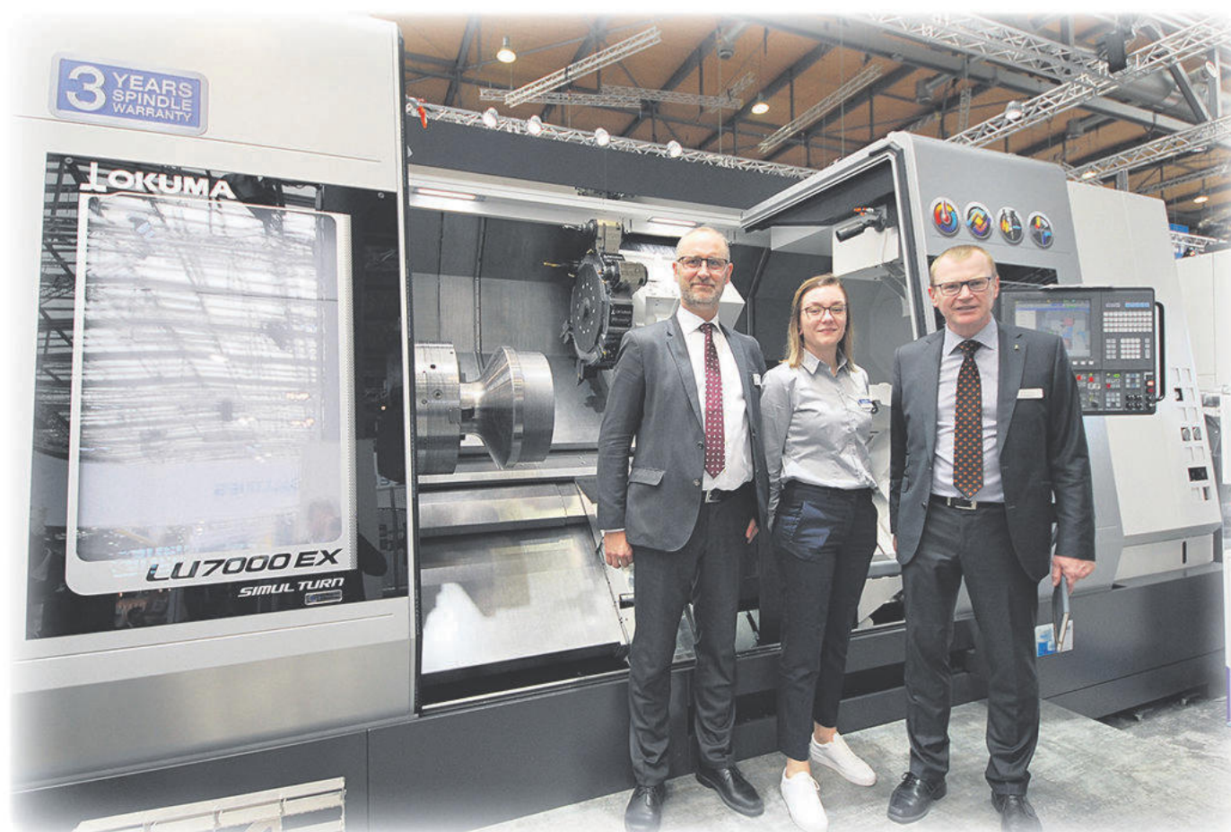
Nya svarven Okuma LU 700 EX, stor enkelspindlig, dubbdocka, två revolverar för tyngre bearbetning. På bilden ser vi också Gunnar Strömmer, Emma Johannesen och Jimmy Jensen.
