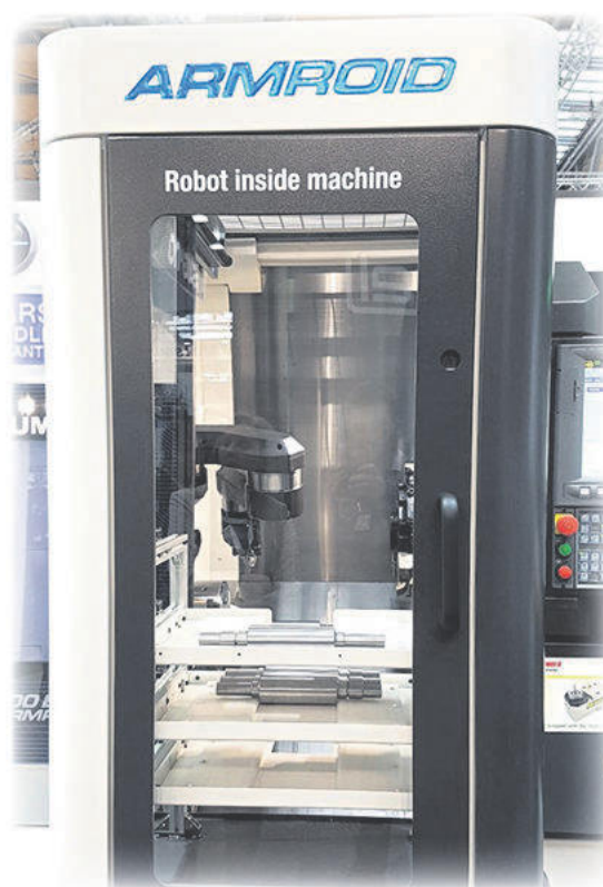
ARMROID är en ledad robotarm direkt integrerad i bearbetningsområdet, vilket möjliggör automatisering och stöd i bearbetningsprocessen. © Okuma
