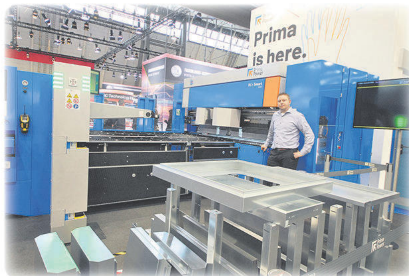
Prima Power BCe Smart som är en servoelektrisk bockautomat med manuell in och utmatning av ämne och detalj.
