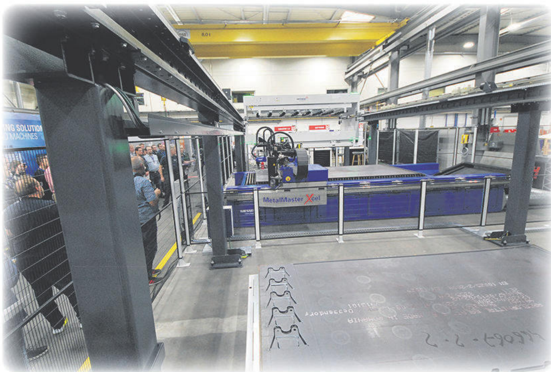
Remmert Automation System med PlasmaFLEX plätlagersystem som är utrustat med två automationsenheter, en lastenhet och en lossningsenhet. Efter skärningen lyfter en gaffelenhet den bearbetade plåten från skärbordet på lasermaskinen, samtidigt hämtar vakuumenheten en ny plåt från lagringen. Så snart lossaren har återlämnat plåten till lager eller lagt den klar längs maskinen, matar lastaren en ny plåt till lasermaskinen. Optimerat system för lagring och hämtningsmaskin, snabbt byte av material på rörelsestationerna.
