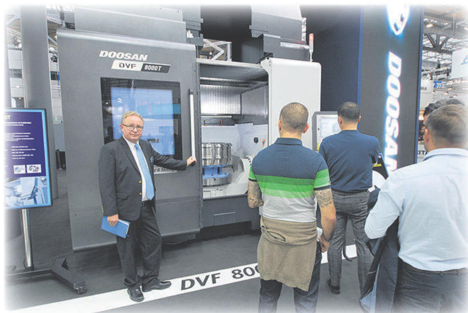
Doosan DVF8000T med styrsystem Heidenhain iTNC640. Den största modellen i den nya 5-axliga DVF serien. Maskinen som visas här är även utrustad med svarvfunktion.
