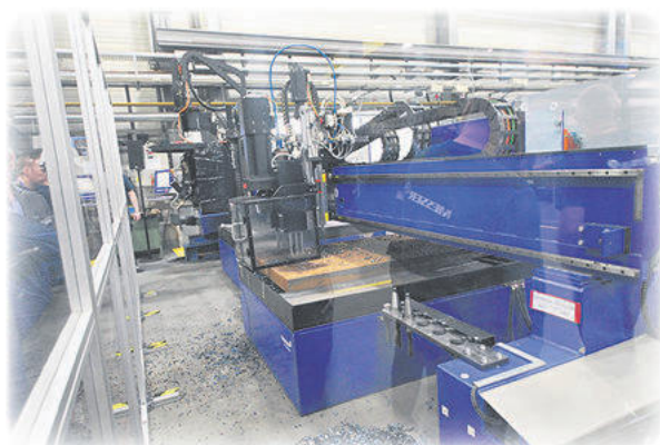
Detaljerna slår sig inte lika mycket om man skär i vattenbord. Tuff skärning med precision Borring i 100 mm stål S690, maskin OmniMat med verktygsväxlare.
