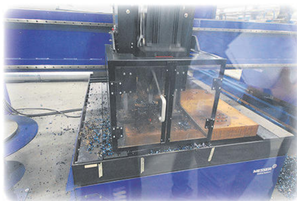
Detaljerna slår sig inte lika mycket om man skär i vattenbord. Tuff skärning med precision Borring i 100 mm stål S690, maskin OmniMat med verktygsväxlare.
