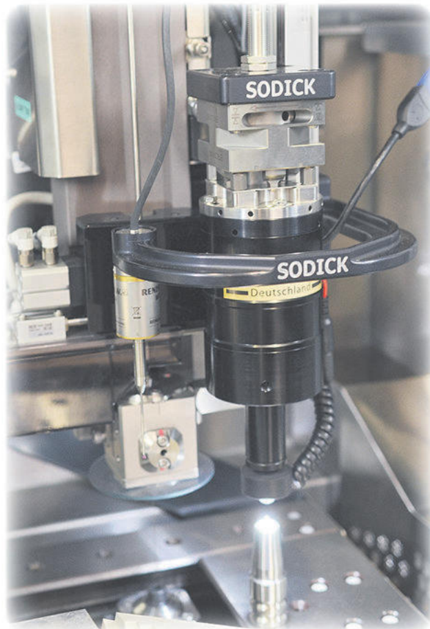
Man kan mäta optiskt med hjälp av en kamera.
