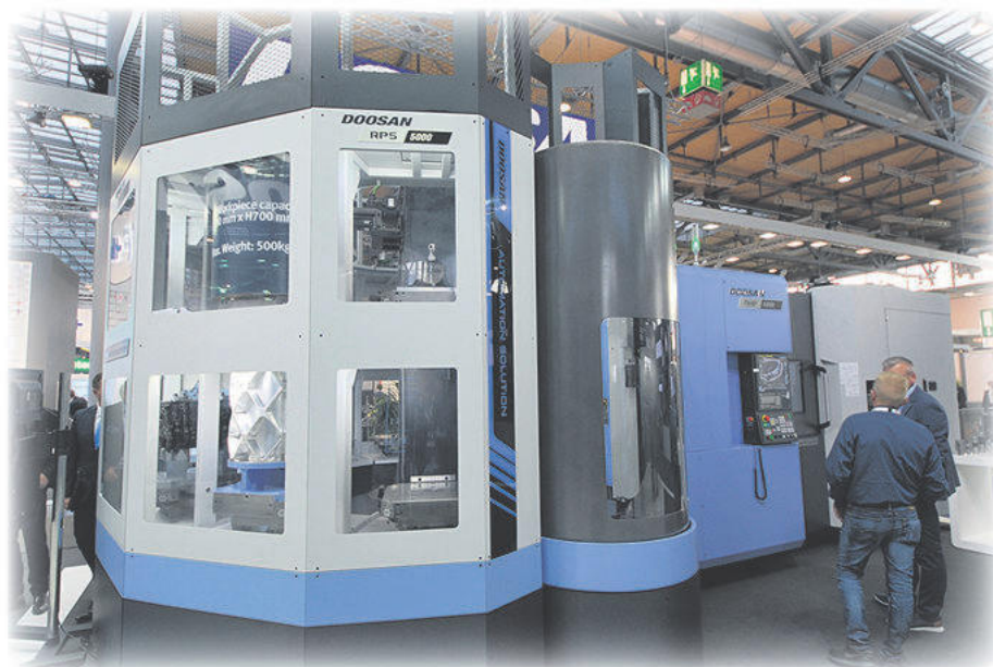
Doosan NHP5000 med styrsystem Fanuc 31iB och Doosan's nya egenutvecklade palletmagasin RPS5000/21. Horisontell 500 maskin med palletmagasin i 3 våningsplan, totalt 21 stycken paletter på en väldigt liten golvyta.
