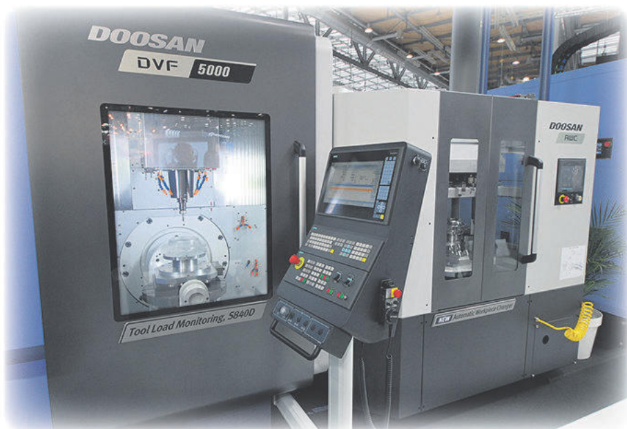
Doosan DVF5000 med styrsystem Siemens 840D och Doosan's automation AWC. Den minsta 5-axliga maskinen i Doosan's nya DVF serie med en egenutvecklad pallet växlare.
