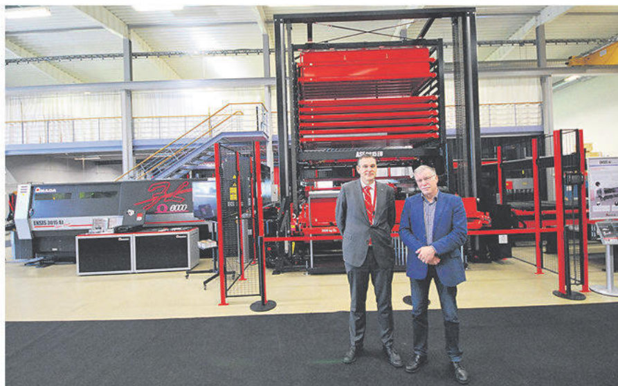
Amada visade den populära Ensis-AJ fiberlaser (6 kW) med ASF-EU höghastighets höglager och TK-L automatisk sorteringsenhet för plockning, den ideala lösningen för obemannad produktion.
