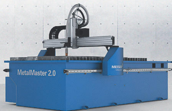
MetalMaster 2.0 Specialmaskin för plasmaskärning med hög tolerans. Gasbrännare som tillval.
