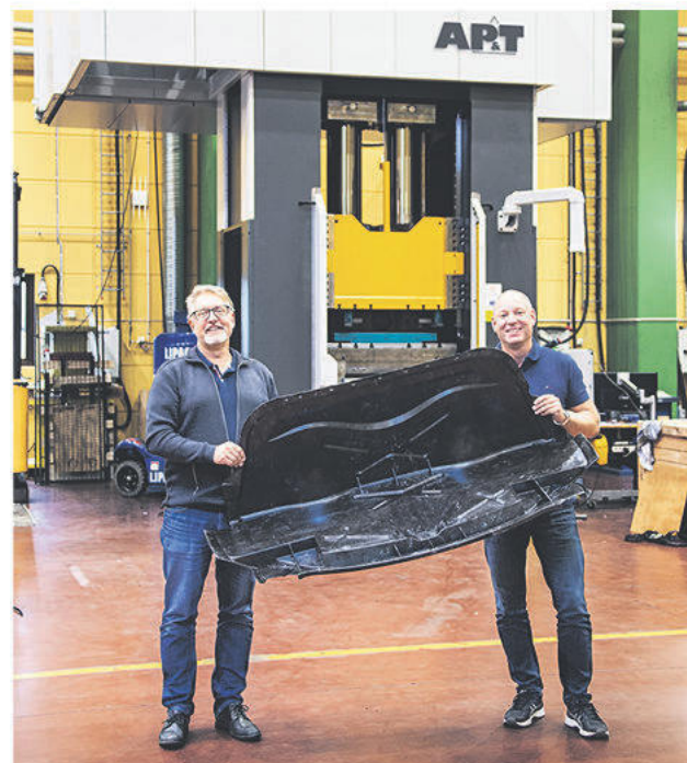
Viktbesparande kompositmaterial kan få en utökad användning i morgondagens personbilar. Kent Eriksson och Roger Nyman på AP&T visar en kombinerad hatthylla och bakvägg tillverkad i avancerad kolfiberkomposit.
