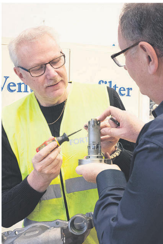
Diametern på RIQ-brotschen justeras enkelt med hjälp av en enda skruv, vilket innebär att det går supersnabbt jämfört med traditionella brotschar.
