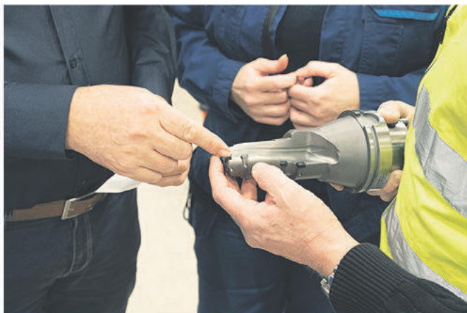
Med RIQ-brotschen har Haldex Brake Products gått från måttjusteringar en gång per skift till att verktyget kan köras i flera månader utan att det behöver justeras.
