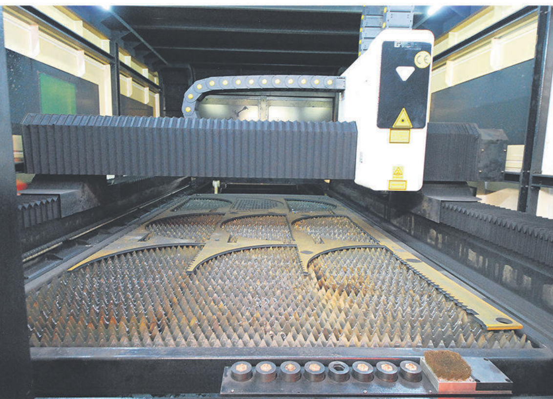
- Smart lösning med växelbordet där skärhuvudet rör sig istället för växelbordet, tycker både Ivan Martin och Jonas Claesson.
