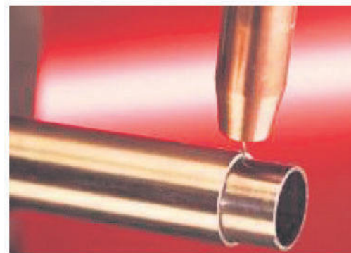
Med WireSense läser trådelektroden av komponenten och identifierar kantpositioner och kanthöjder hos såväl plåtar som rör.
