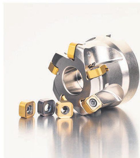
Dormer Pramets dubbelsidiga skär SNGX11 och SSN11-fräsen klarar högmåtningsfräsning med ingreppsdjup upp till 1,7mm.
