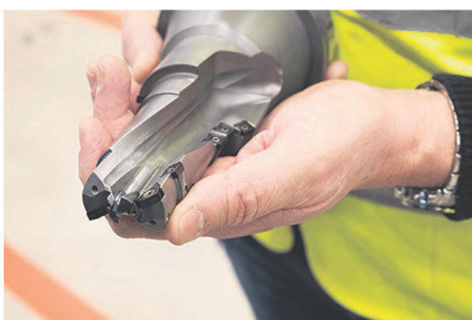
För att RIQ-Brotschen skall ge ett bra resultat är det viktigt att förborren skapar de rätta förutsättningarna.
