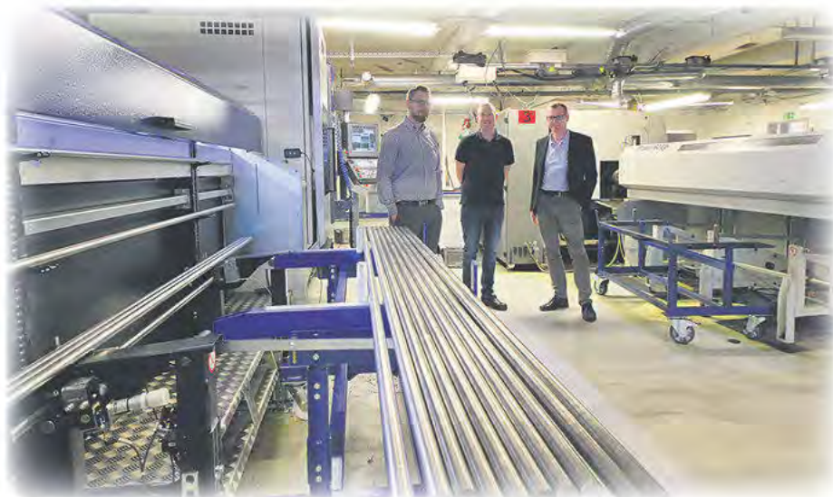
Stängerna ligger på rad i det nyinköpta stängmagasinet från IEMCA, Maestro 80 med hiss så operatören slipper tunga lyft. Man var först i Nordeuropa på Isakssons med att köpa ny teknik från den italienska maskinbyggaren.
