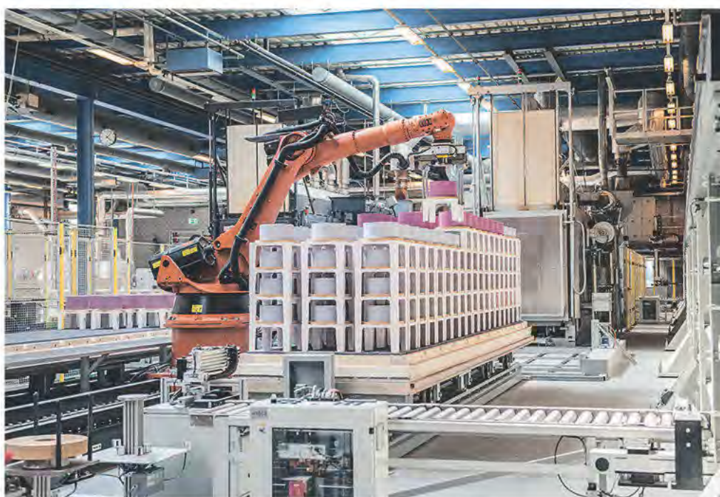
Illustration 5: Robot som laddar slipskivor för att sedan köras in i ugnen.
