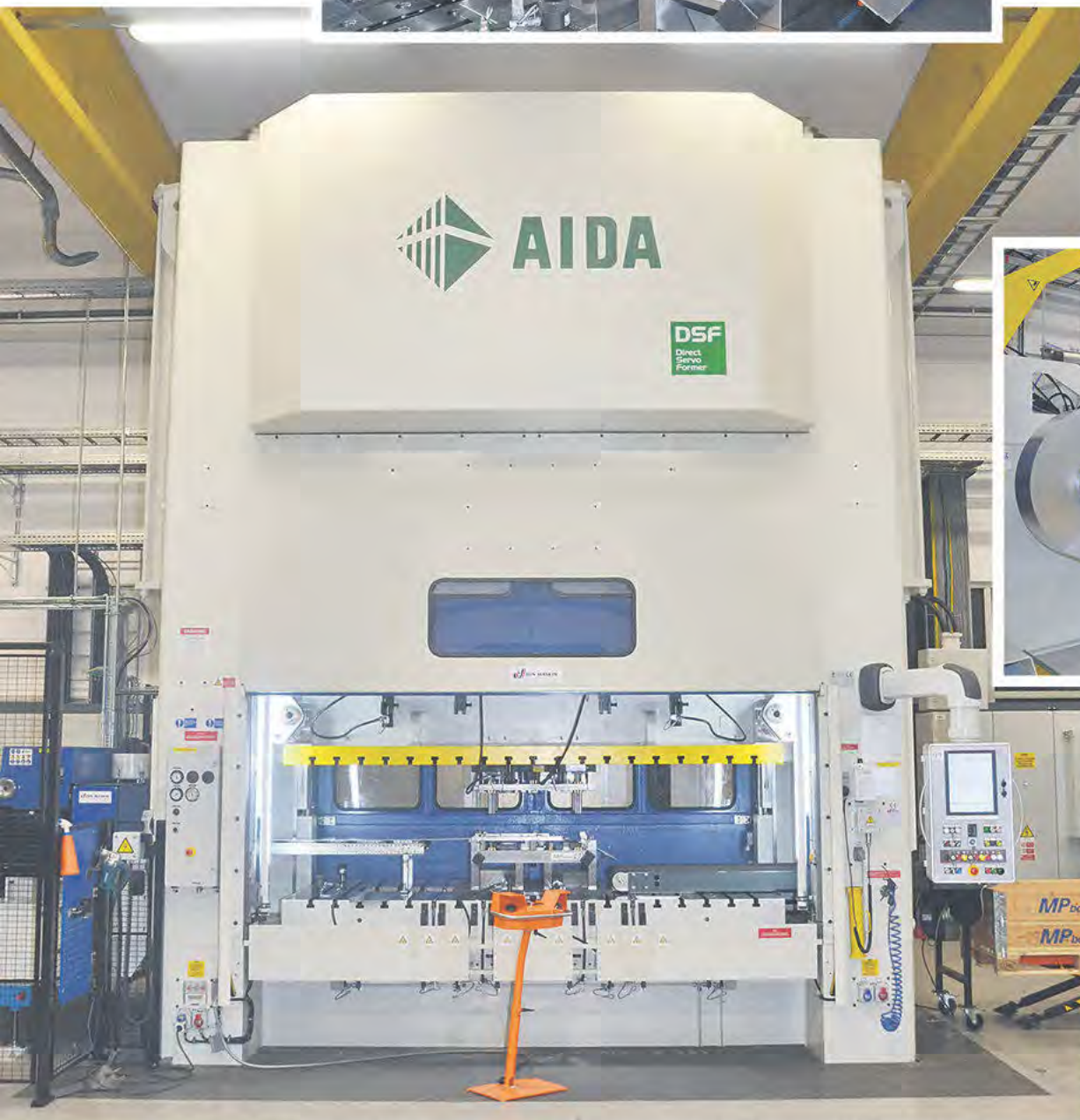
För att klara tyngden på 630 ton sänktes golvnivån under pressen och ett nytt fundament gjöts. Allt skrot leds ner i utrymmet under pressen och sedan ut genom produktionshallens vägg, vilket har minskat bullernivån.
