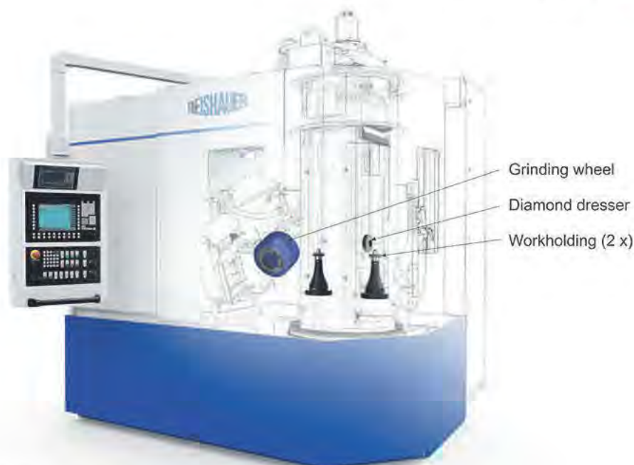
Illustration 2: Insidan av en slipmaskin med verktyg
