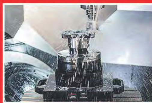
HYDROK – stationär hydraulchuck med adaptionsmöjligheter
