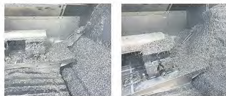
Spånmängd efter 10 min fräsning med ECP-H7 vs EC-H7 i material SS2541
