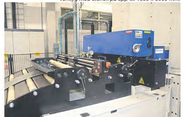
MP-bolagen använder en bandbredd på mellan 50 och 750 millimeter, och i servopressen kan det sitta verktyg med storlek på upp till 1500 x 3000 mm.
