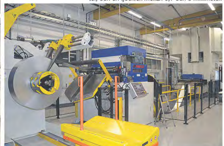
Coilhanteringsutrustning från Dimeco med kapacitet för stålband upp till 15 ton. Bandmatningen klarar en bandbredd mellan 50 och 1150 millimeter, och en tjocklek mellan 0,7 och 5 millimeter.
