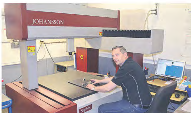
Kvalitets- och kontrollansvarige Suad Samardzic, som även är delaktig i utbytet med systerföretaget Mak Madesjo i Nordmakedonien, mäter en detalj i mätmaskinen från CE Johansson.
