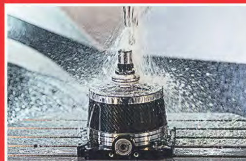
MANOK plus kolfiber – stationär manuell chuck av kolfiber med adaptionsmöjligheter
