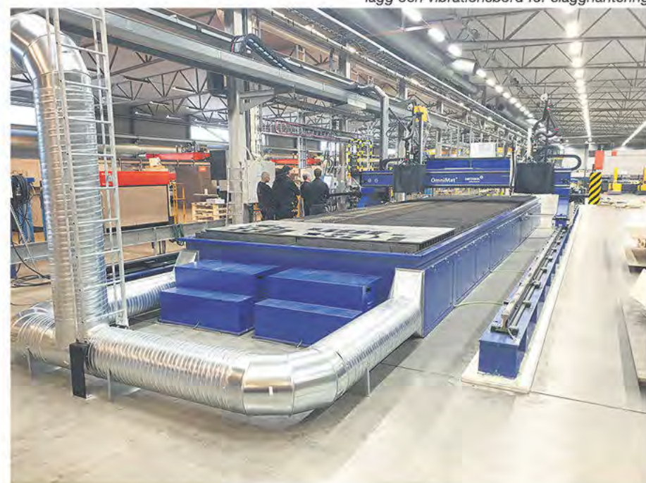
Messer Omnimat 5000 med 12 meter skärupplägg och vibrationsbord för slagghantering
