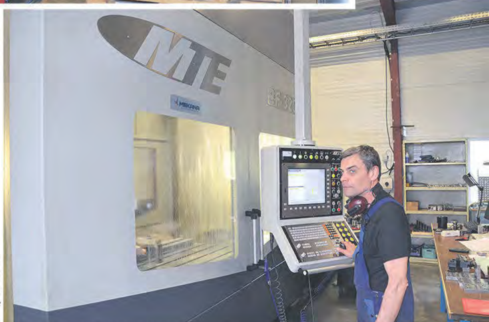
Den nya bäddfräsen från MTE och Mekana Maskin är perfekt för längre detaljer berättar operatör Ronny Erlandsson.
