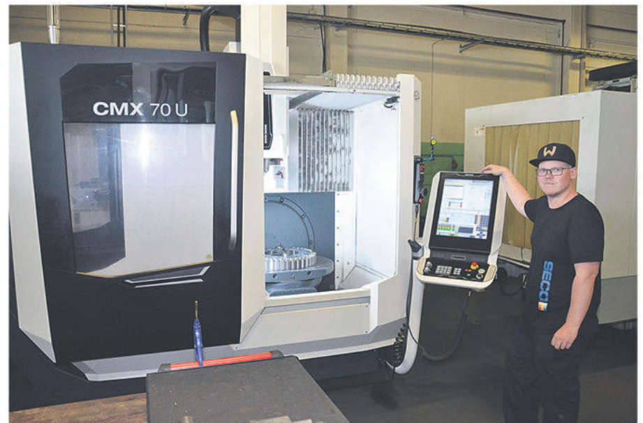
TRAMEK:s CMX70U är utrustad med 3D quick set och styrsystemet Heidenhain 620.
