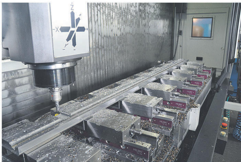
Med ett bord på 3500 millimeter går 870 millimeter kan Slipmekano köra stora detaljer plus att man kan köra 5-axliga detaljer upp till en meter i diameter.
