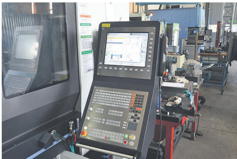
Till Doosan 850 VCF LSR II valde Slipmekano Heidenhain TNC 640 som styrsystem, vilket är ett system som de kände till sedan tidigare och är nöjda med.
