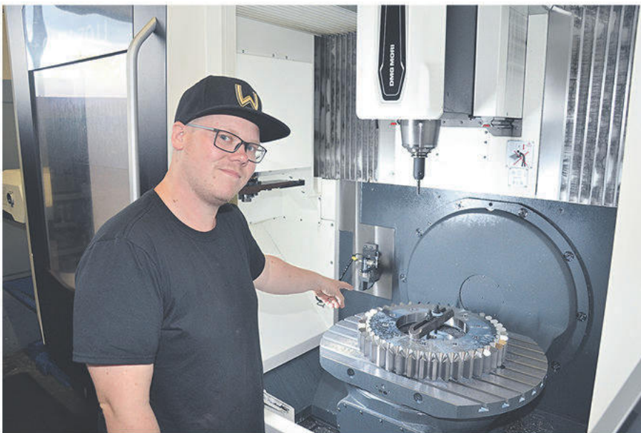
Den senaste fräsen, CMX70U, har en 5-axlig gjutenbädd, skärvätskeanläggning 600L 20bar genom spindel och prob- och inmätningsskit.
