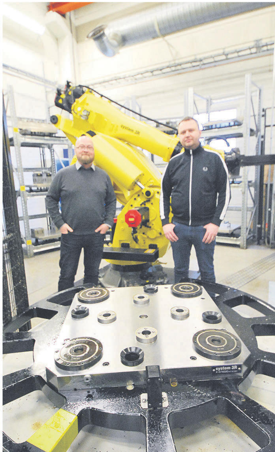
Den senaste robotcellen är från 2014 och avsedd för produktion av större detaljer. Den består av en 5-axlig fräsmaskin av modell DMU80 duoBlock P4 med 250 verktygsplatser och ett robotsystem från System 3R med 24 palettplatser. På fotot ser vi Lars Westin och Denis Ibrakovic.
