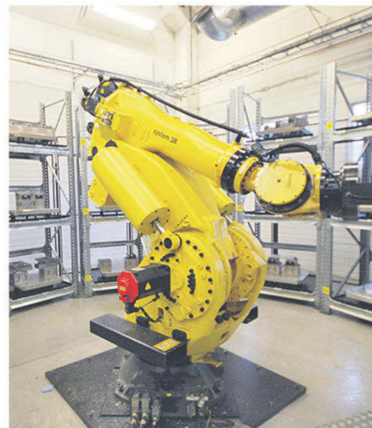
Den senaste robotcellen är från 2014 och avsedd för produktion av större detaljer. Den består av en 5-axlig fräsmaskin av modell DMU80 duoBlock P4 med 250 verktygsplatser och ett robotsystem från System 3R med 24 palettplatser. På fotot ser vi Lars Westin och Denis Ibrakovic.
