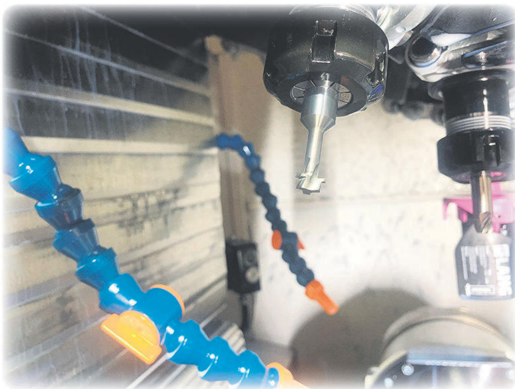
Ett av specialverktygen som levererades till Nyströms var denna profilfräs
