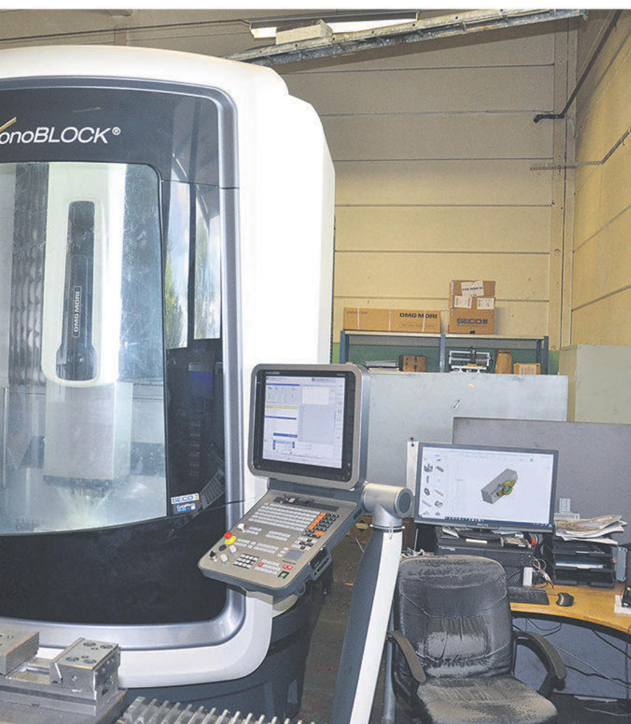
DMU75 Monoblock var den första 5-axliga fräsen som företaget köpte 2017. Maskinen är bland annat utrustad med skärvätskeanläggning 600L 40bar genom spindel, coolant ring jet, och Blum laserinmätning av verktyg.
