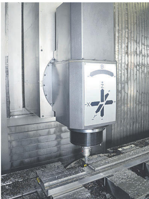
Doosan 850 VCF LSR har en spindeleffekt på 22kW och spindelvarvtal på 12000 rpm.
