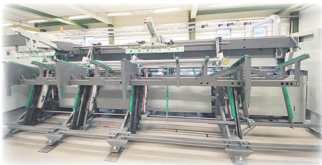
Det nya robusta magasinet är från början framtaget till den större maskinmodellen LT8. Magasinet klarar en buntvikt på 5 ton och är framförallt mer lättillgängligt vid lastning av nya rörbuntar. Vid körning av öppna profiler och special profiler kan kunden välja till optionerna "Pusher" och "Loading Chains".
