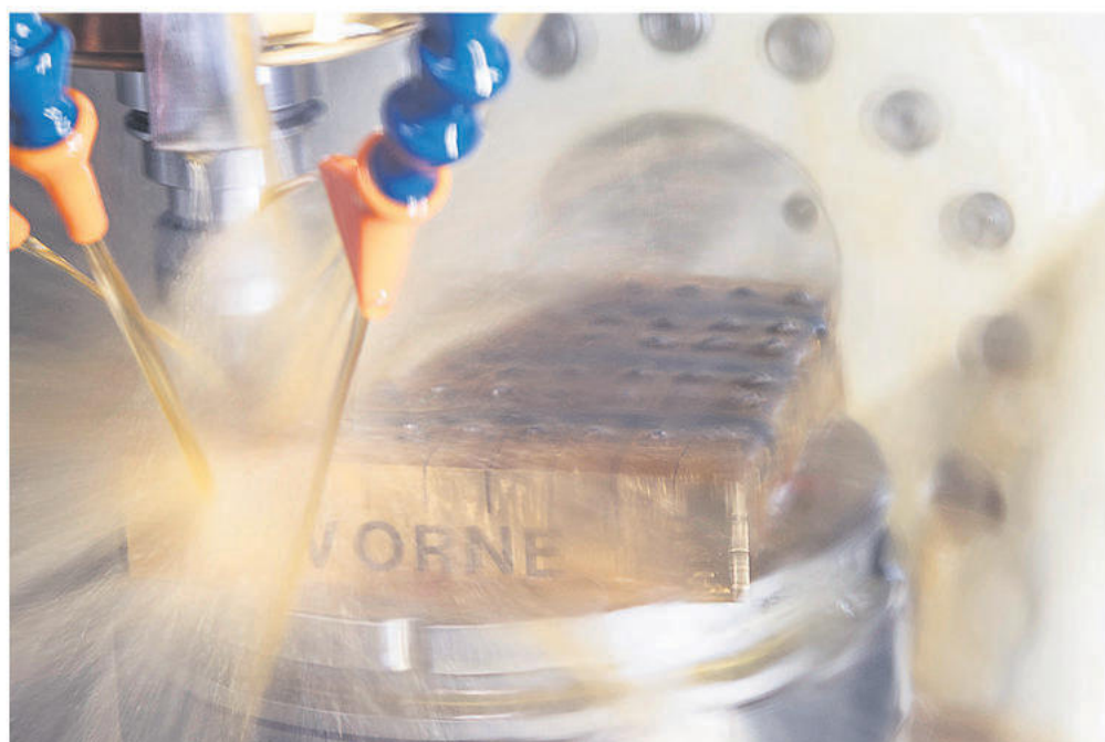
Fyra bearbetningsstationer – två Kern Micro och två Kern Evo – ingår i en Kern robotcell. De producerar mycket krävande delar med toleranser i mikrometerområdet och ytor i nanometerområdet dygnet runt.
