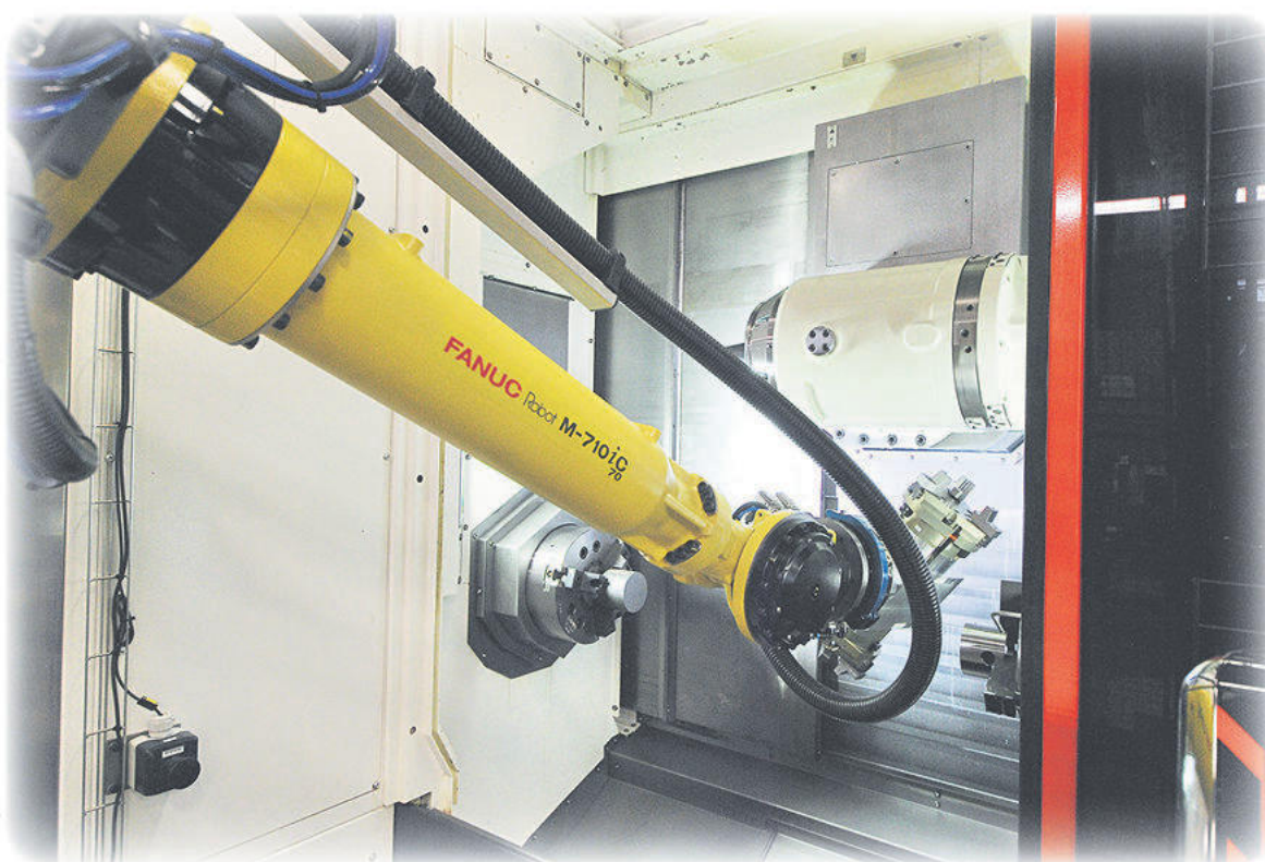
Laddning och plundring sker med robot.
