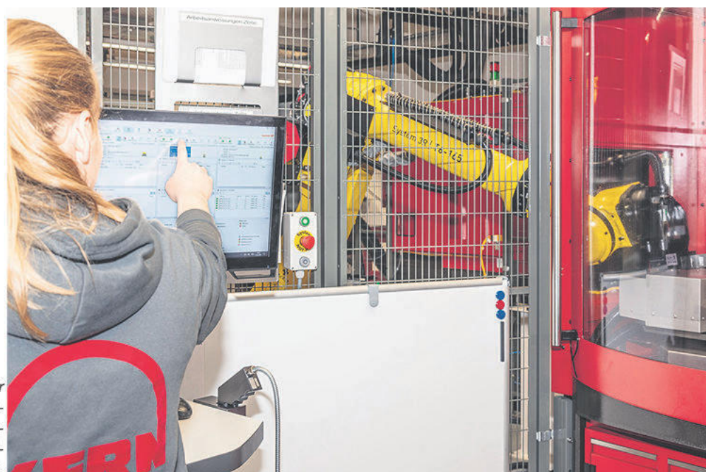
WorkShopManagers pekskärm gör arbetet med robotcellen enkelt. En kvalificerad tekniker och en eller två assistenter är tillräckligt för att köra robotcellen och de fyra maskinstationerna.
