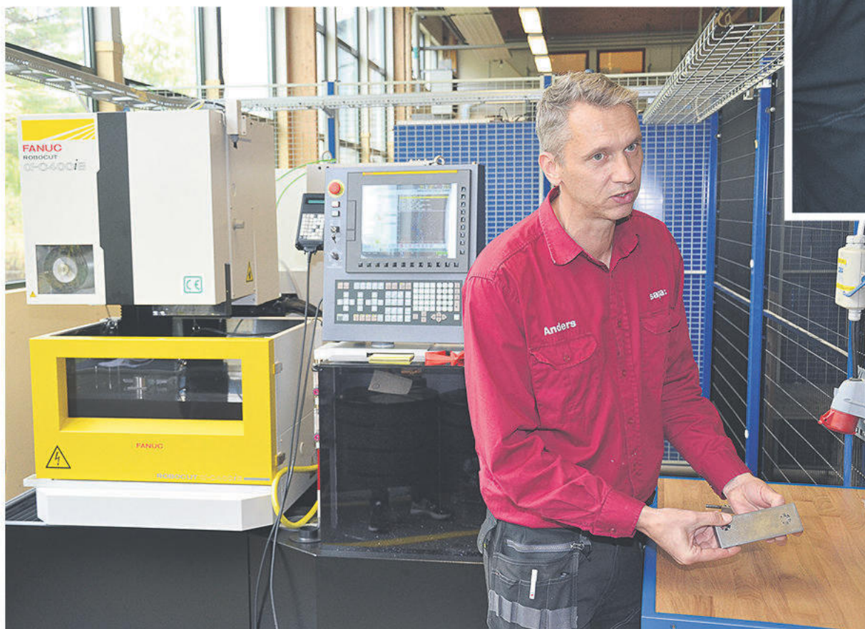
Anders Svensson, lärare för den nya verktygstekniska utbildningen, visar upp en detalj som lärarna har tagit fram i den nya trådnisten. Detaljen är en del av det verktyg som eleverna ska klara av att tillverka.
