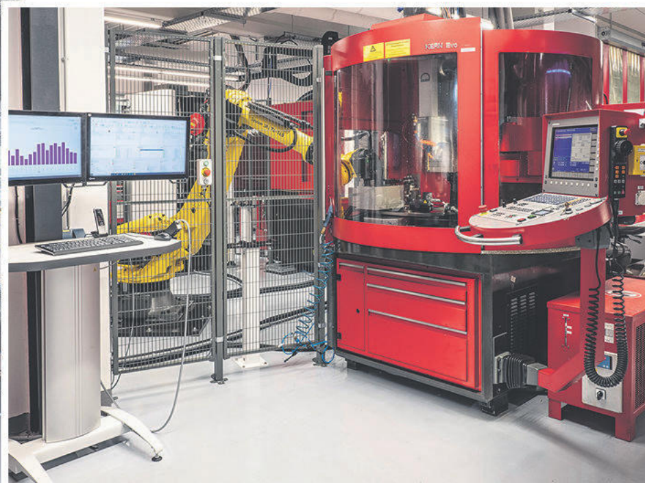
Kern Microtechnik byggde in en robotcell i sin verkstad. Var och en av de fyra maskinstationerna har en utnyttjandegrad på 94 procent. Foto: Kern Microtechnik GmbH
