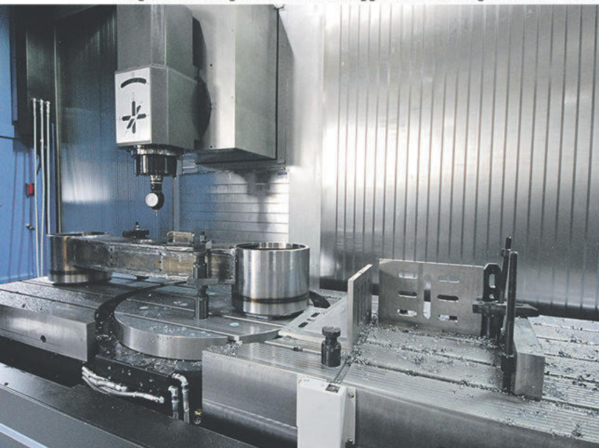
Maskinbordet med en mellanvägg som kan utnyttjas vid pendelkörningar/taktkörning. På fotot ser vi boggie armar till skogsmaskinen Terris.
