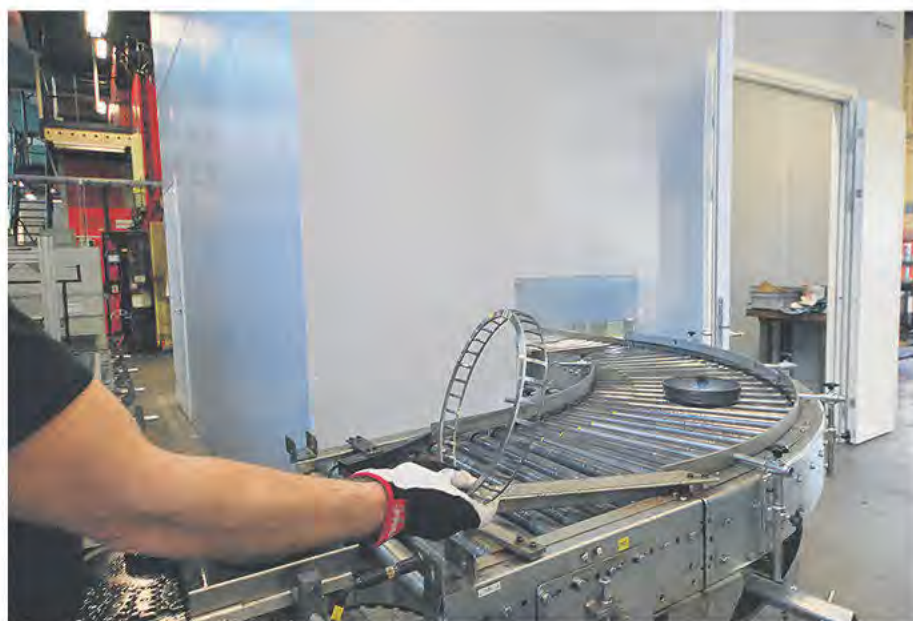
Pressen är utrustad med automationslösning för hantering av detaljer från inkommande transportband, genom press och vidare på utgående transportbana.
