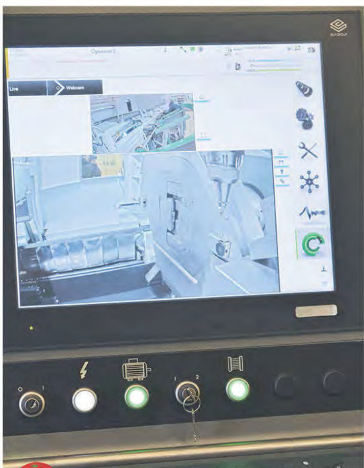
Maskininterfacet på ADIGE's nya rörlasermaskiner är mycket användarvänligt och gör det enkelt för operatören att producera i maskinen. Operatören får hjälp med kameror från baksidan för att se vad som händer i buntmagasinet, och inifrån skärutrymmet där operatören kan se röret och skärhuvudet arbeta.
