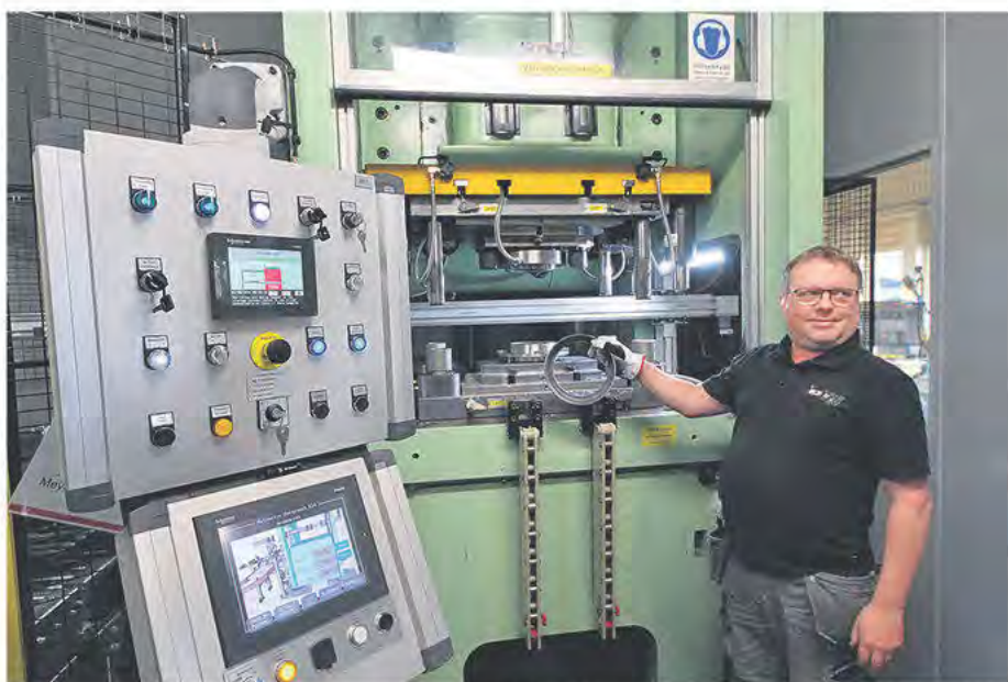
Produktionstekniker Erland Andreasson framför Chin Fongs modell SC1-260 som är en mycket stabil 4-pelarpres med enkel vevstake. Pressen är utrustad med Olsons Maskinservices styrsystem för automatpressar, Flexi 5 Prog. I leveransen ingår även en specialanpassad transfer för in- och utmatning av detaljer i pressen.
