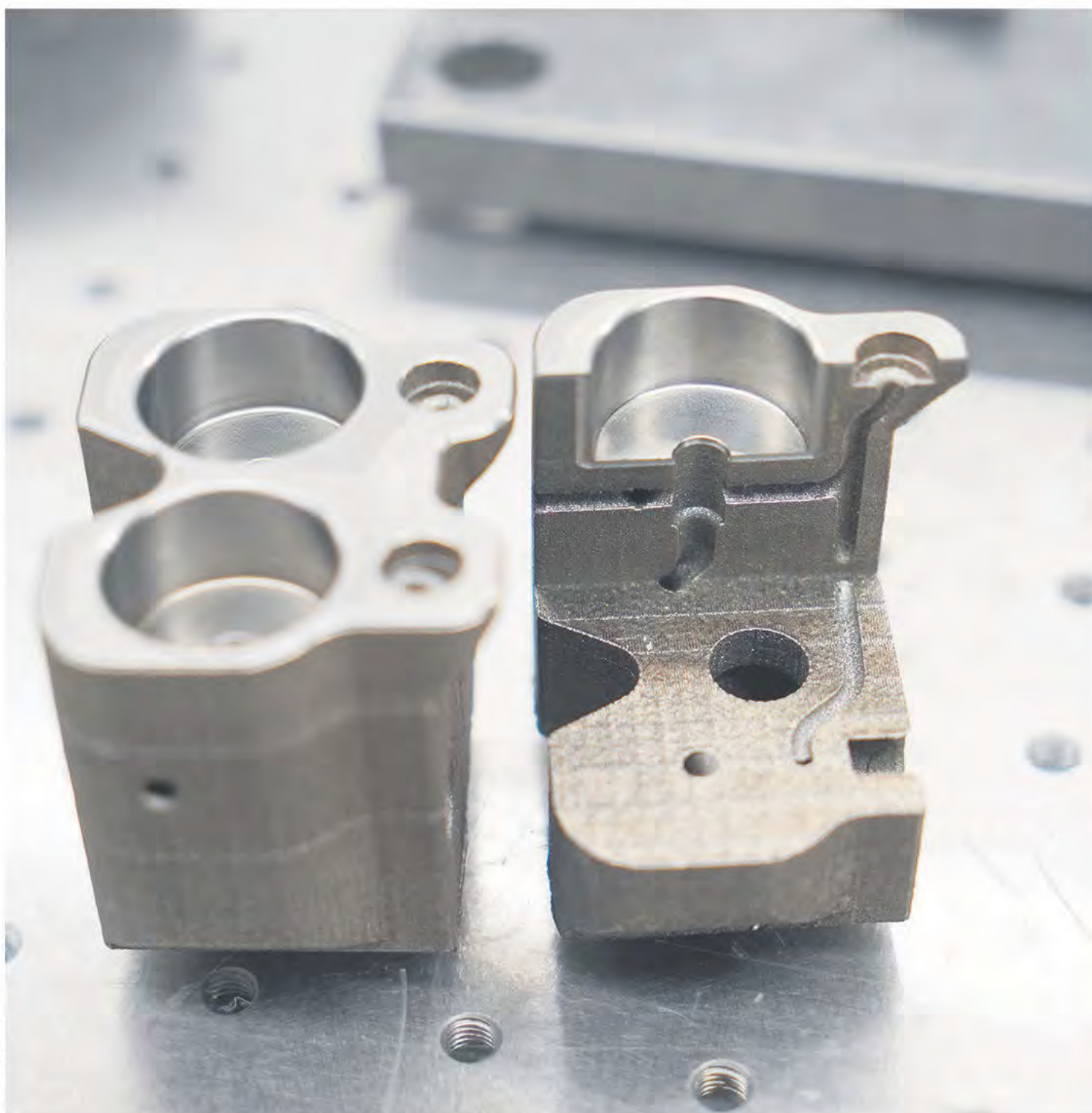
Ett ventilhus tillverkat i Lumex Avance-60 som vi har gjort några små ändringar av. Utskriften är bara ett test för vår egen del och för att undersöka hur interna kanaler kan modelleras och produceras.
