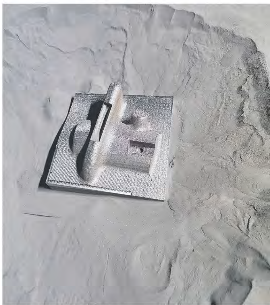
Ett tryck av testmodellen (ca 1 kg). Denna del ska bearbetas i 5-axlig fräsning
