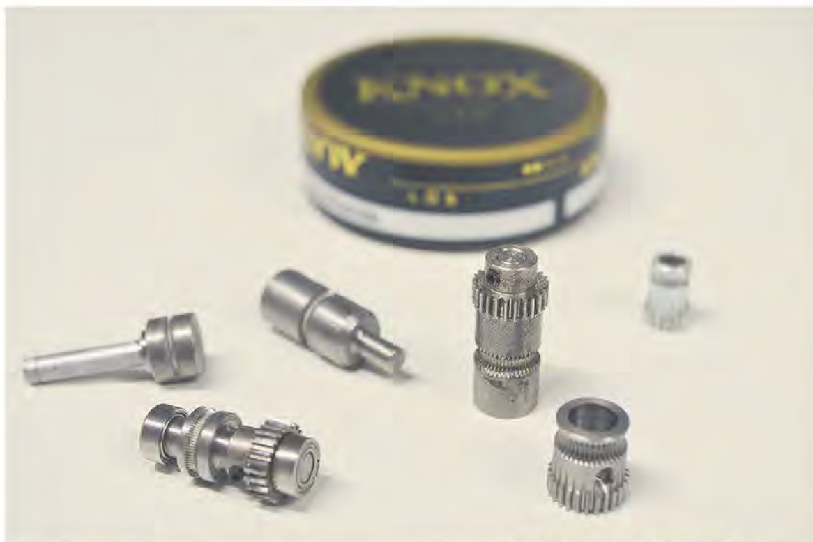
Bilden visar drivhjul i en matare som greppar materialet från två sidor för en tillförlitlig och säker matning. Resultatet blir en mer tillförlitlig, noggrann och snabbare utskriftsprocess.
