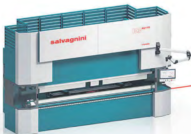
B3.AU-TO Kantpress med helautomatiskt verktygsbyte
