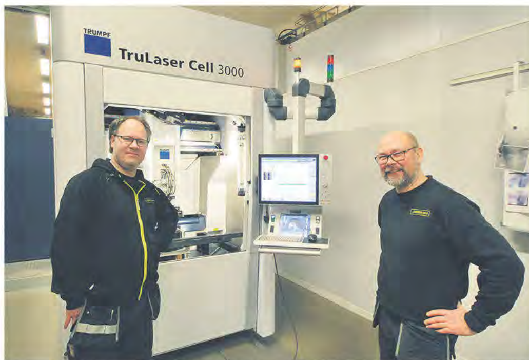
TruLaser Cell 3000 utrustad med en 5kW disclaser, den senaste maskininvesteringen som ger utökad svetskapacitet på Lasertech med det senaste inom laserbearbetning av små och mellanstora detaljer. Denna mångsidiga 5-axliga linjärdrivna maskinen levererar 2D och 3D skärning och svetsning i toppkvalitet.
