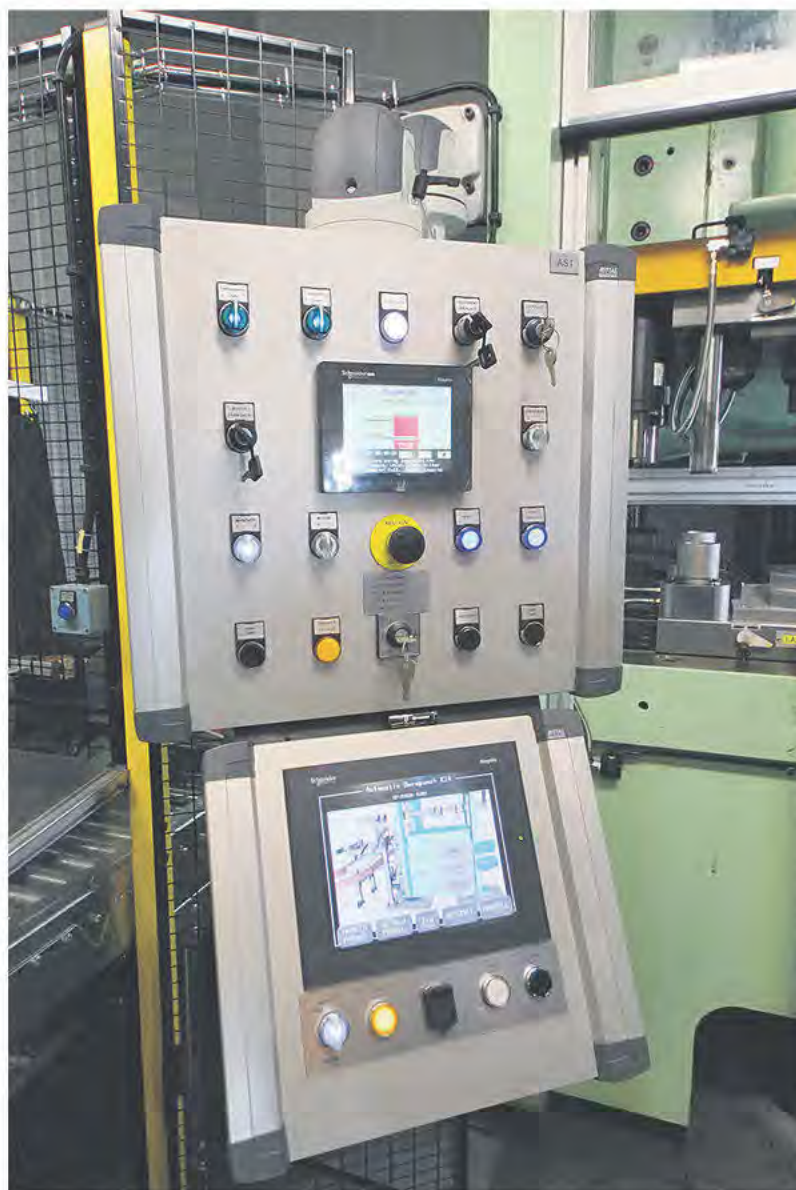
Pressen har utrustats med Olsons Maskinservices styrsystem för automatpressar, Flexi 5 Prog, med operatörsinterface på arm vid operatörsplatsen.
