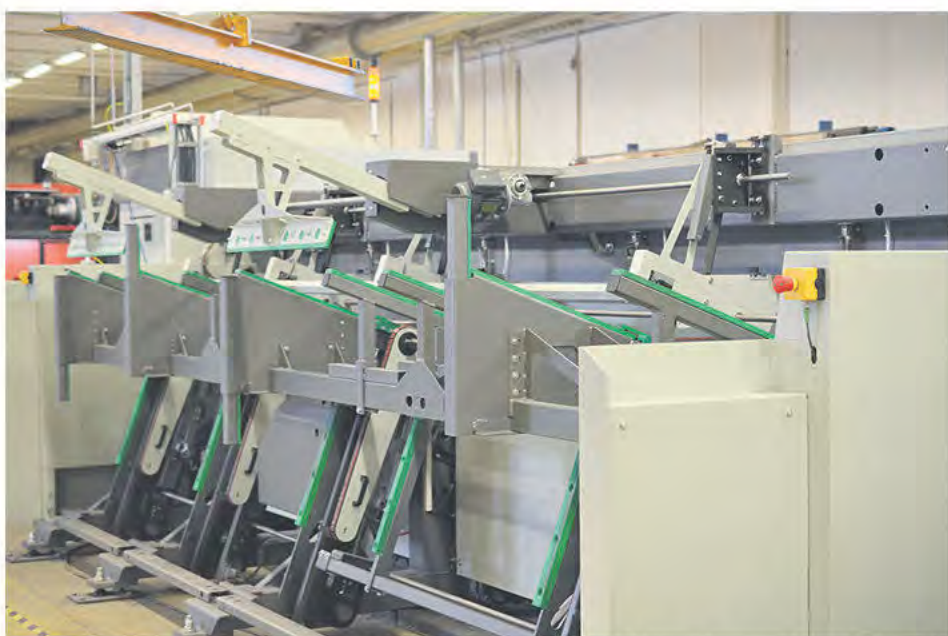
Det nya robusta buntmagasinet är från början framtaget till den större maskinmodellen LT8. Magasinet klarar en buntvikt på 5 ton och är framförallt mer lätt tillgängligt vid lastning av nya rörbuntar. Vid körning av öppna profiler och special profiler kan kunden välja till optionerna "Pusher" och "Loading Chains".
