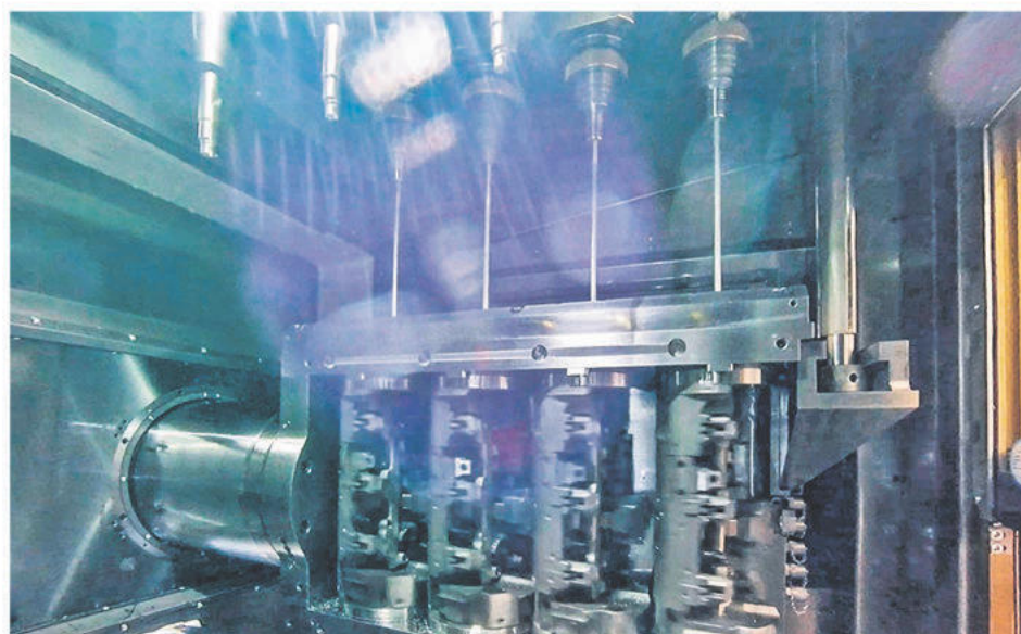
4-spindlig bearbetning av delar för bränsletillförsel med djuphålsbör. Fixturer som roterar i motsatt riktning till borren för att förbättra rakheten, det gör lösningen exceptionell. (Foto från ELHA)
