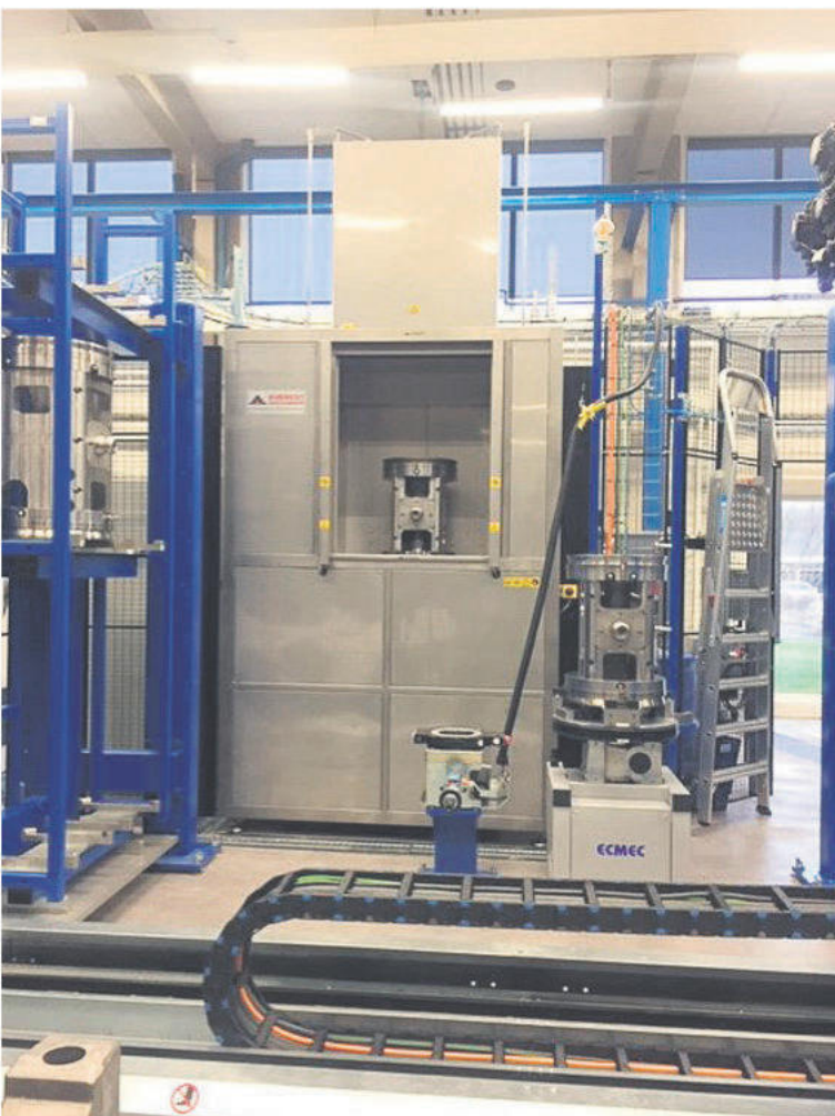
Yaskawa-roboten, som förflyttar sig på räls i cellen, placerar gods och fixtur i Everest stora industrivätanläggning 750 WD, som i Norden säljs av Euromaskin - Stenbergs systerbolag.
