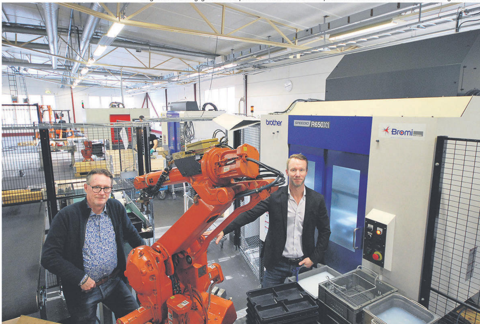
Hög automatiseringsgrad i denna produktionscell. BROTHER Speedio R650 X1 med ABB robotik och integrerad tvätt.
