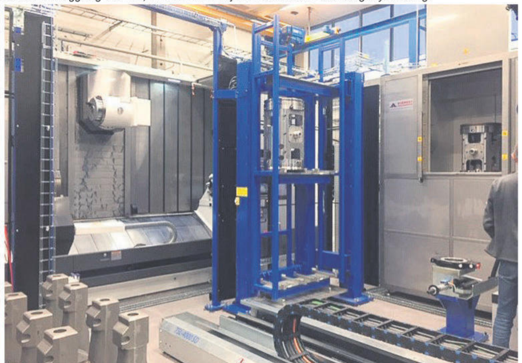
Yaskawa-roboten, som förflyttar sig på räls i cellen, placerar gods och fixtur i Everest stora industrivätanläggning 750 WD, som i Norden säljs av Euromaskin - Stenbergs systerbolag.
