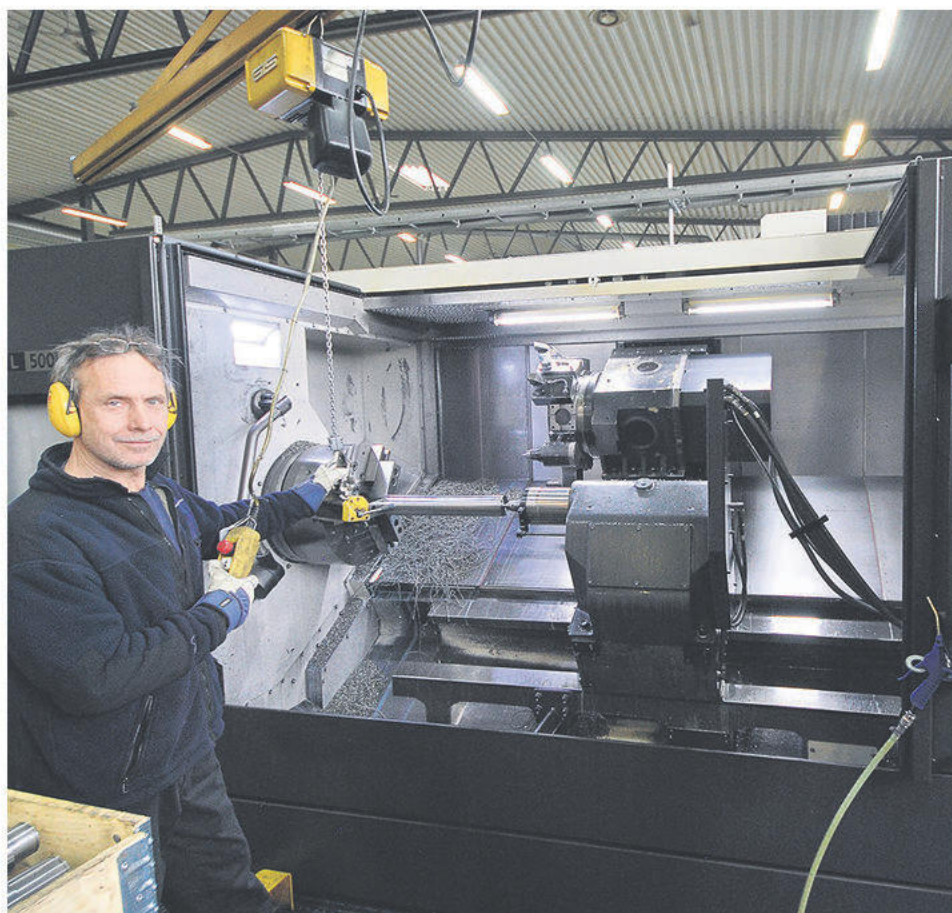
Maskinoperatören Johan Persson Hyundai L 500 LMA, Sving på över 1 m, svarvlängd över 2 m. 21" chuck och drivna verktyg BMT 75, en riktig arbetshäst.
