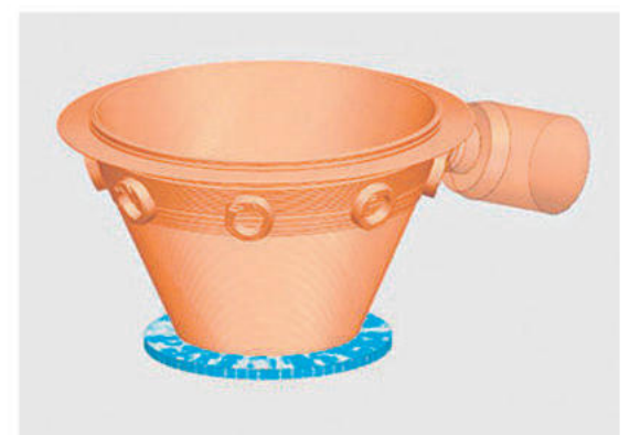
Simulering av den additiva byggprocessen med hjälp av In Process Workpiece (IPW)
