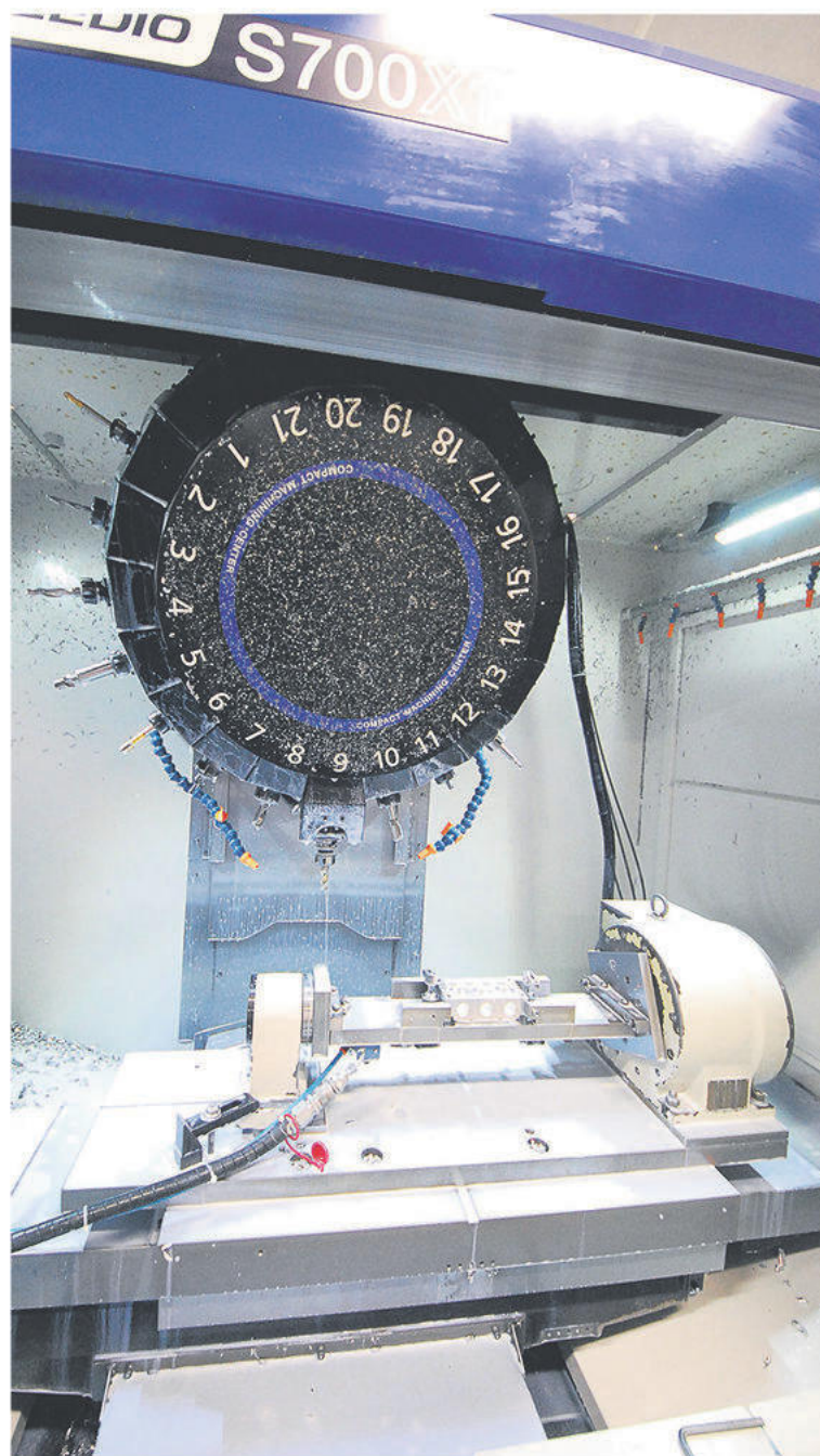
Hög automatiseringsgrad i denna produktionscell. BROTHER Speedio R650 X1 med ABB robotik och integrerad tvätt.
