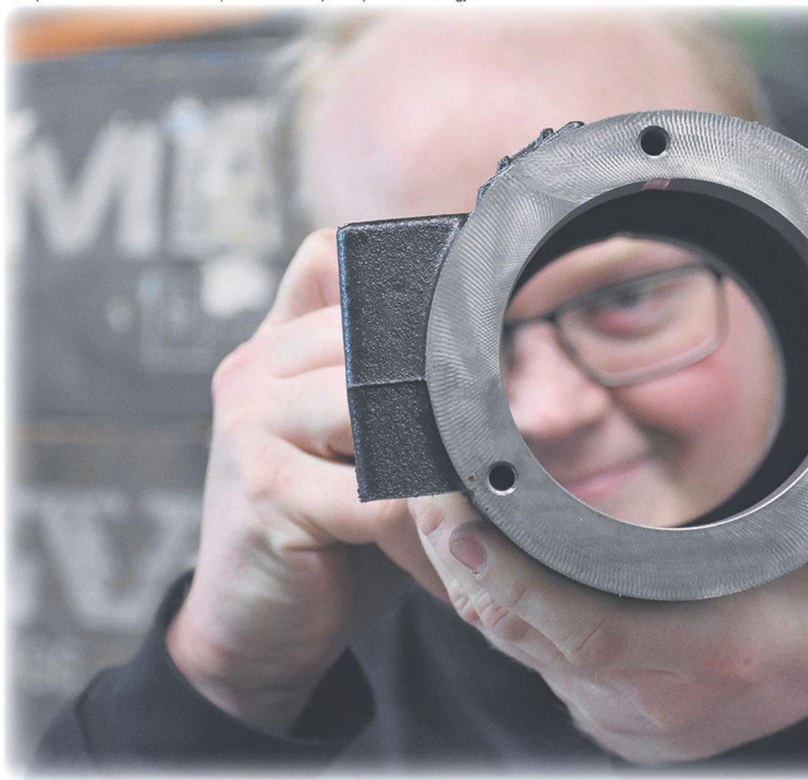
Komponent till ett vibratorhus - (markvibrator - padda) - material segjärn.
