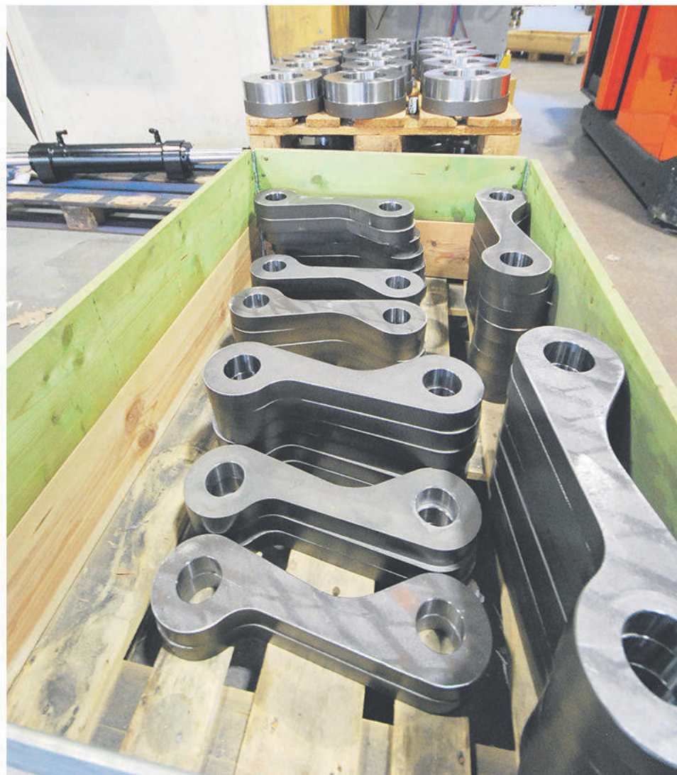
Laserskurna detaljer som väntar på vidareförädling. -Vi kallar de för hundben lite skämtsamt, säger Niklas Andersson.
