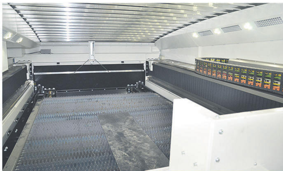
När PST:s operatörer har skurit färdigt plåten i fiberlasermaskinen bockas plåten i företagets två kantpressar på 320 ton. Därefter svetsas, tvättas, lackeras och monteras produkten.
