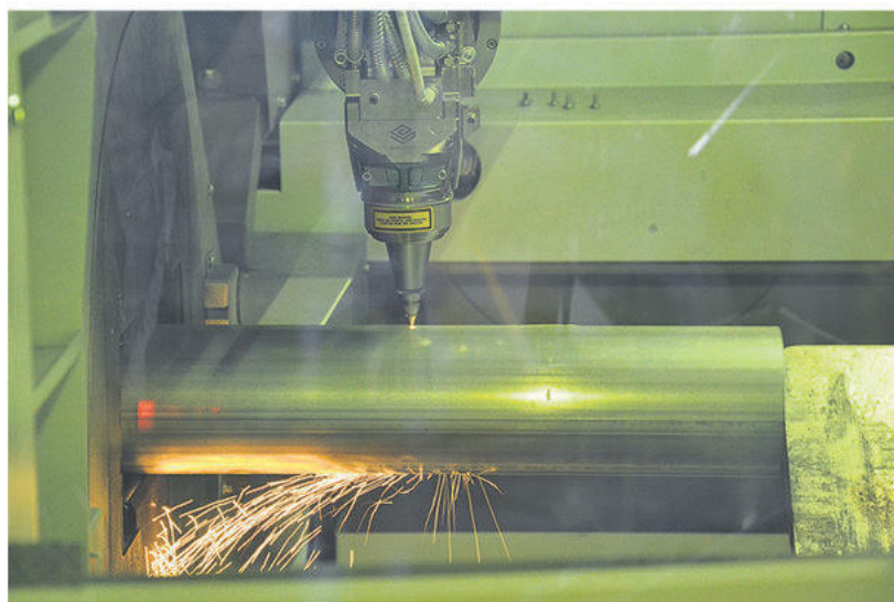
Conpipe upplever en stor skillnad mellan på fiberlaser och CO2-laser i effekt, förbrukning av el och verkningsgrad.
