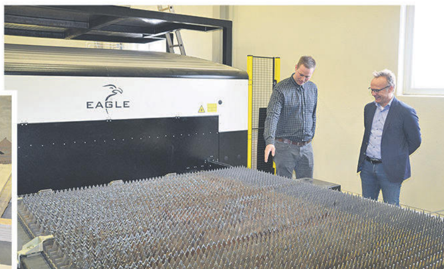
Eftersom PST har behov av att skära plåtar som är 2000 millimeter breda och 3000 millimeter långa, och använder svart stål med tjocklek på 20 millimeter valdes ett växlingsbord på 2000 gånger 4000 millimeter.
