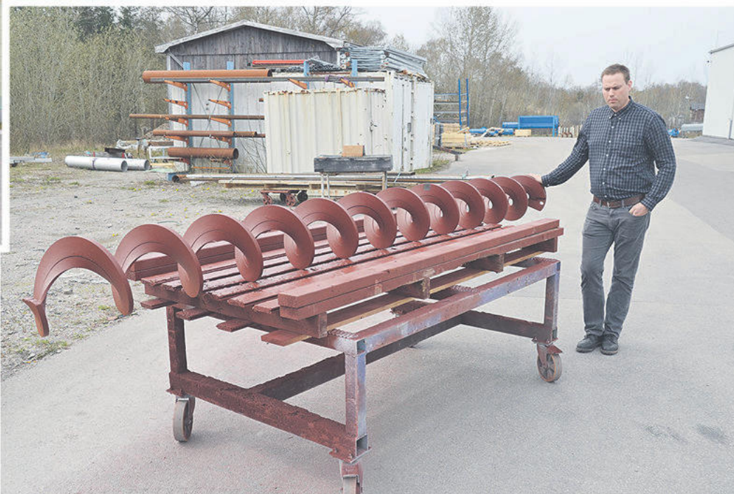
Robert Karlsson, produktionschef för PST, visar upp en typisk spiraltransportör – som inte är tillverkad med digitaliserad mätning utan är ett hantverk. Spiralen målas för transporten, och försvinner direkt när den tas i drift.
