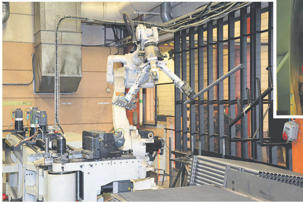
En robot från Yaskawa Nordic, som också finns i Torsås kommun, laddar en rörböckningsmaskin som företaget har köpt från BLM och Edströms.
