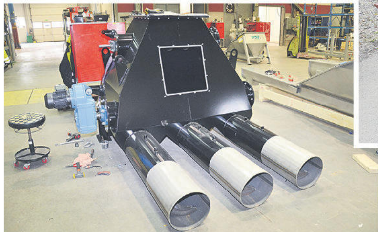
PST:s transportörer kan användas till mycket, bland annat som inmatare och transportsystem för pelletsbrännare.
