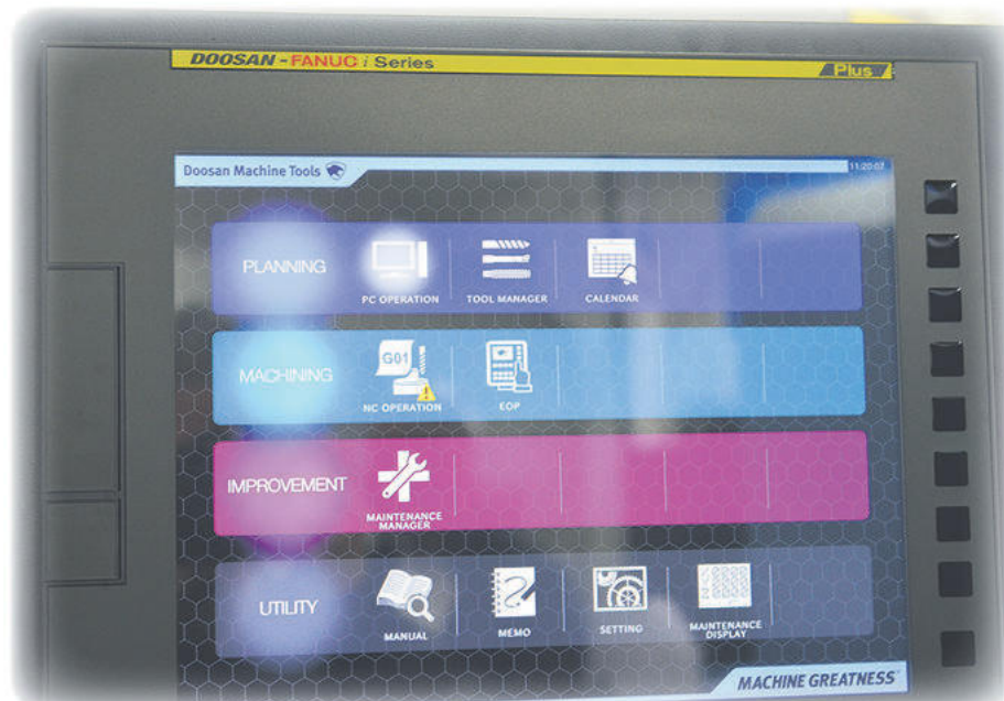
Styrsystem Fanuc 0iT PLUS EZ-Guide iHMI samt Touch display 15".
