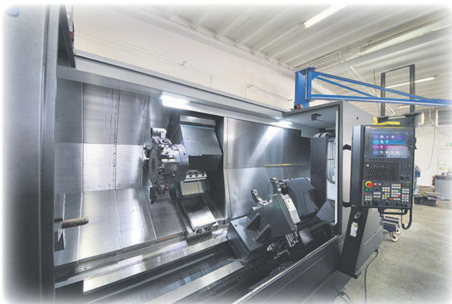
Programmerbar dubbdocka med inbyggd lagrad pinol MK5. Fast dubb MK5 till ovan dubbdocka. Max svarvlängd 2 125 mm. Programmerbar dubbdocka med lagrad inbyggd pinol. Förberedd för programmerbart hydrauliskt stödlager Atlings AX6 Ø30-255 mm
