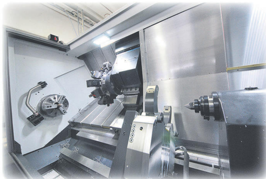
Programmerbar dubbdocka med inbyggd lagrad pinol MK5. Fast dubb MK5 till ovan dubbdocka. Max svarvlängd 2 125 mm. Programmerbar dubbdocka med lagrad inbyggd pinol. Förberedd för programmerbart hydrauliskt stödlager Atlings AX6 Ø30-255 mm
