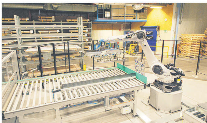
Robot hanterar paneler i slutet på den automatiserade produktionscellen. Man kallar det för linjärstapling på Swegon och det handlar om att få plats med fler paneler på pallen.
