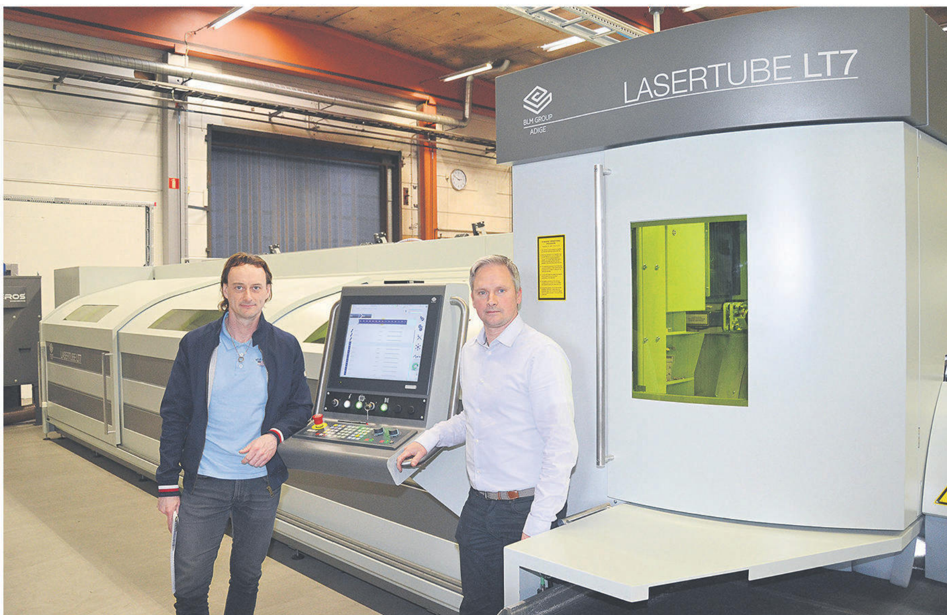
Jim Davis, Edströms rörlasersäljare, och Mattias Lind, VD för Conpipe Engineering, visar upp Conpipes senaste investering, rörlaserbearbetningsmaskinen Adige LT7 från BLM Group som nu gör att företaget kan göra jobb inom aluminium.
