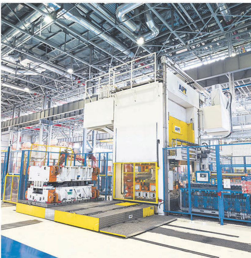
Ett nytt kylsystem för pressverktyg, utvecklat av AP&T, har minskat cykeltiden avsevärt.
