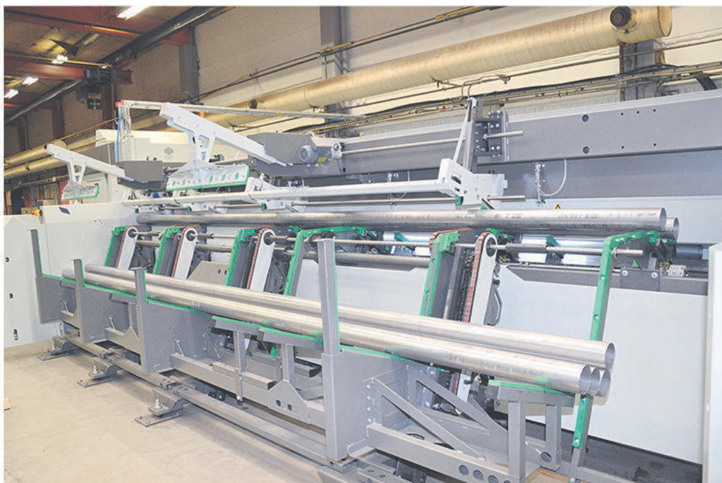
Det är enkelt att ladda material i Adige LT7. Conpipe kör alltid slut på en laddning innan de byter storlek för att slippa extra materialhantering.
