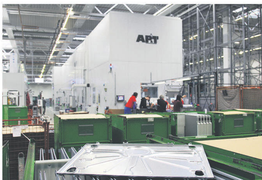
AP&T:s 6-presslinje har gjort det möjligt att utöka produktionen av metallkomponenter till de vitvaror som tillverkas vid Miele's anläggning i Unicov.
