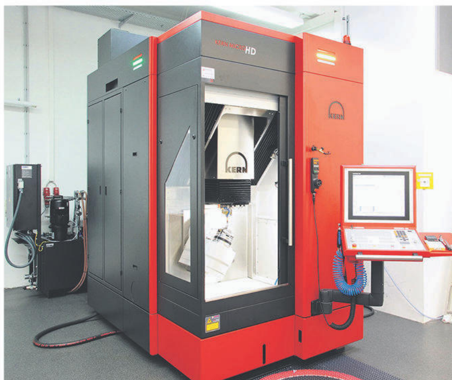
Kern Micro HD i arbete hos Cemec Intelligente Mechanik GmbH. På liten uppställningsyta förenar detta femaxlade bearbetningscentrum högsta precision och effektivitet.
