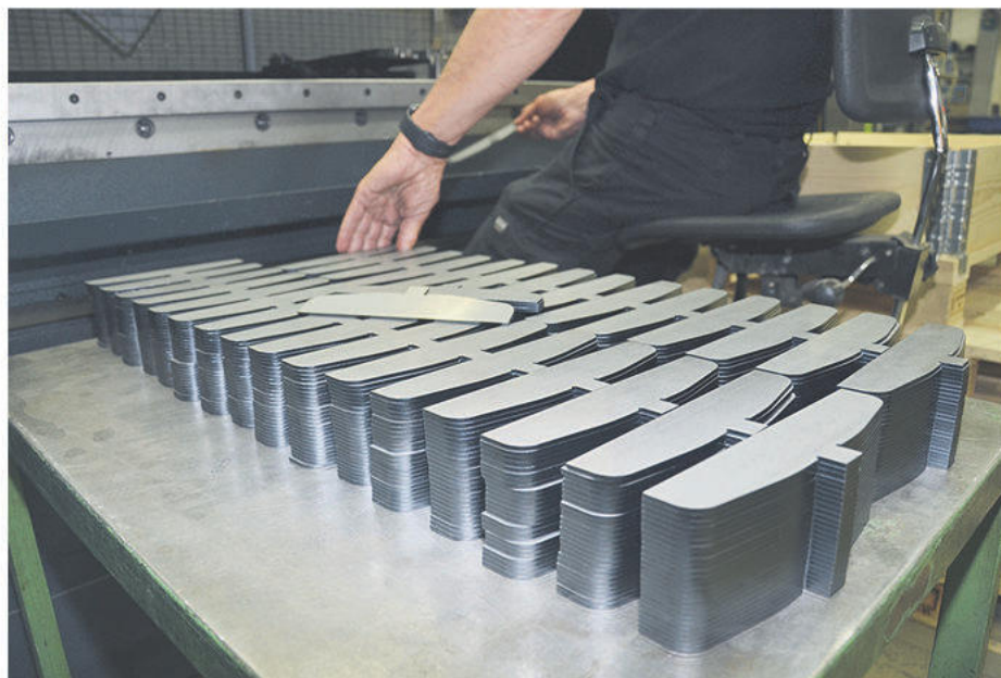
Företaget tillverkar små serier inom järnplåt, allt från 0,1 till 10 millimeter, till fordonsindustrin, möbelindustrin och belysningstillverkare.
