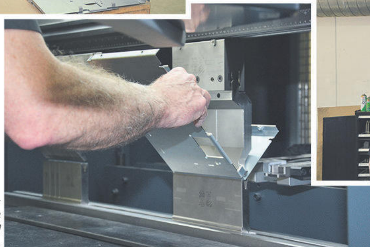
Den servoelektriska pressbalken möjliggör höga presshastigheter med extrem noggrannhet.
