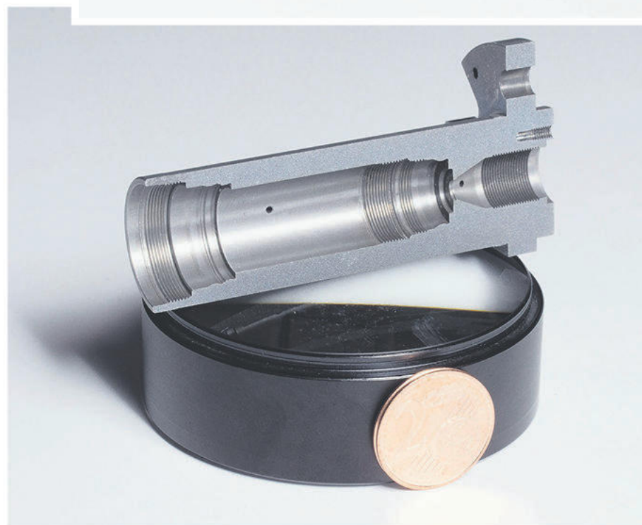
Teleskop för en kommunikationssatellit i genomskärning: Denna optiska komponent och enskilda delar som en ring för kompensation av termisk utvidgning fräser Cemec på Kern Micro HD med reproducerbarhetsexakthet på mindre än 1 µm.
