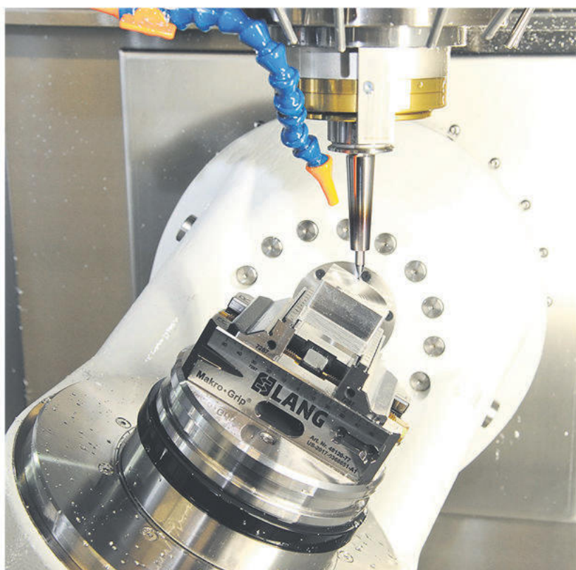
En blick in i arbetsutrymmet. Med anläggningen från Kern uppnår Martin Schwab jämnheter på mindre än 800 nm och kan efterarbeta arbetsstycken på mikrometernivå.
