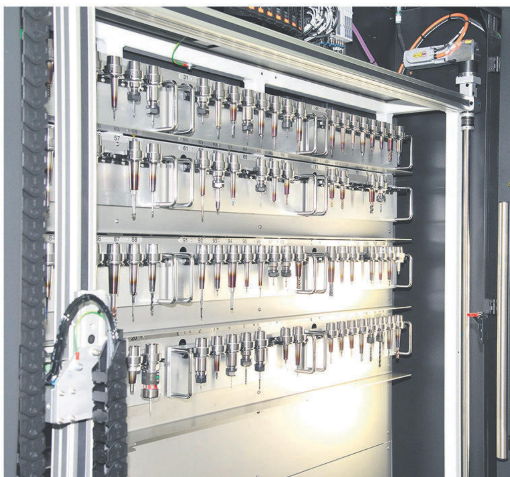
Välbestyckad: För sina komplexa bearbetningar utnyttjar Cemec de upp till 210 platserna i verktygsväxlaren på Kern Micro HD fullständigt.
