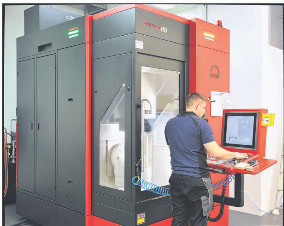
Kern Micro HD i arbete hos Cemec Intelligente Mechanik GmbH. På liten uppställningsyta förenar detta femaxlade bearbetningscentrum högsta precision och effektivitet.
