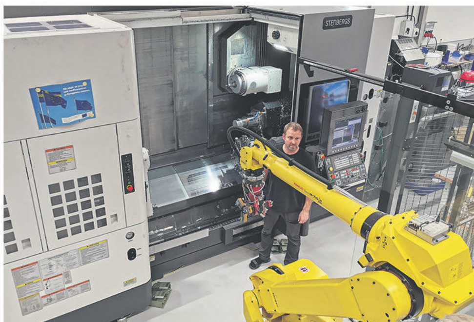
Tomas Danielsson vid Danielsson Innovation's mycket välspecade och högpresterande OKUMA Multus U 3000, betjänad av en robotcell från Marab
