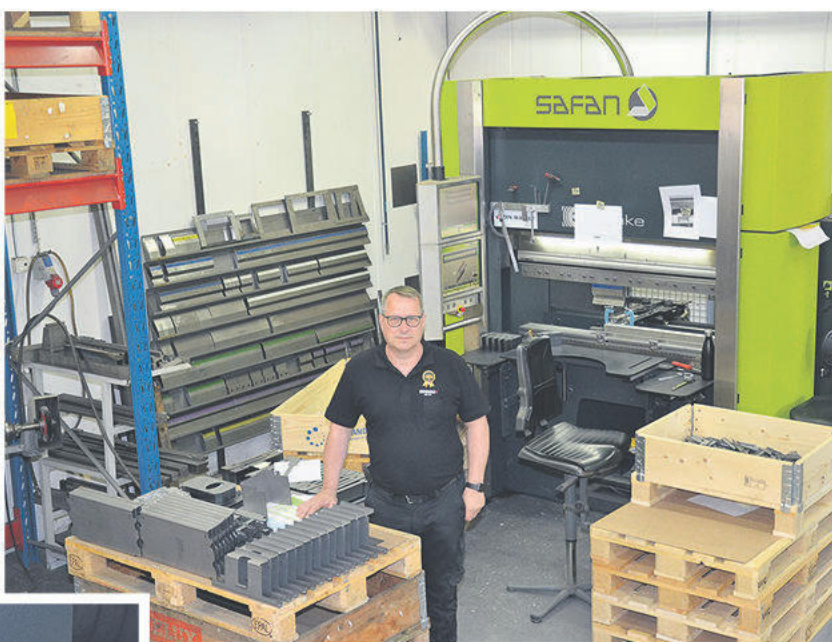
2015 investerade företaget i en E-Brake kantpress med mycket kraft, 80 ton, och möjlighet att leverera detaljer på upp till 2,5 meter med hög kvalitet. En maskin som Per Thydén har kört mycket.
