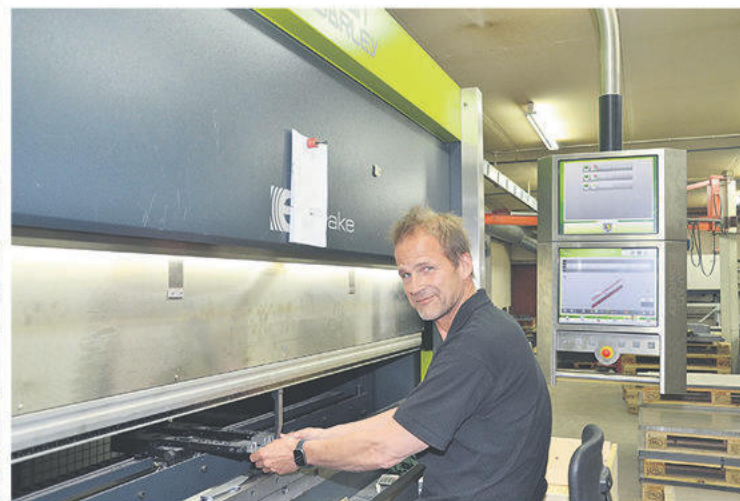
2015 investerade företaget i en E-Brake kantpress med mycket kraft, 80 ton, och möjlighet att leverera detaljer på upp till 2,5 meter med hög kvalitet. En maskin som Per Thydén har kört mycket.
