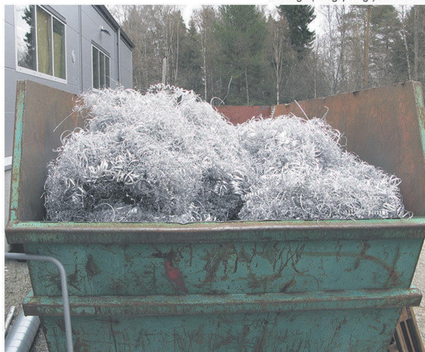
Inte en helt ovanlig syn vid bearbetning i ("långspånig") aluminium
