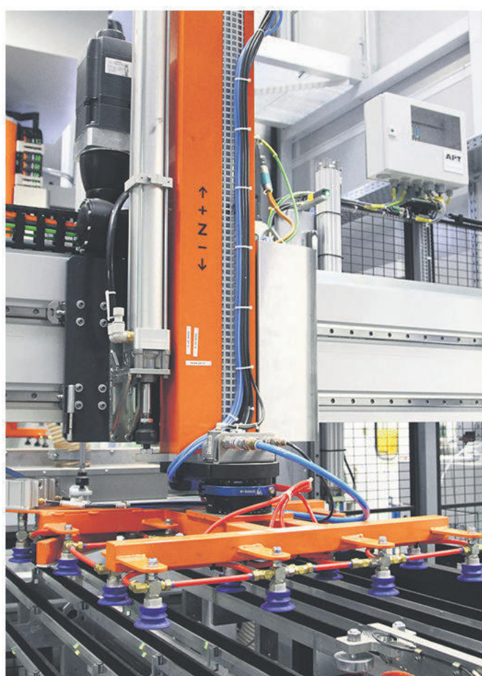
Tandemlinjens automationsutrustning består av pressrobotar från AP&T:s SpeedFeeder-program.
