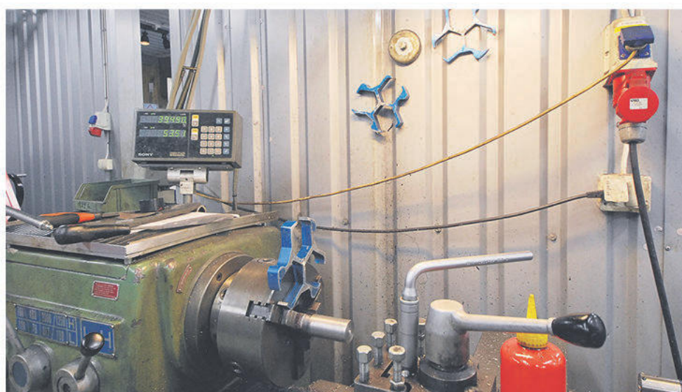
På väggen fångade fotografen en klassisk produkt, PosiStop som är ett materialanslag för svarvchuckar. Ersätter alla former av distanser som vanligen används vid svarvning av korta arbetsstycken för att undvika kast. PosiStop ersätter mjuka backar vilket kraftigt reducerar riggningstiden.
