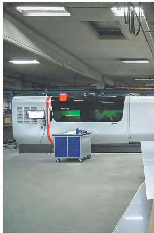
Rejåla rostfria plåtar laddas in i fiberlasern.
