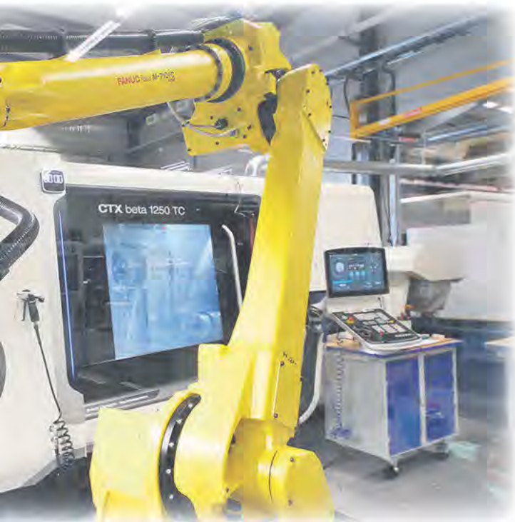
Stor investering – DMG MORI CTX beta 1250 TC med robot och komplett automationslösning. Konceptet kännetecknas av färdig detalj i en uppspanning. Obemannad bearbetning, i princip dygnets alla timmar. Övervakning av verktyg, kvalitetsmätning, material in -färdig detalj ut, packning och leverans till slutkund.
