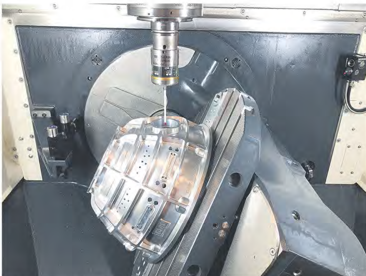
Detaljens storleksmässiga korrekthet kontrolleras automatiskt under tillverkningen. Därigenom verifieras bearbetningen fullständigt innan arbetsstycket lossas. (Bild: Renishaw GmbH)
