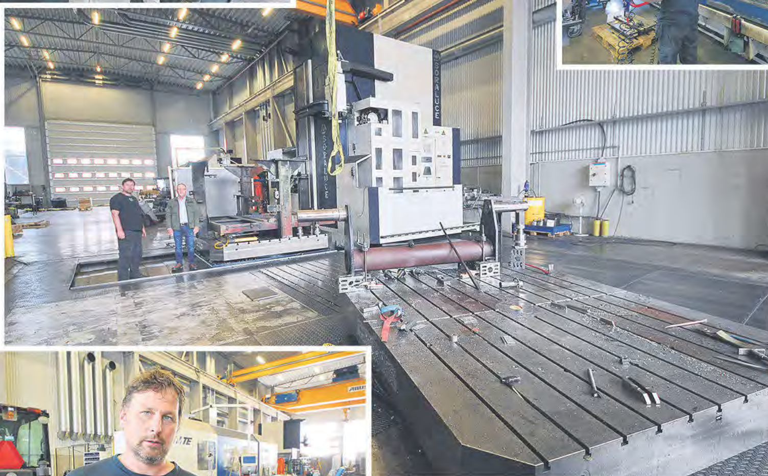
Fräswerket SORALUCE FR-12000. Maskinen är utrustad med två rundmatningsbord på vardera 60 tons lastkapacitet. Maskinen har ett magasin med 80 verktygsplatser.
