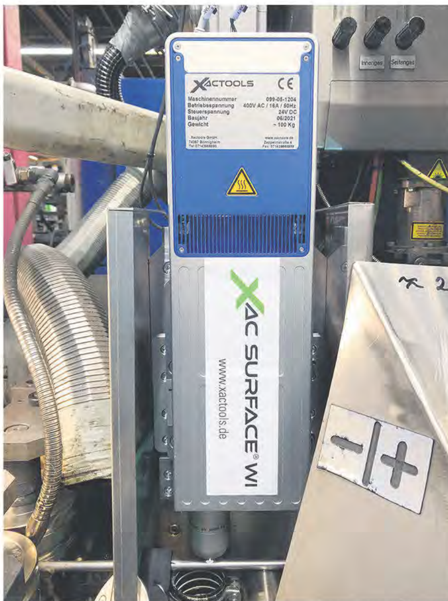
CAD ritning och bilder av integrerade XAC SURFACE WI plattformen för att kvalitets-äkra lasersvetsöms inline av rostfria stålrör
