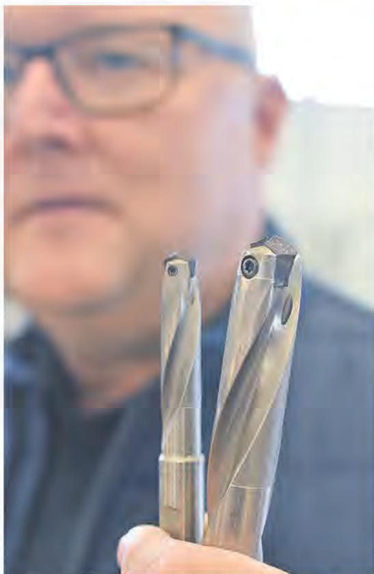
Många hål som borrar över diameter 11,0 så använder Svartvik Gührings HT800 med lösa skär. Borrarverktögen finns mellan 1,5 – 10xD.
