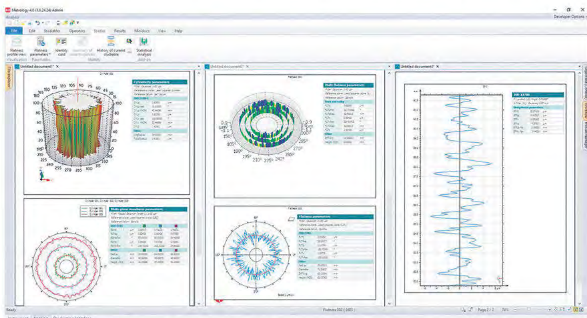
Utvärdering av cylindricitet, rundhet, planhet och rakhet. Allt i samma mätprogram och mätprotokoll.
