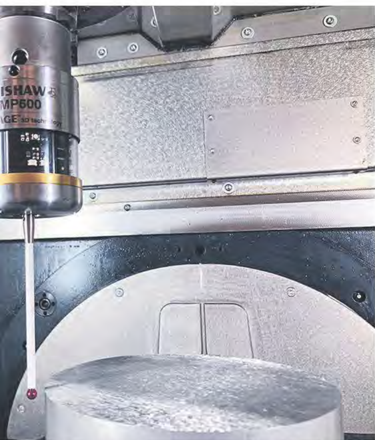
Om ämnet kontrolleras automatiskt för korrekt storlek och uppriktning före bearbetningen kan vanliga felkällor i tillverkningen undvikas. (Bild: Renishaw GmbH)
