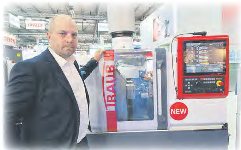
Mässpremiär för TRAUB TNL20-9B som kan tack vare en B-axel i övre revolvern bearbeta komplexa detaljer och konturer med fräsning, bormning, tvärbormning eller tvärgångning under valfri ingreppsvinkel, utan behov av vinkelhållare.
