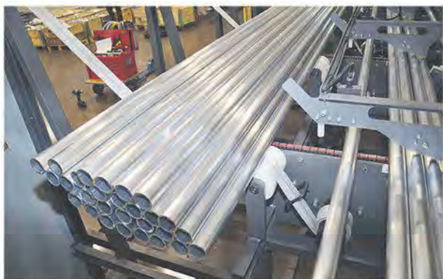
Stångarna kan fyllas på utan att avbryta produktionen, och själv laddelen finns i längderna 6,5, 8,5 och 12,5 meter.
