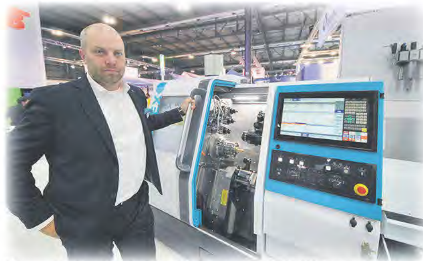
Mässpremiär; En helt ny CNC-styrd Universalvärv INDEX B400. En maskin för kortserieproduktion optimerad för operatören med snabb riggning och optimal ergonomisk lättillgänglighet. Med W-spår i verktygsrevolvern som standard och en 45-gradig bädd av mineralgjutgods ger högprecis bearbetning med minimalt slitage av verktyg. Utrustad med remdriven momentstark spindelmotor, verktygsrevolver med linjär Y-axel, och NC-styrd dubbdocka. Siemens Sinumerik 840D SL med en 18,5 " Touch-Monitor och INDEX Xpanel 4.0.
