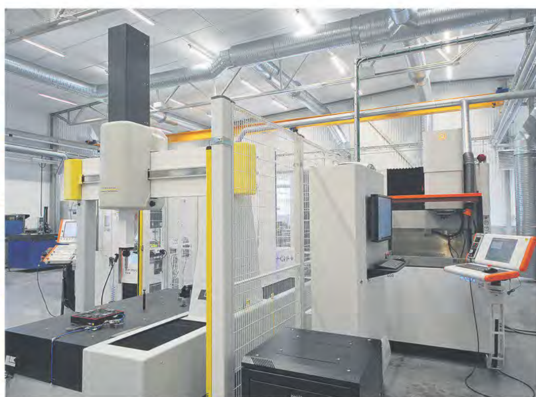
Till höger sänkgnist GF Form X 400. Rörelse i X Y Z = 400 x 300 x 350 mm. Ytfinhet ner till = 0,08 Ra. Generator 80 A (option 140 A). Och till vänster ser vi den helt integrerade mätmaskinen LK V-HA (High Accuracy) som är helt automatiserad och kommunicerar direkt med fräsmaskinen och sänkgnist.
