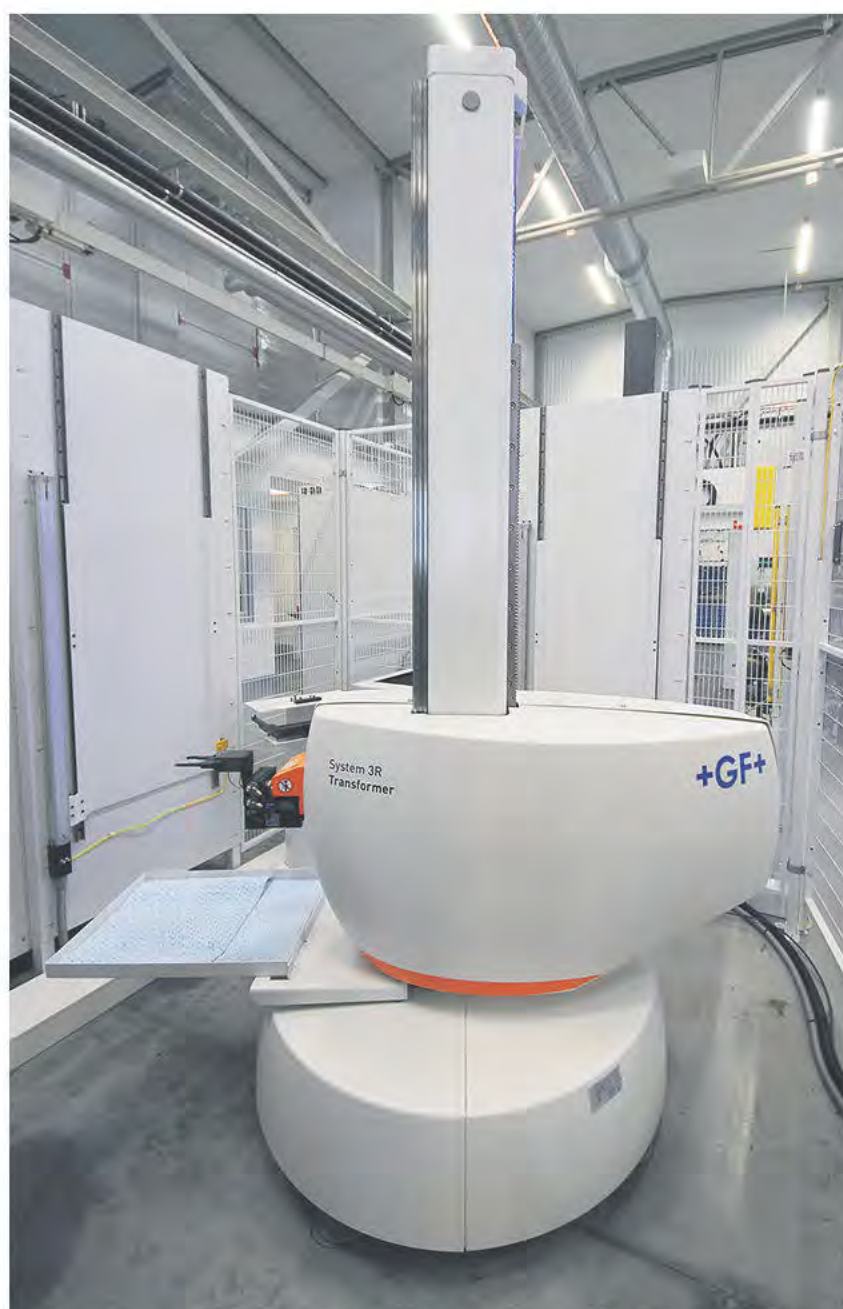
Robotautomation från GF System 3R modell Workmaster Transformer 1250/150. Rackmagasin för hantering av 5 paletter för arbetsstycke och rotationsmagasin för hantering av elektroder (5 X 36, dvs totalt 180 elektroder).
