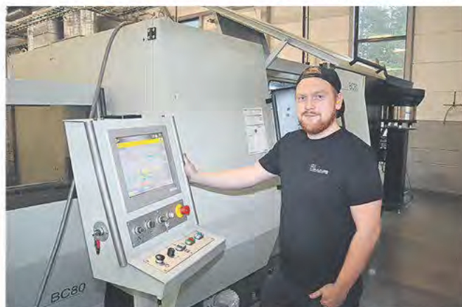
Operatör Oscar Malmlof är nöjd med nya kapen Adige BC80 från BLM Group. Kapen kan utrustas med sågblad med diameter mellan 275 och 360 millimeter.
