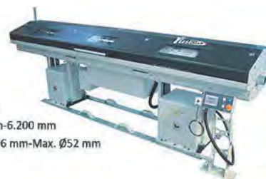
INFINITY Diameter skift: 60 sek. Stånglängder: 200 mm-6.200 mm Stångdiameter: Min. Ø3 mm-Max. Ø35 mm
