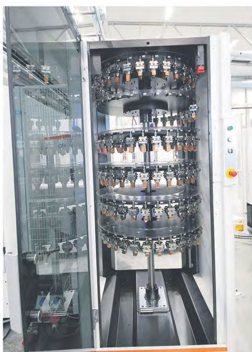
Robotautomation från GF System 3R modell Workmaster Transformer 1250/150. Rackmagasin för hantering av 5 paletter för arbetsstycke och rotationsmagasin för hantering av elektroder (5 X 36, dvs totalt 180 elektroder).
