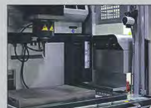
Stor arbetstank med 3-sidig tankdörr
