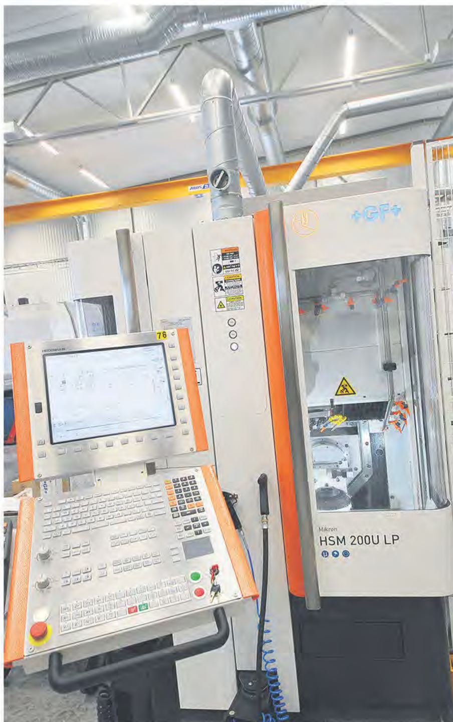
Höghastighetsfräsmaskin GF MILL S 200 U. Rörelse i X Y Z = 160 x 160 x 200 mm. Varvtal 50 000 rpm. Stativ i polymerbetong. Positionering noggrannhet 4 µm, repeterings noggrannhet 2 µm (enligt ISO 230-2 97).
