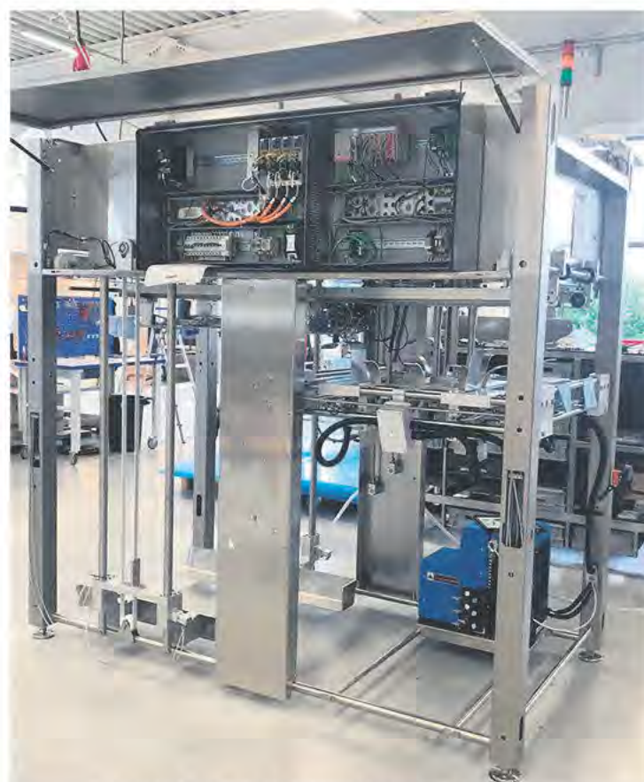
Exempel på en förpackningsenhet som kallas för trågresare. Den består i huvudsak av rostfritt stål med laserskurna, bockade, frästa och svarvade tillverkningskomponenter.
