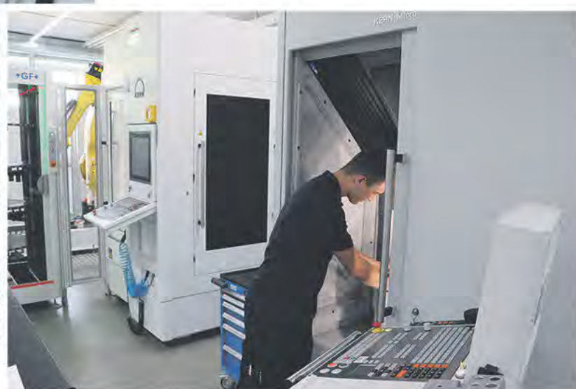
Sedan W&K år 2020 tog Kern Micro HD i drift bestyckar mekanikern Sascha Hämmerli Kern Micro manuellt för precisionsfräsning. Det gör att plasttillverkningsföretaget kan reagera snabbt och flexibelt på alla behov.
