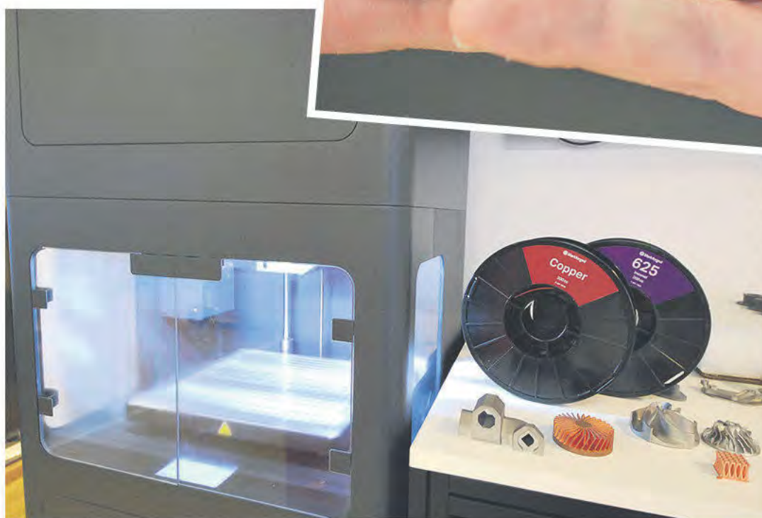
Skrivaren Metal X från Markforged med exempel på några av materialen som finns tillgängliga för systemet; koppar och inconel.
