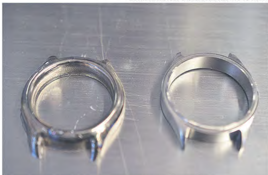
På bilden ser vi en boett (klockdelar) före och efter bearbetning/polering - Materialet är Titan och varje boett tog 56 min att skriva ut. Den totala kostnaden för utskrift per boett landar på ca 120 SEK (inkluderat material, gas och elförbrukning). Med argon i flytande form ca 50 SEK. En stor fördel i applikationer som denna är självklart att man slipper en stor del restmaterial från bearbetning. Boetten behövdes endast bearbetas ned ca 0.5mm
