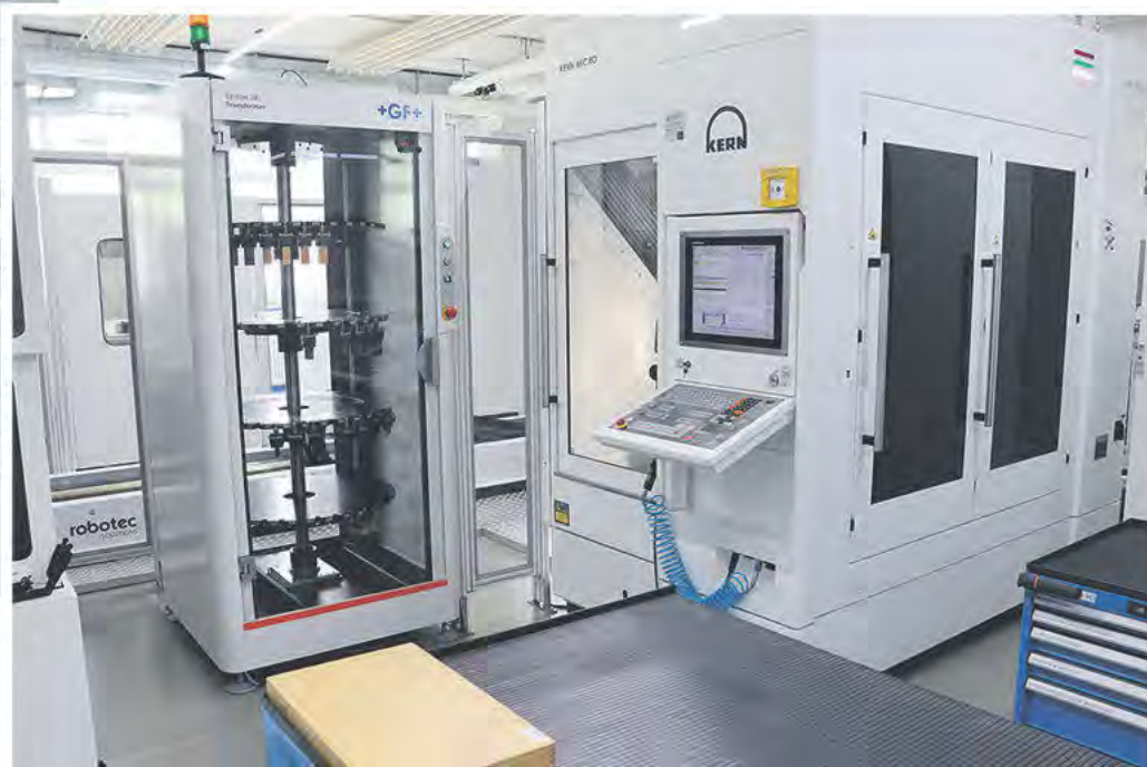
Garanter för högsta kvalitet och produktivitet inom verktygstillverkningen hos Wild & Küpfer AG: Den helautomatiska Kern Micro HD (nere till vänster B01b) och Kern Micro (nere till höger B01c). Den senare byggde Kerns tekniker om från torr- till våtbearbetning på bara några dagar. Bilder: Kern Microtechnik GmbH
