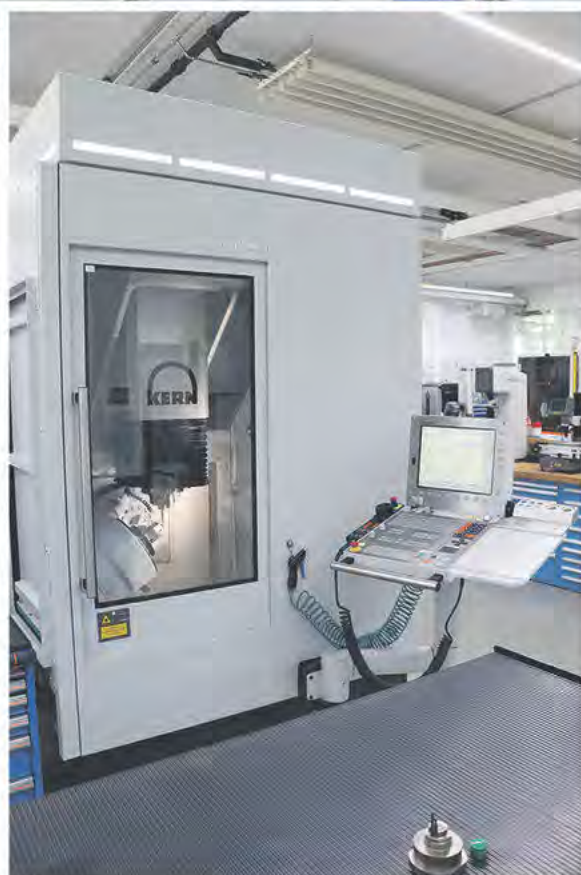
Garanter för högsta kvalitet och produktivitet inom verktygstillverkningen hos Wild & Küpfer AG: Den helautomatiska Kern Micro HD (nere till vänster B01b) och Kern Micro (nere till höger B01c). Den senare byggde Kerns tekniker om från torr- till våtbearbetning på bara några dagar. Bilder: Kern Microtechnik GmbH
