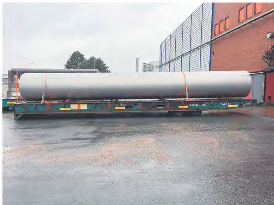
Rostfri valskropp som kommer tillverkas i maskinen.
