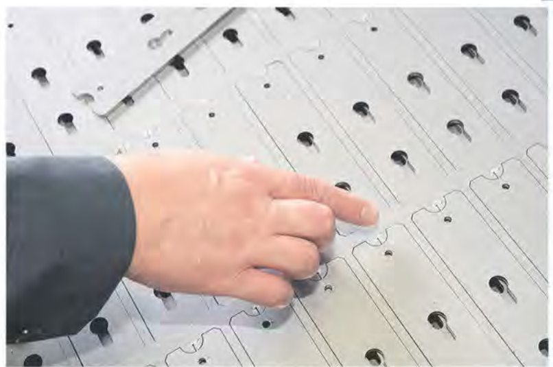
Tack vare effektiv kylning kan bitarna läggas ut tätare och därmed minska onödigt spill – vilket är extra värdefullt i tider när materialpriserna skenar.
