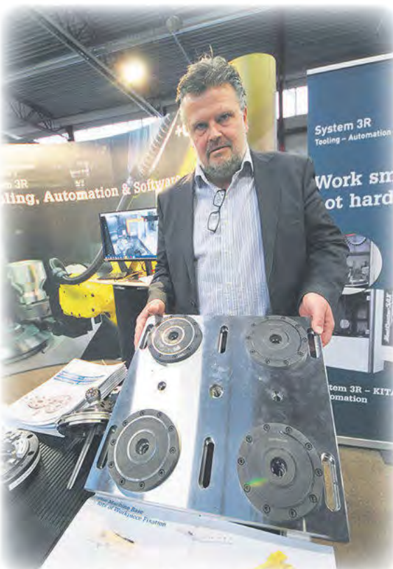
Per Nilsson GF System 3R visade bl.a chuck och palett med referenssystem som minimerar inställnings tider.
