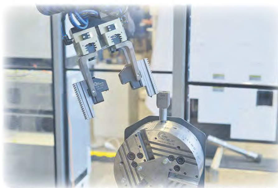
På Stenbergs visade man upp en robotcell tillsammans med ABB och SMW-Autoblok. Chucken som är en KNCS-Matic är anpassad för att kunna byta backar med robotarm, för att kunna växla mellan olika jobb och köra mer obemannat. KNCS-Matic finns som standard i storlek upp till 630 mm.
