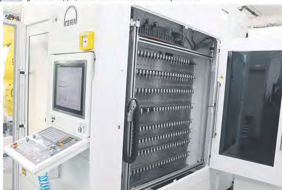
Mekanikern Sascha Hämmerli behöver bara mata in några få kommandon på den helautomatiserade Kern Micro HD för att den ska producera felfria komponenter i serie – elektroder i grafit eller koppar, liksom kärnor i hårdmetall och mycket mer.
