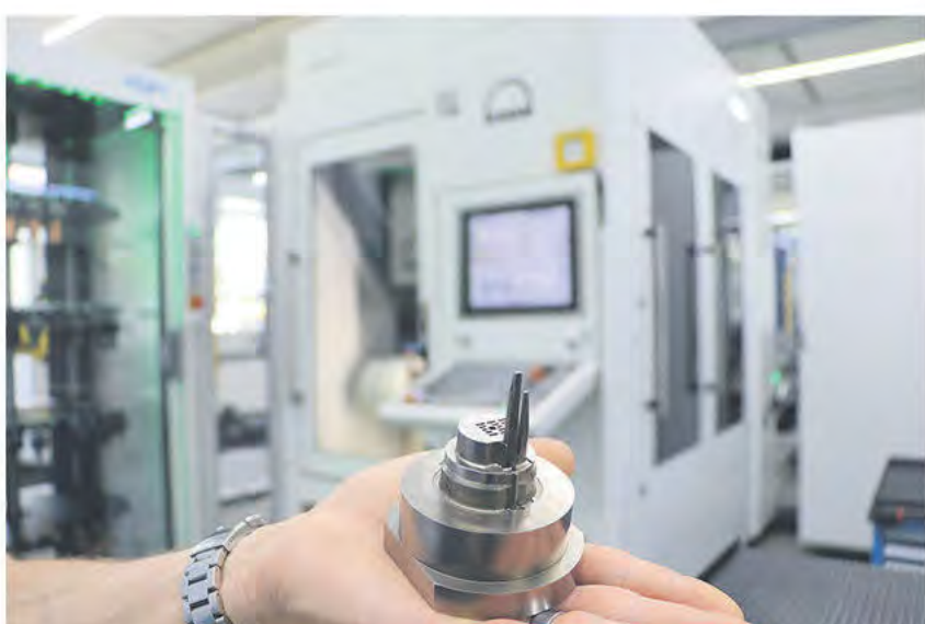
Exempel på resultat: Verktyg som frästs på Kern Micro HD och de W&K-plastkomponenter som tillverkats.
