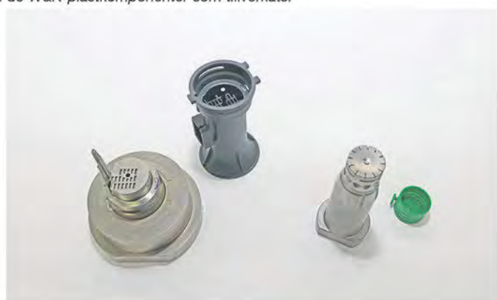
Exempel på resultat: Verktyg som frästs på Kern Micro HD och de W&K-plastkomponenter som tillverkats.
