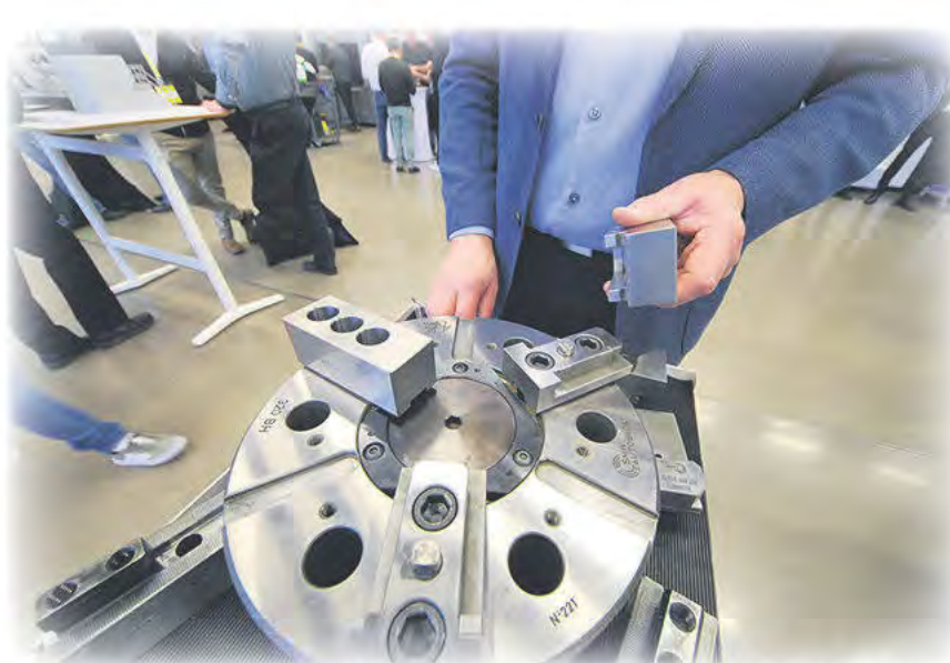
En nyhet som presenterades på MID 2021, var SMW-Autobloks RR-Kit. Ett kit som omvandlar helt vanliga chucks med tanddelade grundbackar till snabbväxlings-chuckar. Med ett enkelt tryck och handgrepp byter man överbackar på minsta möjliga tid.
