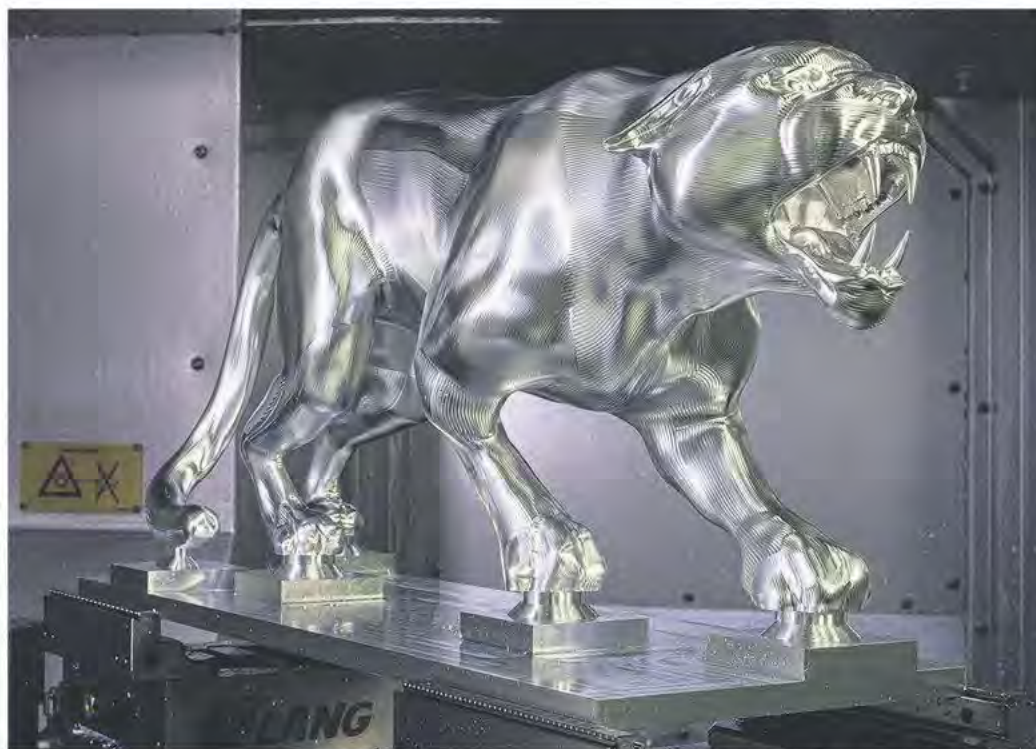
Pantern, som är ungefär 500 mm lång, har maskinbearbetats ur ett aluminiumstycke på precis under 13 timmar.
