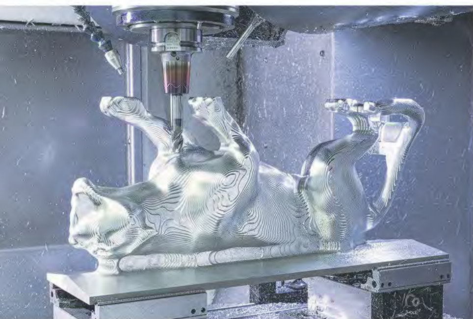
Designerna använde det modulära Haimer verktygssystemet för grovslipning. Systemet består av karbidverktygshuvuden som är anslutna till olika förlängningar via ett extremt stabilt gränssnitt.
