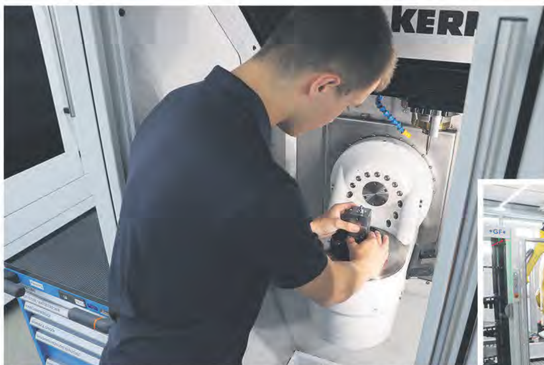
Sedan W&K år 2020 tog Kern Micro HD i drift bestyckar mekanikern Sascha Hämmerli Kern Micro manuellt för precisionsfräsning. Det gör att plasttillverkningsföretaget kan reagera snabbt och flexibelt på alla behov.
