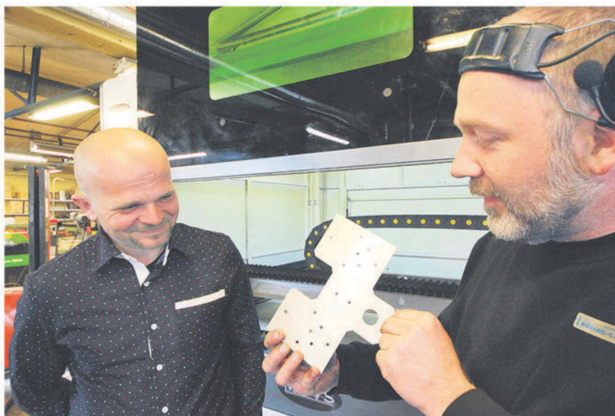
Ivan och Gunnar studerar skärresultatet. Hål och kanter i plåten blir skarpa och exakta utan grader så här behövs ingen efterbearbetning.
