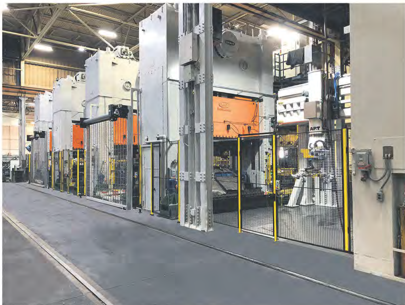
AP&T fick uppdraget att helautomatisera en befintlig fempresslinje hos Spartanburg Steel Products Inc.
