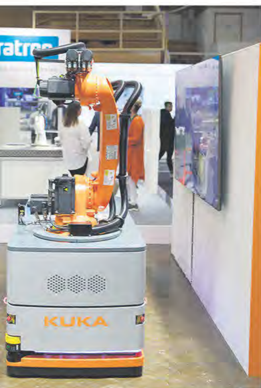
KUKA KMR CyberTech tar sig fram helt oberoende tack vare sensorer på sidorna som gör att den stannar om något kommer i vägen för den.
