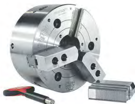
QJR- Snabbväxelchuck Snabbväxlande, 254 mm, 3-backig kraftchuck med genomgång. Passar Kitagawas standardbackar.
