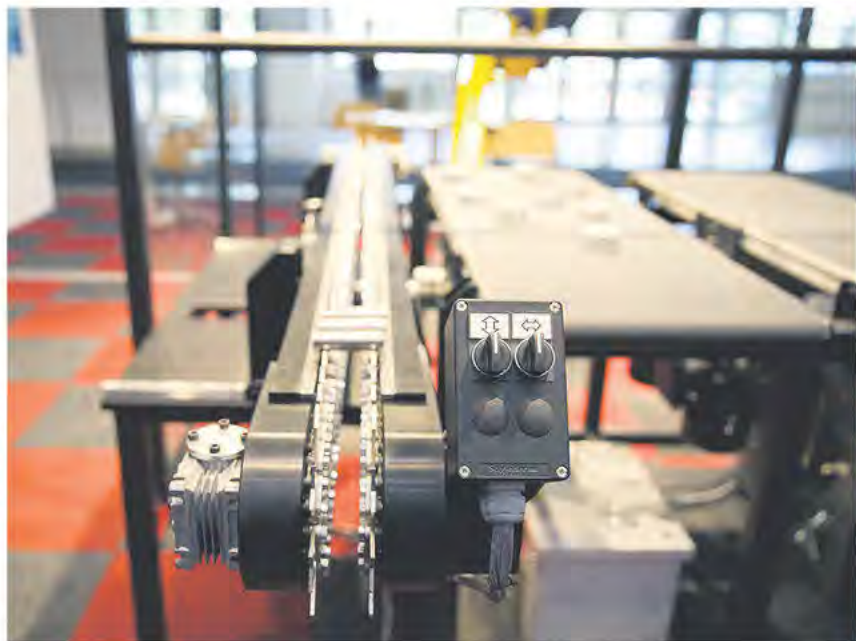
Axlarna transporteras in i cellen med hjälp av axeltransportören från Marab och därefter tar en robot vid för att plocka detaljer utifrån valfri programmering. Allt går att kombineras med transportbanor och visionsystem vid behov.
