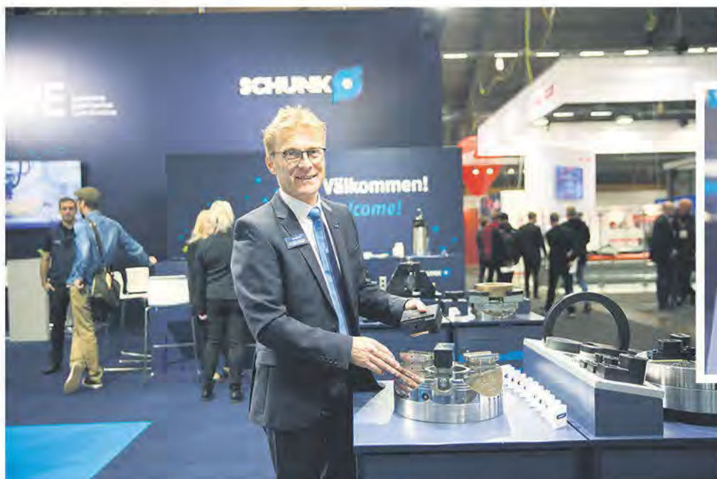
Rapido, som här demonstreras av Roger Cronholm från Schunk, var en av flera produktnyheter som Schunk visade på Elmia Automation. Med Rapido häktas svarvbackarna enkelt av och på svarvchucken med hjälp av en robot.
