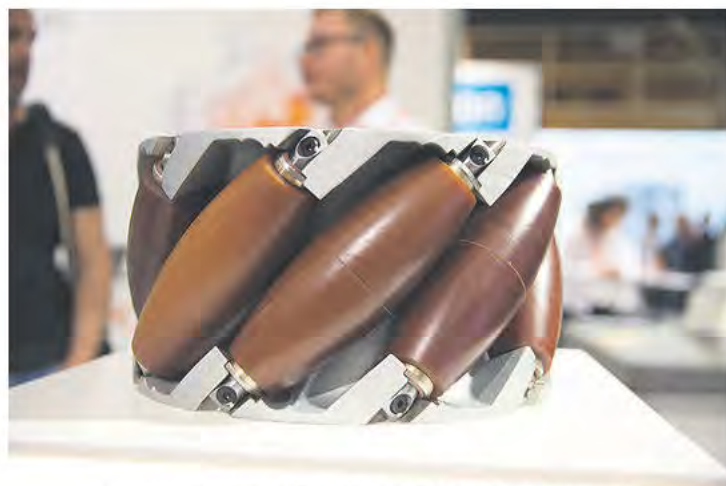
De speciella hjulen på KUKA KMR CyberTech gör att den kan köra i alla riktningar och även vända runt sig egna axel.
