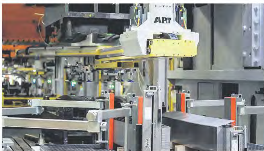
Totalt installerade AP&T sex stycken SpeedFeeders för ämnesmatning, förflyttning av delar mellan de fem pressarna, samt utmatning.
