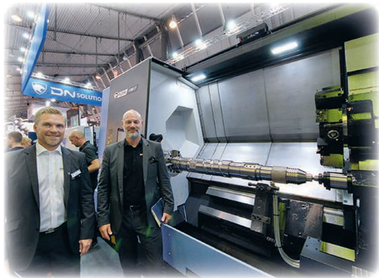
Duroc machinetools Håkan Conradsson och Robert Puekker framför storsäljaren i Svealand PUMA5100LY med Drivna verktyg, Yaxel och en max arbetsområde på dia 550 mm och 2050mm lång.
