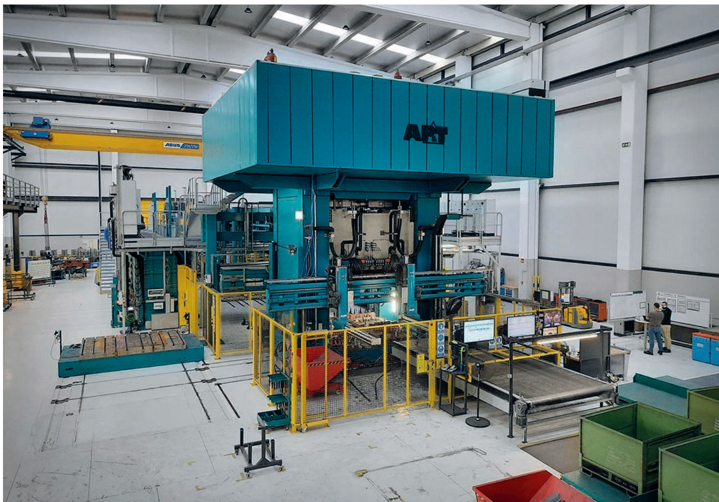
Den största tekniska utmaningen var att förena två nya innovationer – AP&T:s servohydrauliska press och TemperBox® i samma produktionslinje. Foto: GEDIA.
