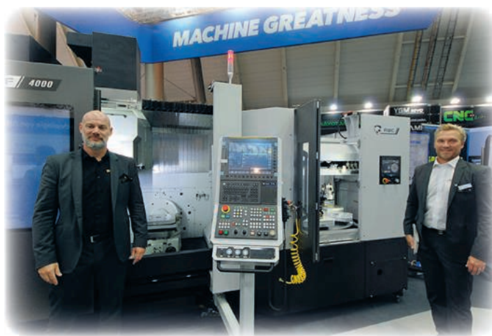
På AMB Premiärvisades nya utökningen i femaxliga familjen DVF, med DVF4000, här ihop med AWC (automatic work changer) med 8 paletter.
