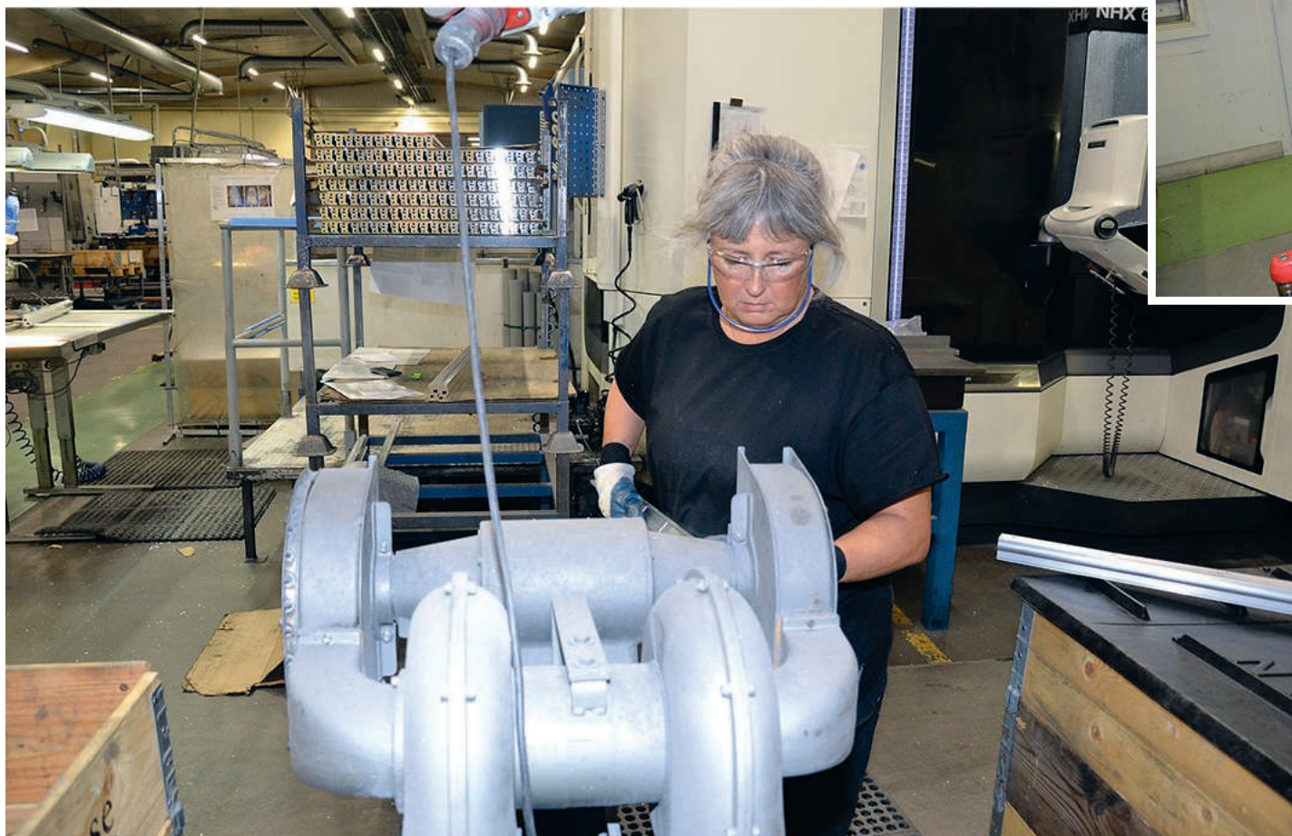
Bränslelisterna som körs i Matsuura H.Plus-630 skickas iväg för blästring och kommer sedan tillbaka för avsyning och kontroll, tvättning, efterkontroll, och förmontering i renrummet.
