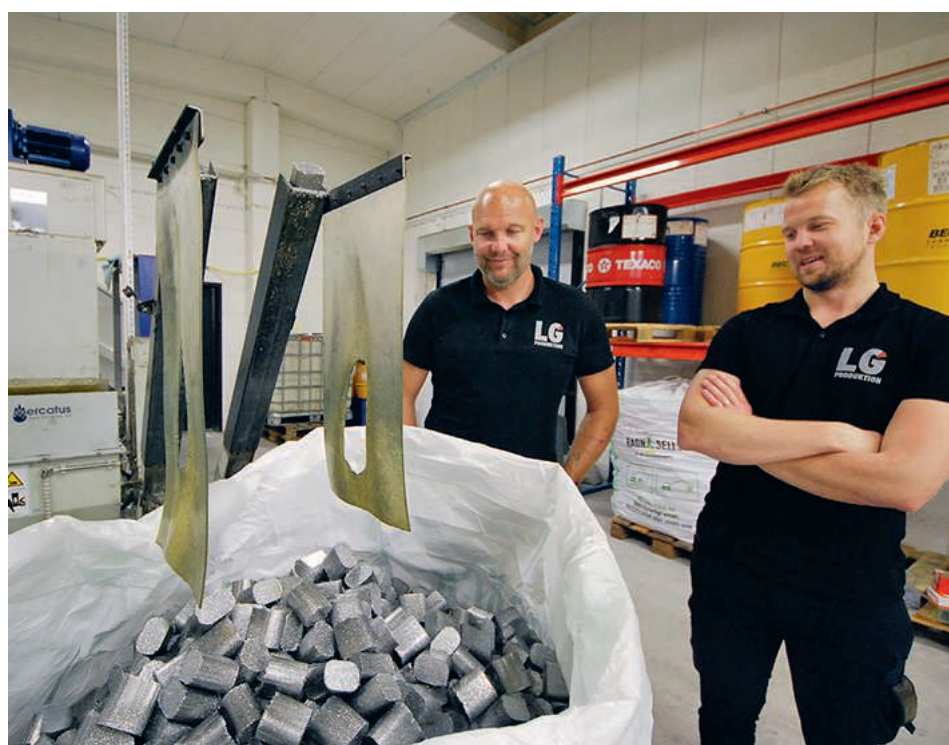
Hållbarhet är viktigt idag och det finns mycket ekonomi i att ta hand om spånorna på bästa sätt. Här på LG Produktion har man en flexibel lösning för brikettering av spånavfall.
