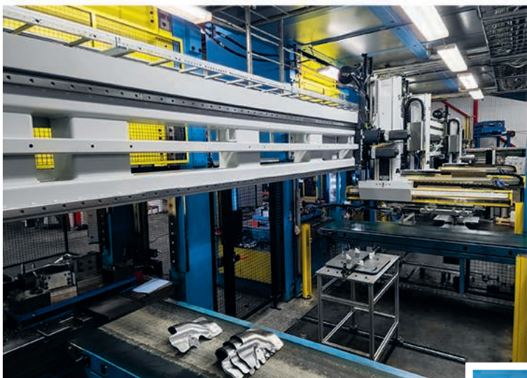
Hög produktionskapacitet. I den helautomatiska presslinjen tillverkas chassi- och karossdelar till tunga lastbilar. Uppgraderingen har ökat produktionskapaciteten med ca 500 timmar/år.
