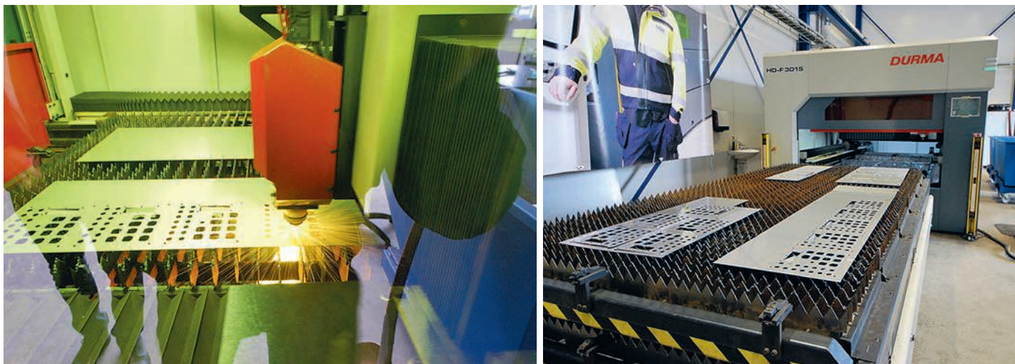
DURMA HD-F 3015 III – 8 kW fiberlaser är utrustad med växelbord för effektiv skärning i både tunn och tjock plåt.
