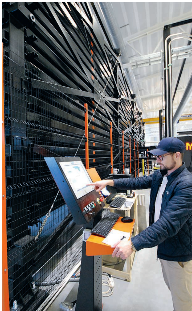
FMS med 147 paletter för lagring av plåt.
