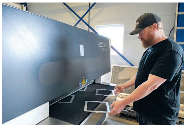
Martin visar upp resultatet efter avgradning. Fördelar med gradning, skapar bättre förutsättningar för pulver-, våtlackering och galvanisering. Minskar skaderiskerna på grund av vassa kanter. Tar bort oxid efter laserskärning i stålplåt. Bryter kanter efter skärning och skapar dekorativ ytfinish med slipning och polering.
