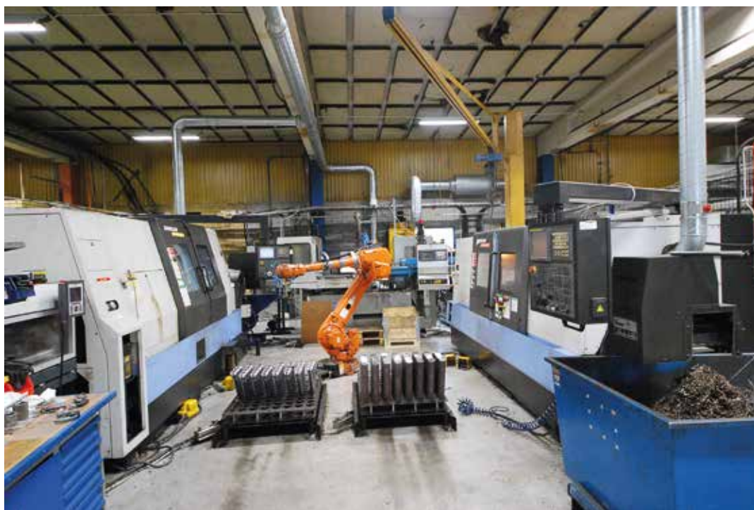
Automationslösning från 2010, som var den allra första (men inte sista) automationen hos FoBe. Vi ser en fleroptionsmaskin och en svarv från DNS.
