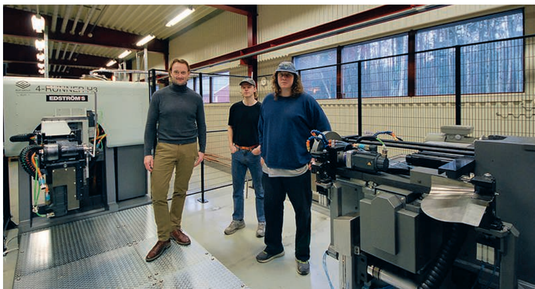
Jim Davis och grabbarna Johansson vid rörbockningsmaskinen BLM 4-Runner H3.
