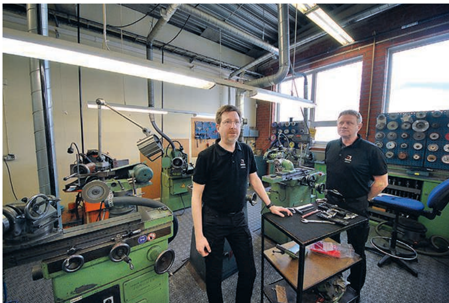
Konventionella slipmaskiner av märket Jungner (med rattar) på Beros står fortfarande i rader som kontrast till den allra senaste CNC maskintekniken.
