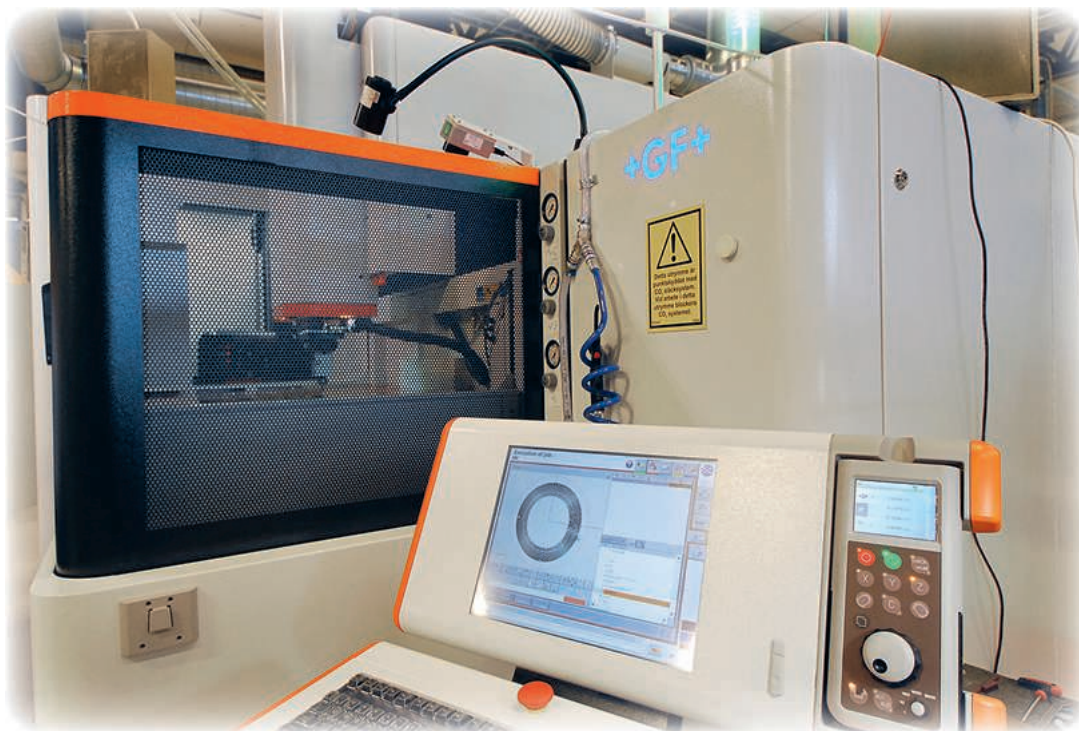
Programvaran är enkelt uppbyggd så att man via dialogrutor snabbt kommer i gång med sitt jobb. På bilden syns även handkörnings boxen som gör det möjligt att säkert manuell-köra maskinen med hög precision.
