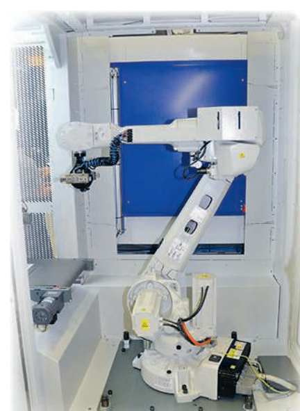
Robotcellen Feedio är speciellt framtagen för att matcha Brother-maskinen Speedio U500Xd1 och lämna ett så litet footprint.
