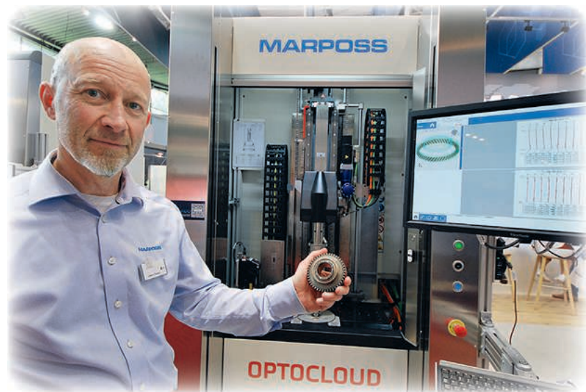
OptoCloud Gear är en revolutionerande 3D mätmaskin för till exempel kugghjul där mätningen sker beröringsfritt och skapar en modell av detaljen via ett punktmoln. Där kan man sedan utvärdera dimensioner, kuggvinklar mm på ett snabbt och noggrant sätt direkt i produktionen
