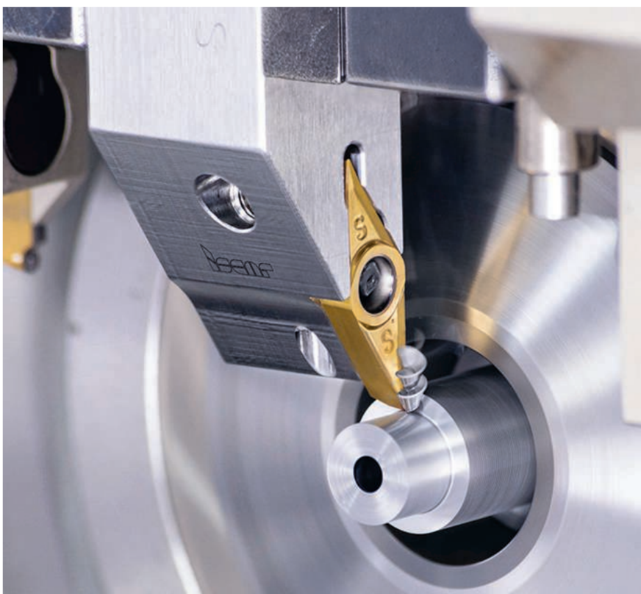
Bild 1 – Slipade och polerade ISO-standardiserade rombiska skär för effektiv svarvning av miniatyrdelar.
