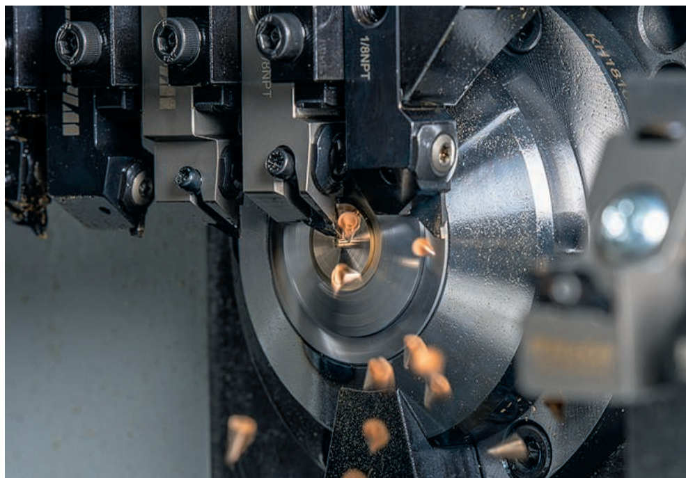
Ta bort mycket material. WhizCuts vändskär är utvecklade för stora skärdjup.
