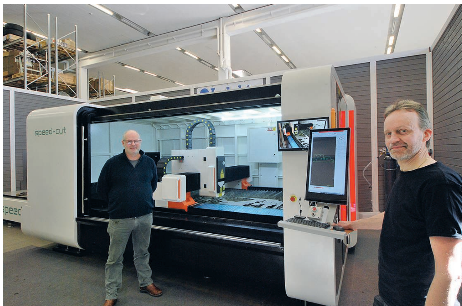
Anders Olsson och Joakim Svenning visar fiberlaserskär-maskinen Speed-Cut Fiberlaser 3015, IPG, Arbetsyta: 3000mm x 1500mm. Max hastighet: 140m/min. Max acceleration: 1.5G. 380V/50Hz/60Hz/60A.
