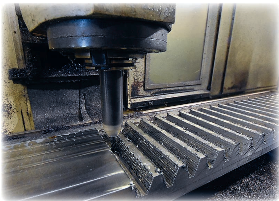
Tim, Björn och Per visar upp verktygslösningar för tillverkning av kilspår direkt i fleroptionsmaskinen.
