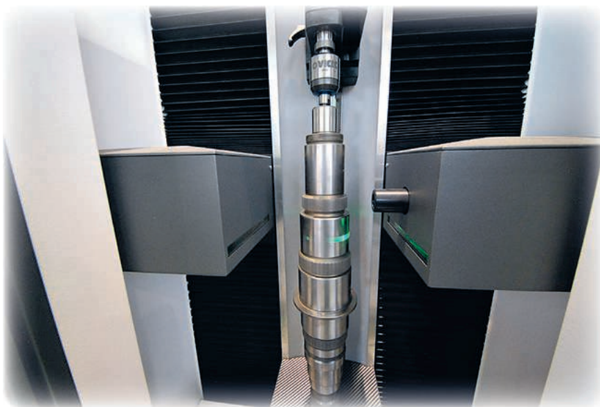
Axelscanner från VICIVISION utrustad med optik och confocal sensor för mätning av splines.
