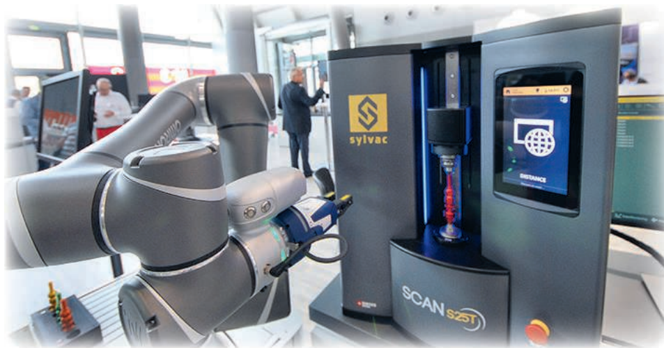
Den optiska axelmätmaskinen Sylvac Scan S25T är i grundutförande redan förberedd för automatisk laddning och mätning av artiklar, såsom många andra maskintyper av Sylvac.
