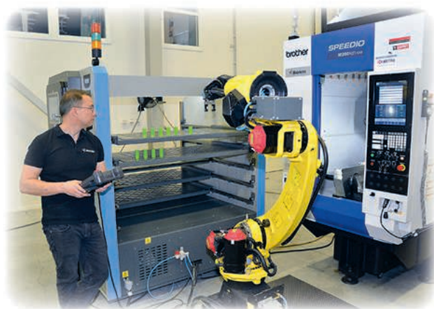
Automatiseringstekniker Daniel Gunnarsson programmerade roboten som samverkade med M200Xd1-5AX.
