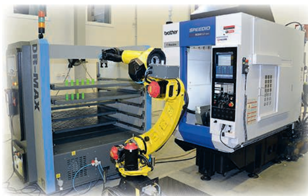
En robot samverkade och växlade bitar i M200Xd1-5AX
