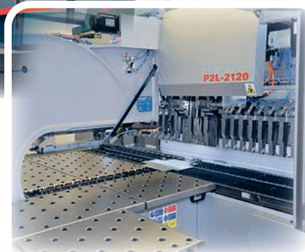
Panelbockningsmaskinen P2Lean-2120 kan producera i ett brett applikationsområde med universella verktyg.
