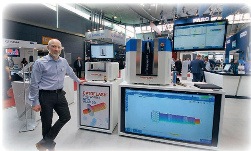
OptoFlash är en familj optiska mätmaskiner för axlar mm som har funnits sedan 2018.
