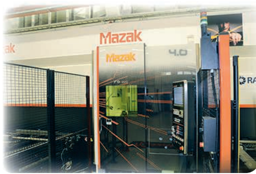
Störst i hallen var rörlasermaskinen Mazak FG-220 som kan ladda rör upp till sju meter och med en diameter på max 220 millimeter.
