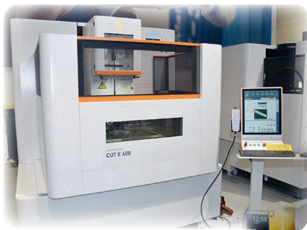
Trådnist AgieCharmilles CUT E 600 kännetecknas av hög flexibilitet och skärhastighet till en låg trådförbrukning och kostnad.
