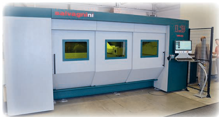
Salvagninis fiberlasermaskiner har hög automatiseringsgrad och låg energiåtgång. L3 är en komplett grundmaskin med ett enda optiskt huvud som kan skära olika tjocklekar med hög kvalitet.
