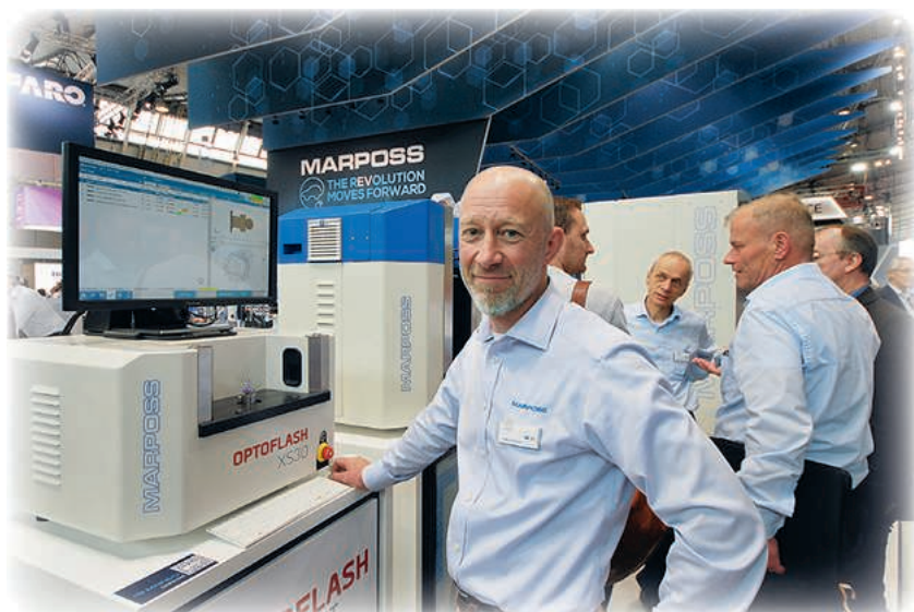
OptoFlash XS30-XS60, främsta applikationen för dessa är tandimplantat och skruvar mm, max längd på detaljerna är 30 respektive 60 mm och max diameter 20 mm.
