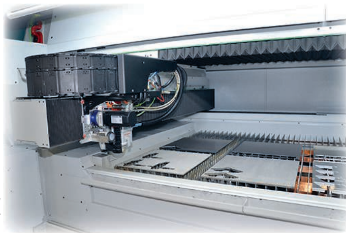
Salvagninis fiberlasermaskiner har hög automatiseringsgrad och låg energiåtgång. L3 är en komplett grundmaskin med ett enda optiskt huvud som kan skära olika tjocklekar med hög kvalitet.
