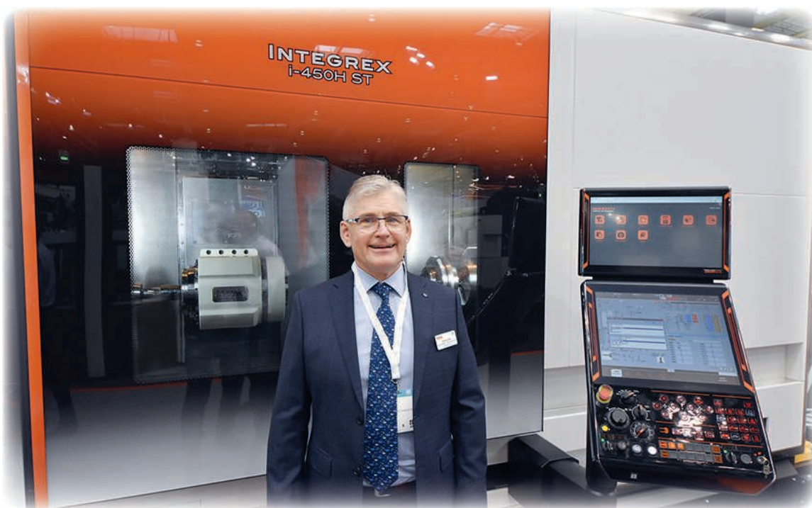
Integrex i 450 H ST den näst största maskinen i Mazaks i serie, maskinen på EMO mässan är en 2 spindlig Integrex med undre revolver. Maskinens framsida är helt plan för att enklare kunna automatiseras och framförallt med automation ge maskincellen en mindre fotprint. Verktygsmagasinet kan opereras både från framsidan och baksidan av maskinen. Maskinerna finns i många olika utföranden och maskinlängder. Maskinen på mässan har en svarvlängd på 1500 mm. men kan fås i längder upp till 2500 mm.
