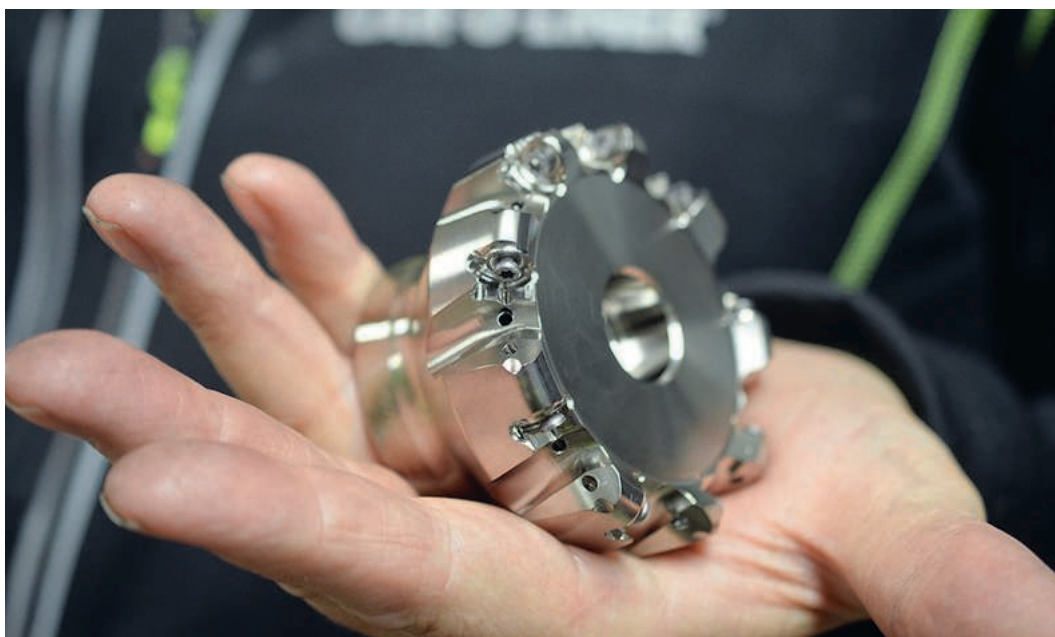
En "fräskrabba" från Mitsubishi 9-skärig hörnfräs WWX 400. Konvexa skärkanter på skären gör att spånorna inte kläms mellan skäret och den frästa ytan. Tandningen kan fås med 3 olika täthet på många av diametrarna.
