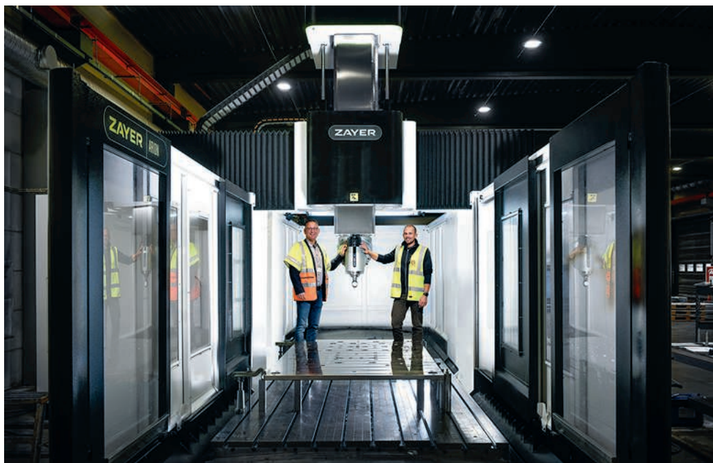
Utrymmet i Portalfräsen mellan portalerna där Anders Ernér, representanten från Lichron och Eurosteels tekniske chef Henrik Täck står är 2500 mm!
