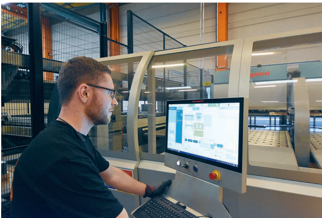
Maskinoperatör Rolf Berglund arbetar alltmer i data- och datormiljö. Modern produktion handlar alltmer om att inte röra plåten alls. Alla maskinens och robotens rörelser programmeras automatiskt och nya artiklar sätts i produktions kö, via off-line programmering.
