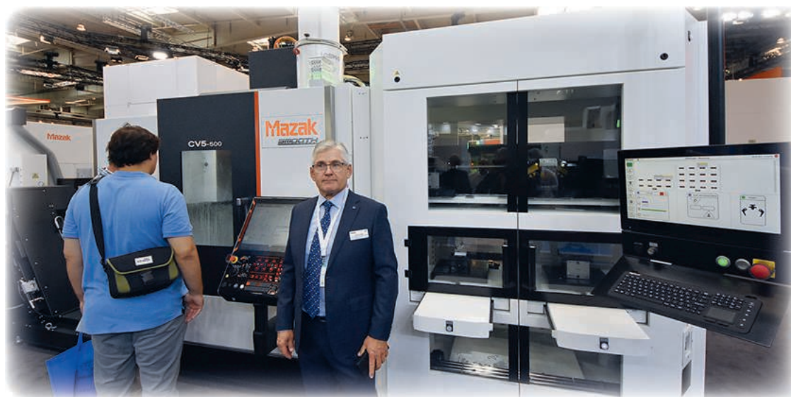
Mazak CV 5 500 vertikal fem axlig fleroperationsmaskin utrustad med robot för palettantering på maskinens högra sida med separat Ladd station. Och ett extra verktygsmagasin med plats för mer än + 200 verktygsplatser på maskinens vänstra sida. Mazak CV 5 500 kan hantera arbetsstycken upp till 500 mm i diameter och höjd 450 mm. Maskinen tillverkas på Mazaks Europa fabrik i Worcester.
