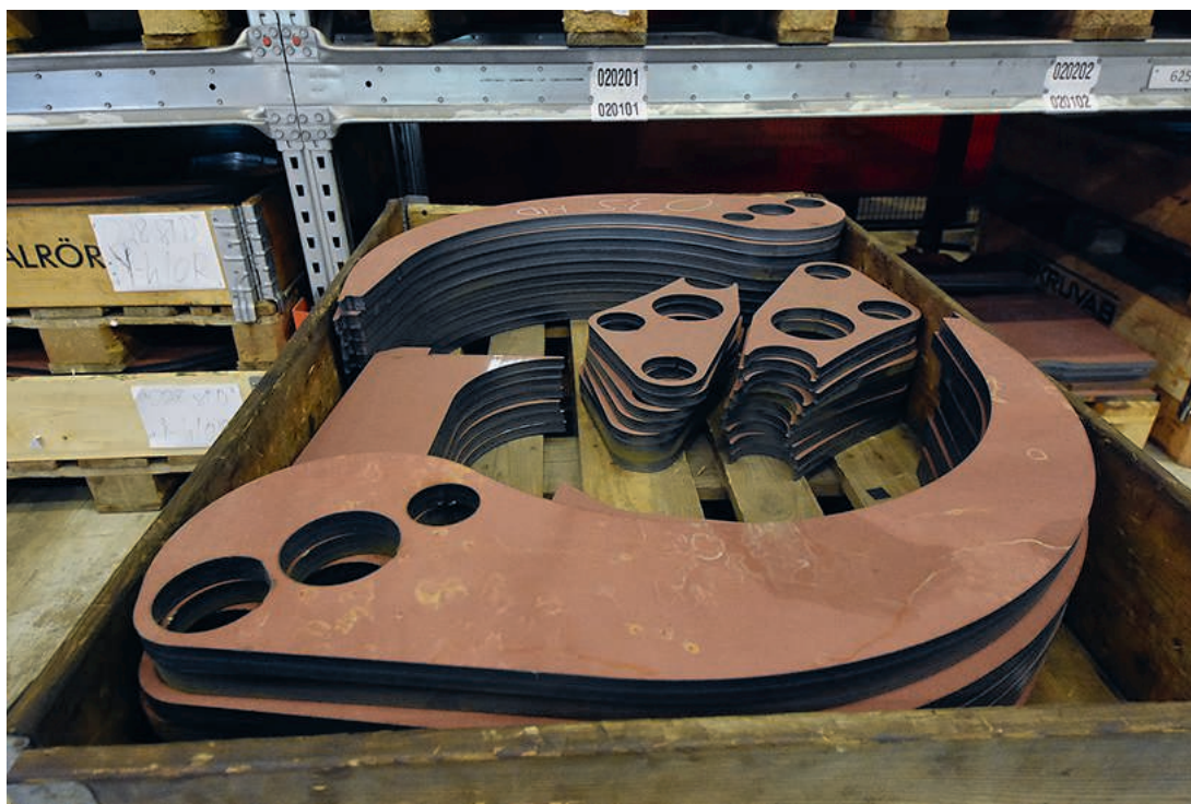
För att förstå vad den nya fiberlaserskärmaskinen skall klara av för uppgifter så kan vi titta på fotot. Det handlar om tjocka stålplåtar. Och man får ett perfekt skärresultat på hålbilder och kantskuret.
