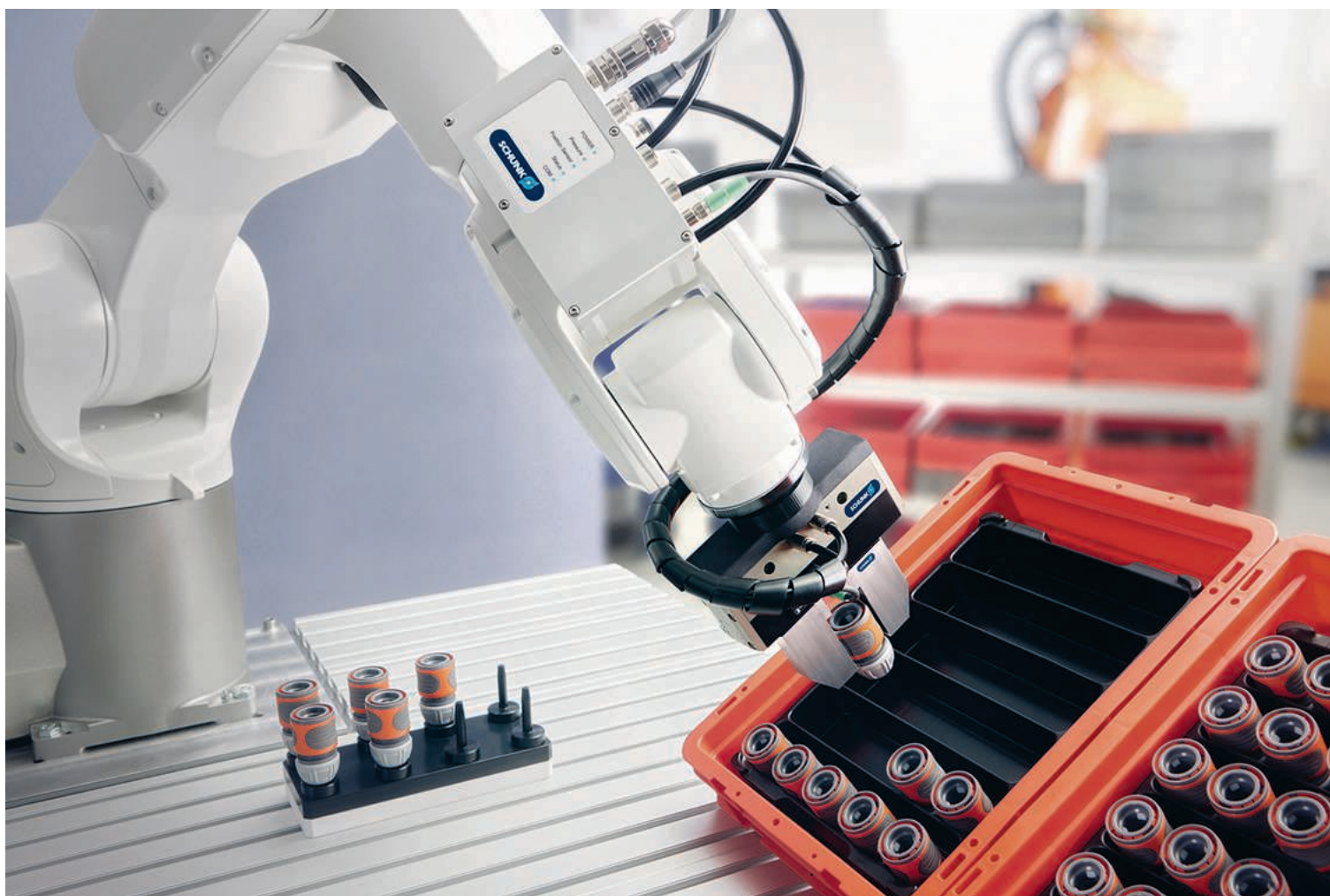
Kollisioner med tätt placerade arbetsstycken undviks eftersom gripfingrarna är förpositionerade med PPD. Bild: SCHUNK
