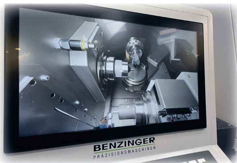
Nya Go Future B6 med dubbla spindlar samt B-axel och undre revolver.
