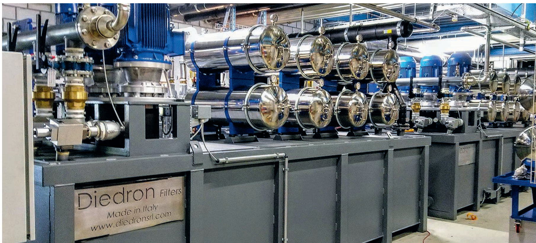
Clean Tower MTH 32 10 000 kapacitet med filtreringskapacitet upp till 1900 l/min.
