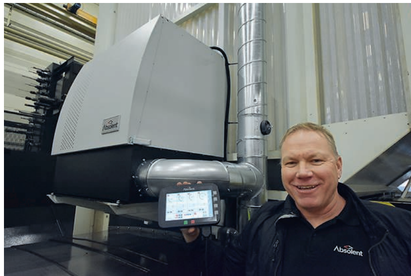
– A•Control är direkt sammankopplad med Absolents filterenhet och övervakar de aktuella och individuella tryckfallen på upp till fyra filtersteg, säger Michael Sandqvist
