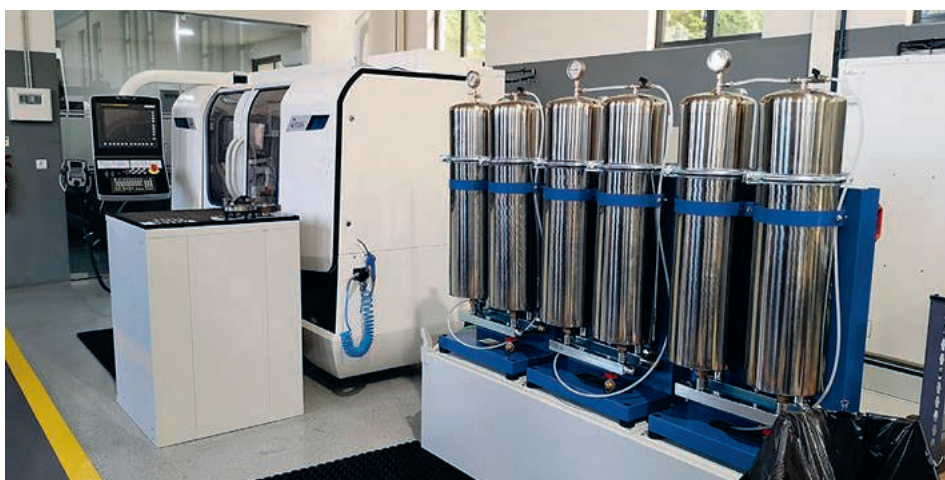
Clean Tower EFFE 12 2.000 med filtreringskapacitet upp till 450 l/min
