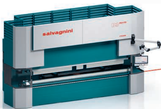
B3-AU-TO Kantpress med helautomatiskt verktygsbyte
