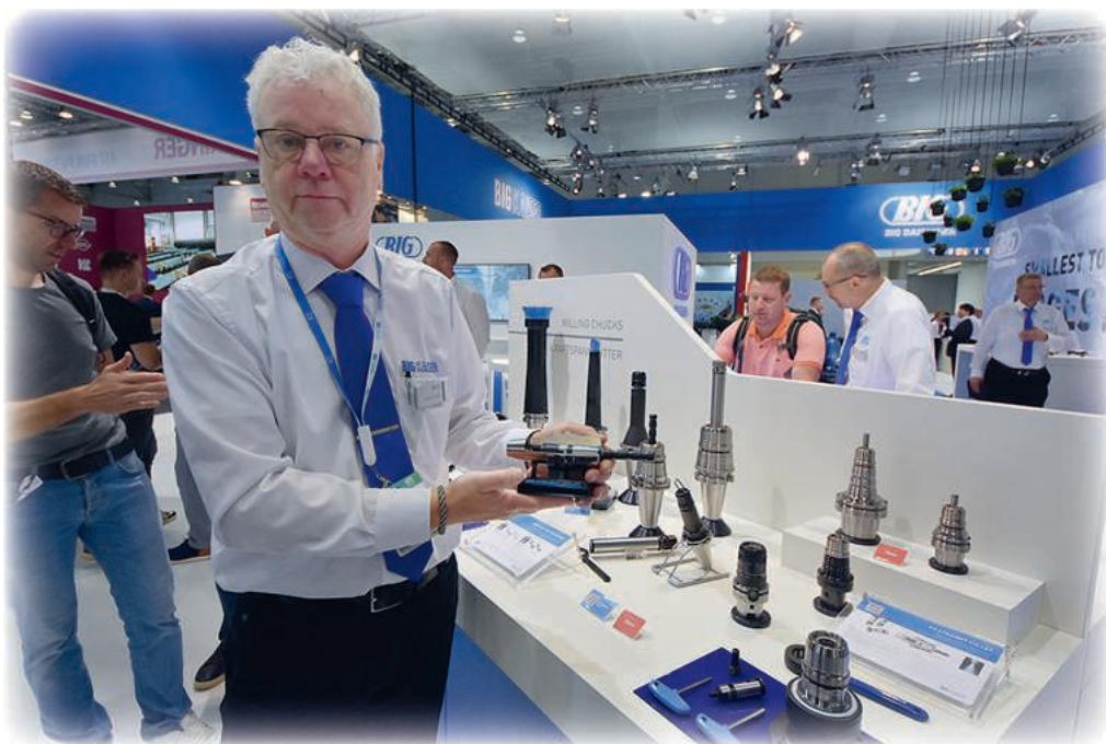
Perfekt Grip Hylsan förhindrar att verktygen kan dras ur, då fräschucken och hylsan blir ett sammansatt förband. Hylsan är konstruerad för att passa verktyg med Weldonskaft.
