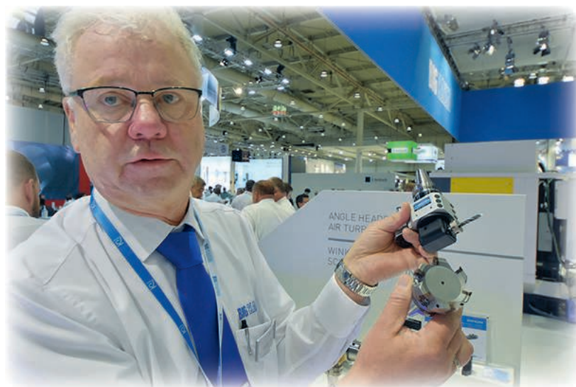
Perfekt Grip Hylsan förhindrar att verktygen kan dras ur, då fräschucken och hylsan blir ett sammansatt förband. Hylsan är konstruerad för att passa verktyg med Weldonskaft.
