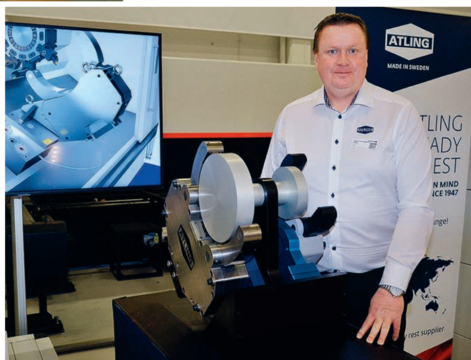
Anders Henningsson, som började som Sales & Business Development Manager vid Atling i september, presenterade företagets stöddockor för svarvar där alla produktserier har en greppvidd på 4 till 870 millimeter som standard.
