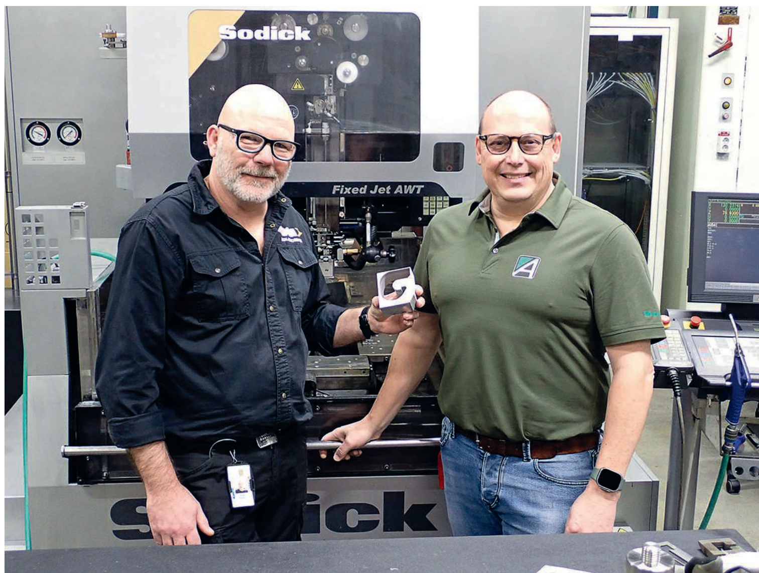
Roger Jansson och Klas Nordh. Bakom dem ser vi SODICK AQ400L som är en standardmaskin som jobbar med hög noggrannhet och tillsammans med linjärmotorerna i alla simultant styrda axlar.
