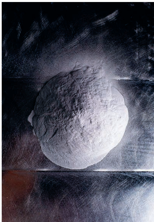
Stålpulver printat som en ihålig sfär med additiv tillverkning. Stålets egenskaper gör att bollen kan studsas utan att spricka. Foto: Hugo Leijon
