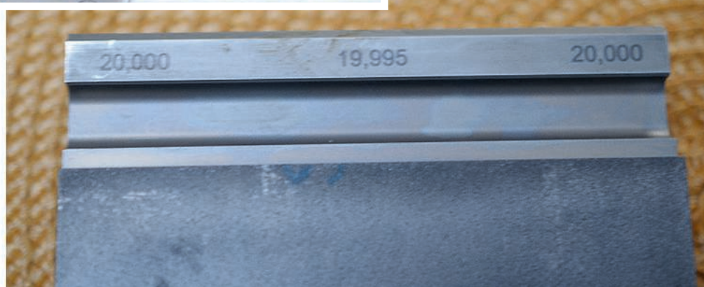
Testdetalj för kontroll av raket – Höjd 100 mm med midja inom 0,0025 mm per sida.
