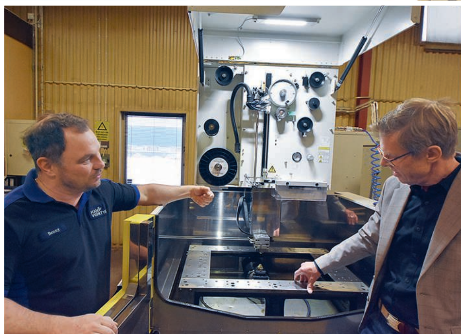
Jan-Anders visar hur god åtkomligheten är i maskinen. Man når lätt hela bordet genom öppningen i tankdörren.
