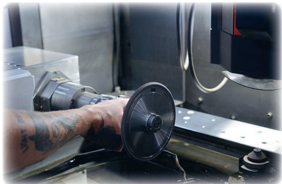
En slipskiva sätts in i B-axelns chuck för att bearbetas i gnistmaskinen MP2400.
