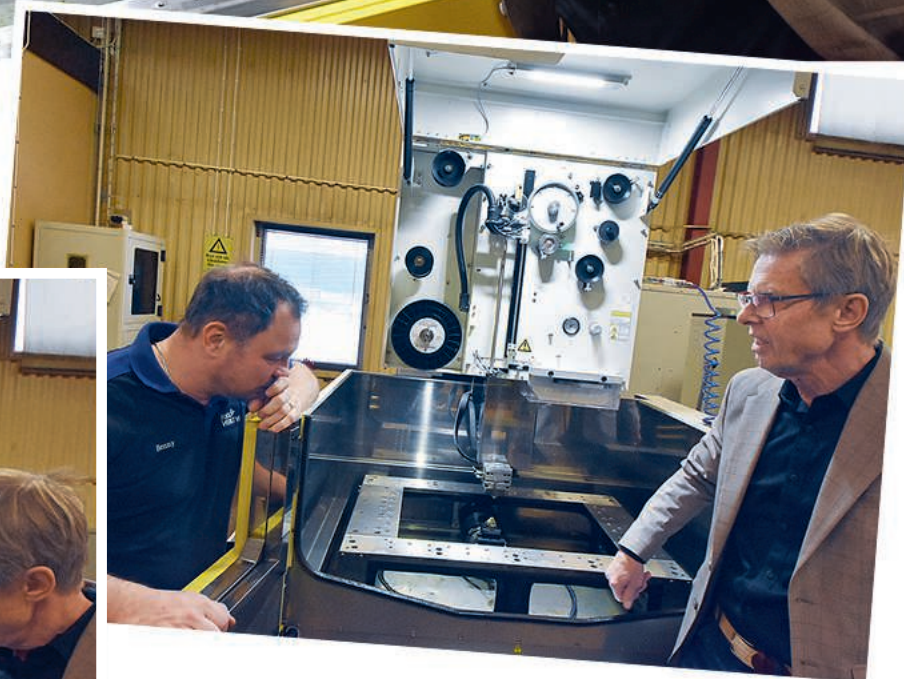
Jan-Anders visar hur god åtkomligheten är i maskinen. Man når lätt hela bordet genom öppningen i tankdörren.
