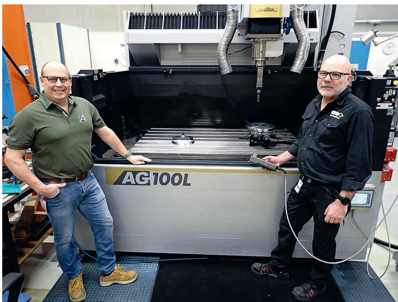
Roger Jansson och Klas Nordh intill sänkgnist SODICK AG100L. I den här maskinen kan man placera ett arbetsstycke på 5000 kg och med maxstorlek på L 2100 x B 1250 x H 650 mm.
