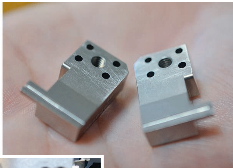
Precisionsdetalj med ett konisk halvt hål med radie 0,5 mm.
