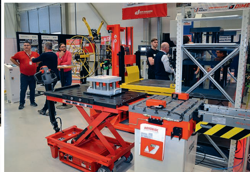
Din Maskin och Dimeco visade upp verktygsvagnen Elektrisk Multimatic och verktygstrucken TPI Liftmatic. Vagnen kan lyfta max 900 kg och trucken runt 2000 kg.
