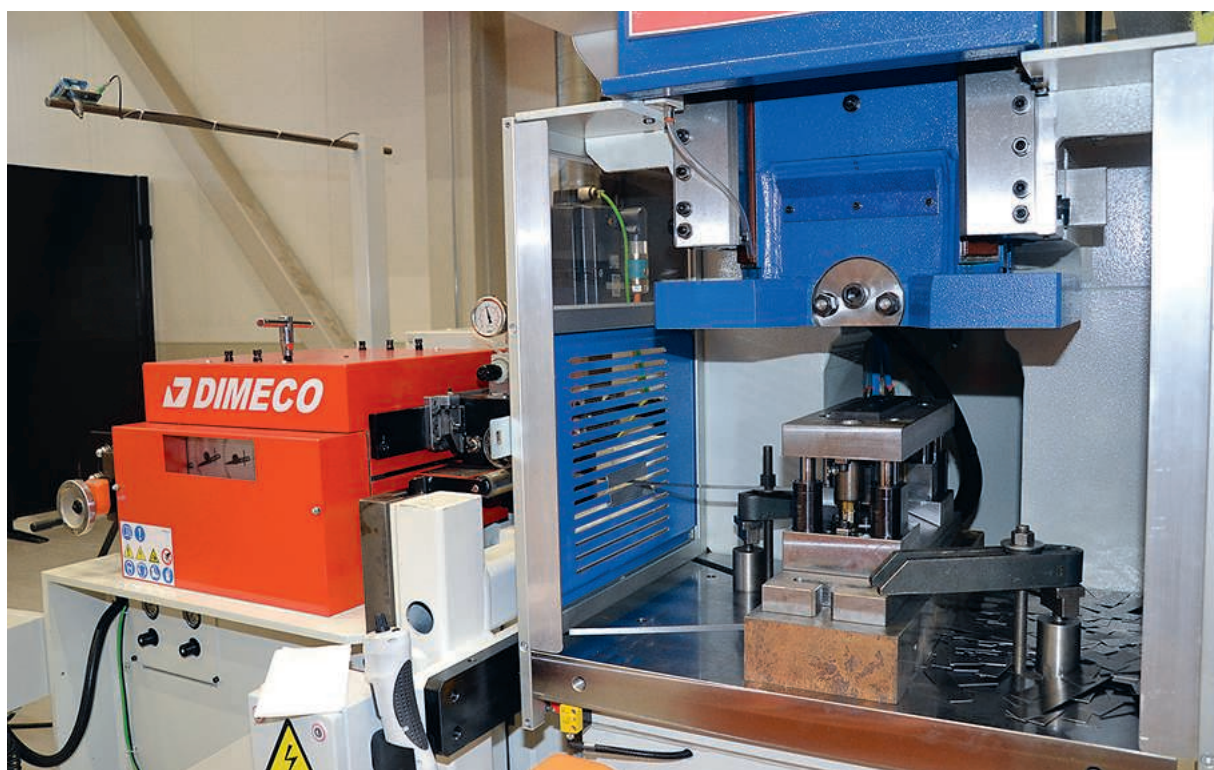
Många ville se den mekaniska pressen Omera C63 med Dimeco riktmatarverk 1675 som kan användas för att stansa material. Matarverket är utrustat med Siemens TP7 kompakt styrning. Skulle materialet slira på grund av olja mellan valsarna finns en funktion i matarverket som justerar och säkerställer att matningen korrigeras.
