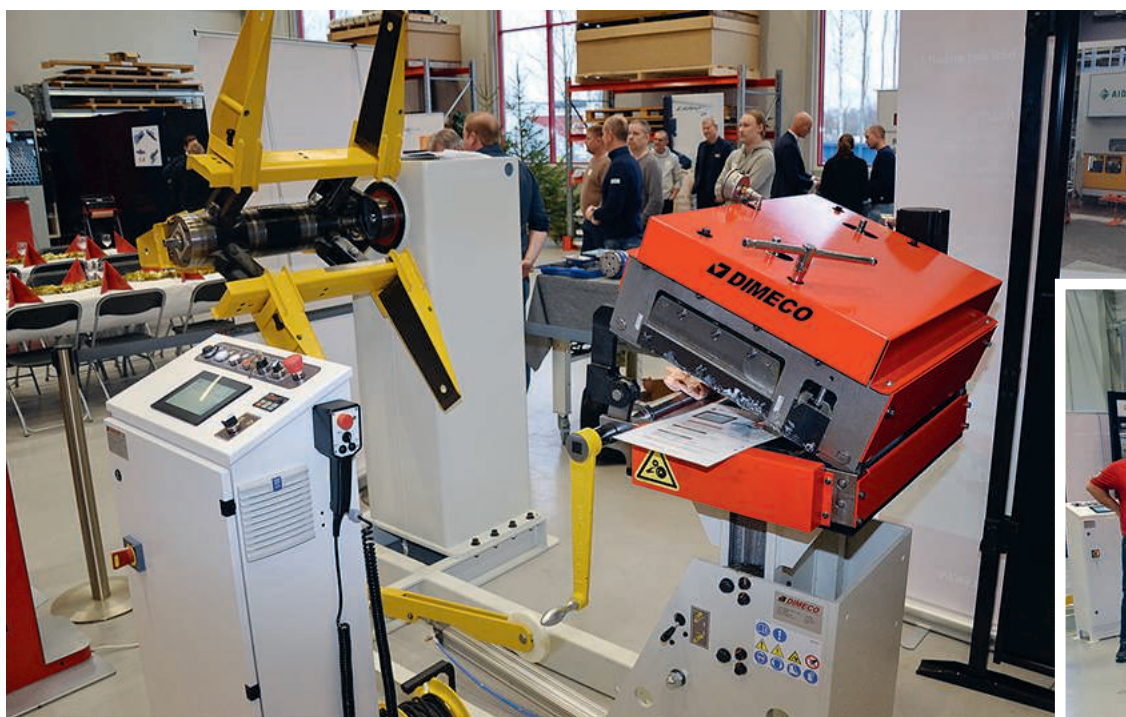
Din Maskin demonstrerade Dimecos nyutvecklade styrsystem RF1 i den mindre och mer kompakta bandmatningslösningen L7155 - 3 i 1 linje, en perfekt lösning för företag som vill uppgradera sin bandmatning men har begränsat utrymme runt befintlig press. Tryckarmen håller coilen spänd innan operatören har fäst den i första valsen.
